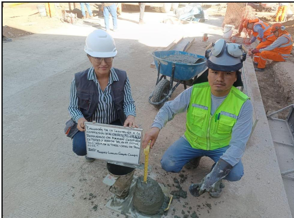
SE OBSERVA EL ENSAYO DE CONO DE ABRAMS PARA DETERMINAR LA CONSISTENCIA DEL HORMIGON FRESCO
