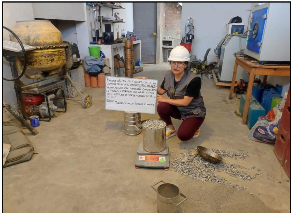
SE OBSERVA EL PESO UNITARIO SECO DEL HORMIGÓN CLASIFICADO CON PIEDRA DE 1/2" Y 3/4"
