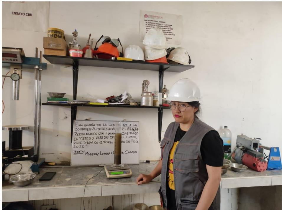
SE OBSERVA EL ENSAYO DE PESO ESPECIFICO Y ABSORCION DEL AGREGADO FINO
