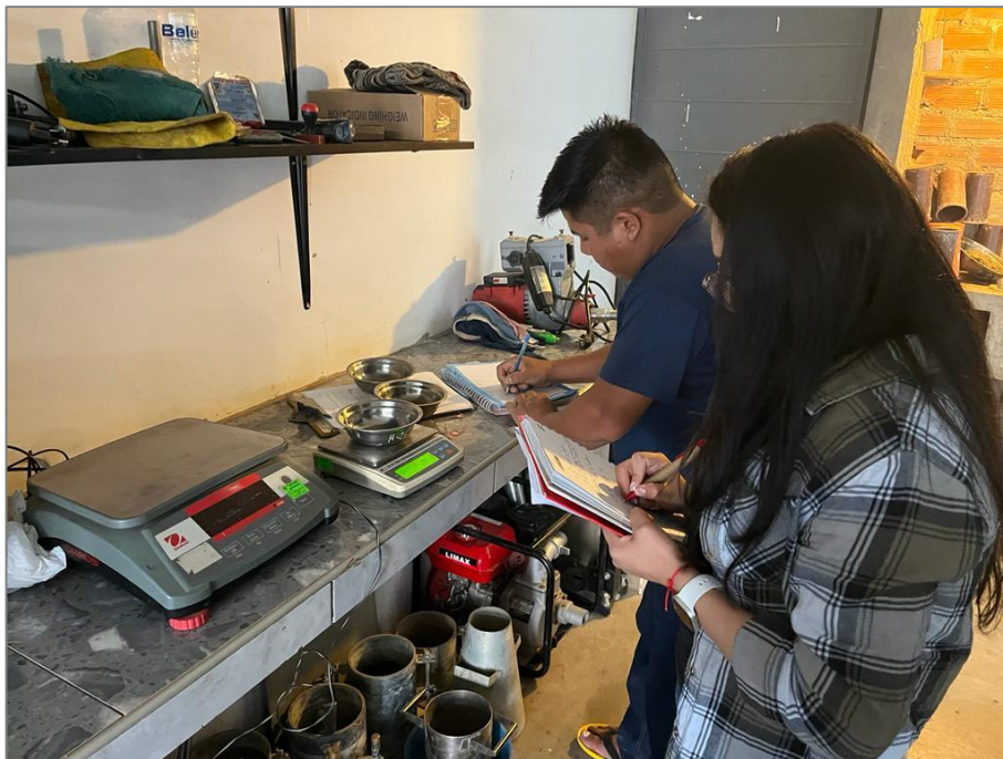
Nota. Pesaje de la muestra lavada y de los envases.
