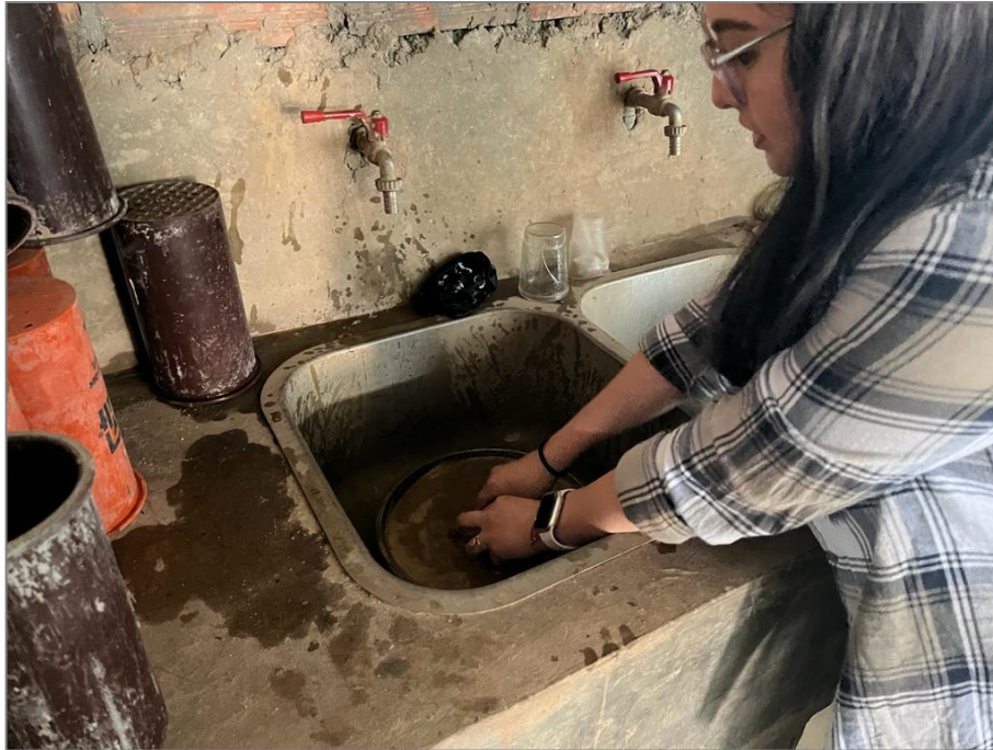
Nota. Lavado de muestra cuarteada utilizando la malla número 200.
