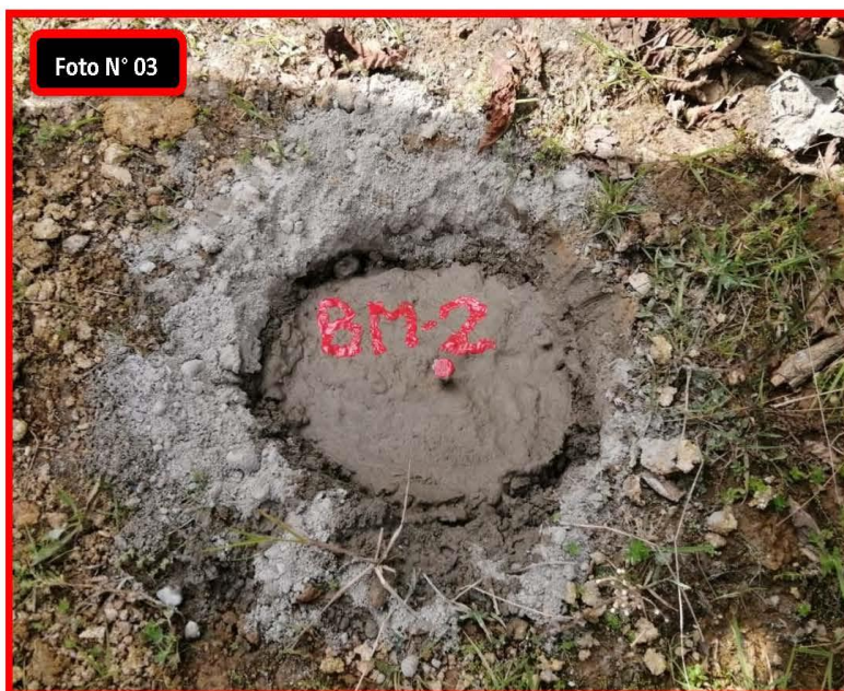
FOTO N° 03: Se observa el BM monumentado, la cual servirá como punto de control del proyecto
