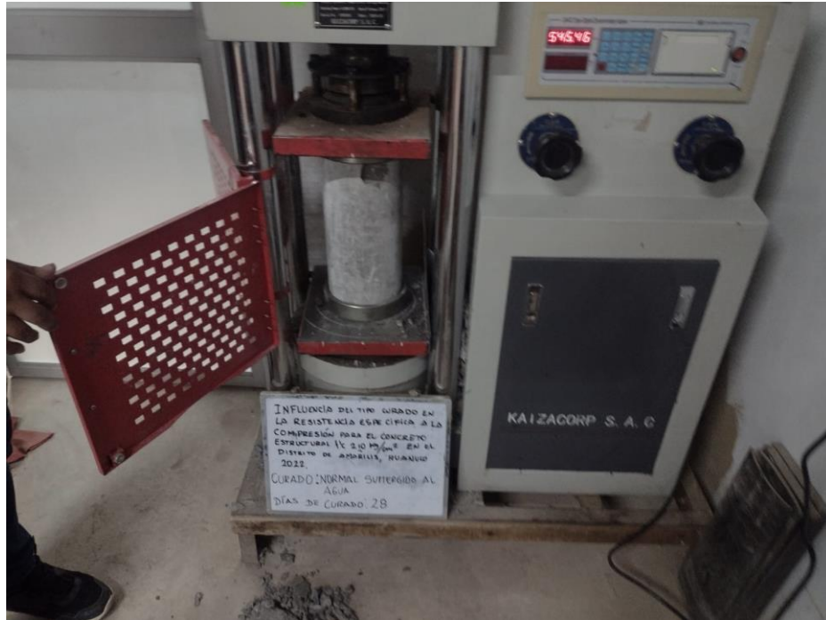
Se observa la fractura de probeta parte superior Tipo 4.
