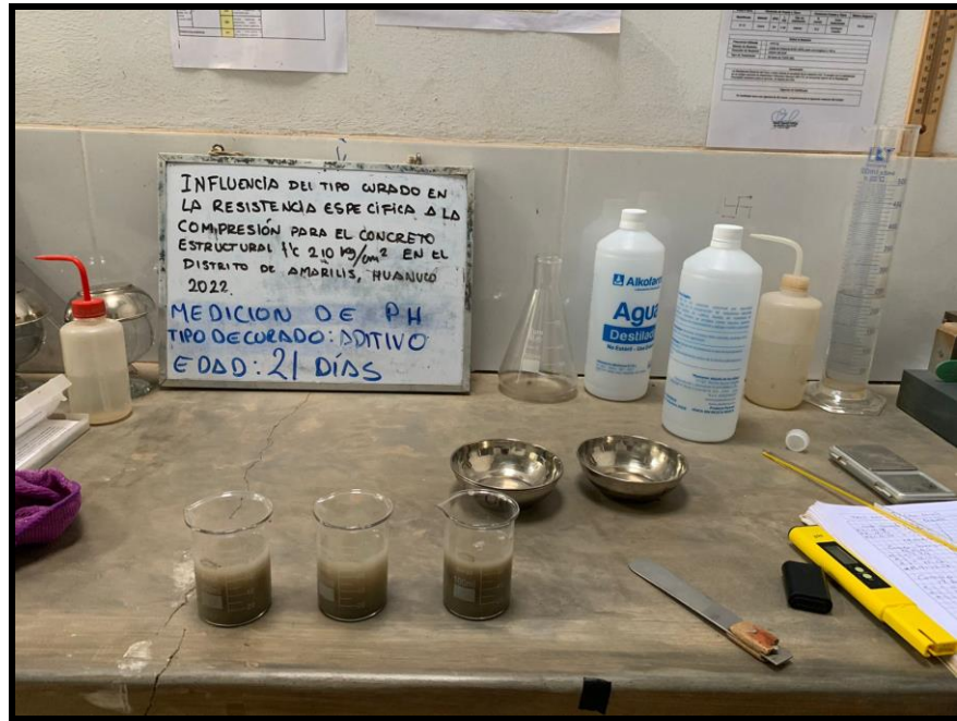
Medicion de ph tipo de curado: sumergido a los 21 dias
