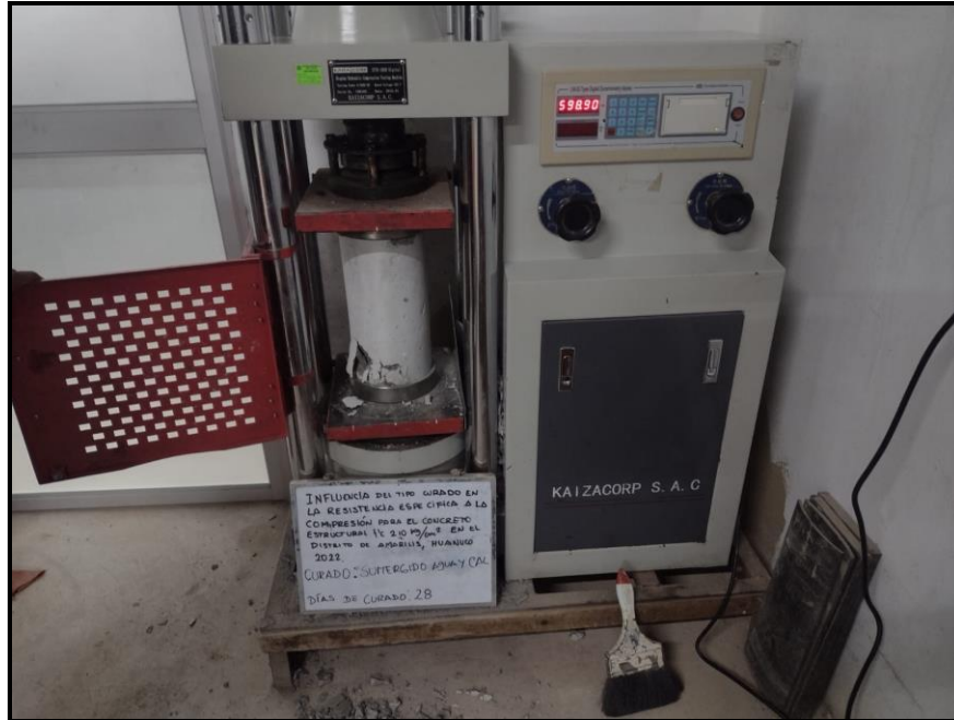
Se observa la fractura de probeta parte inferior Tipo 5.
