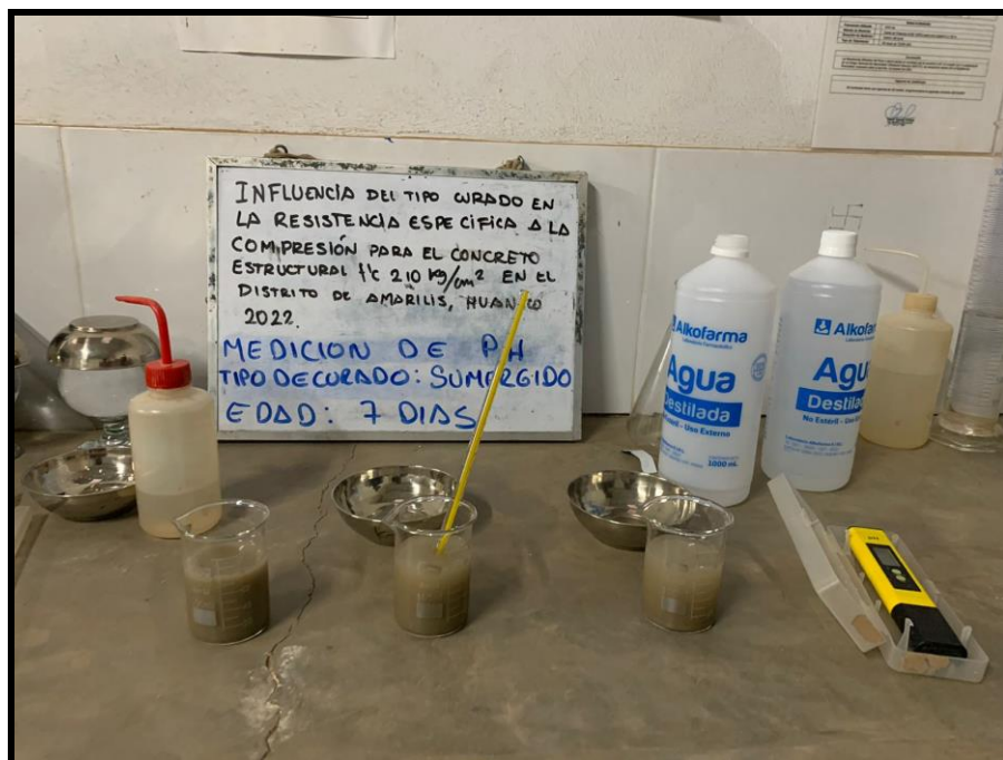
Medicion de ph tipo de curado: sumergido a los 7 dias
