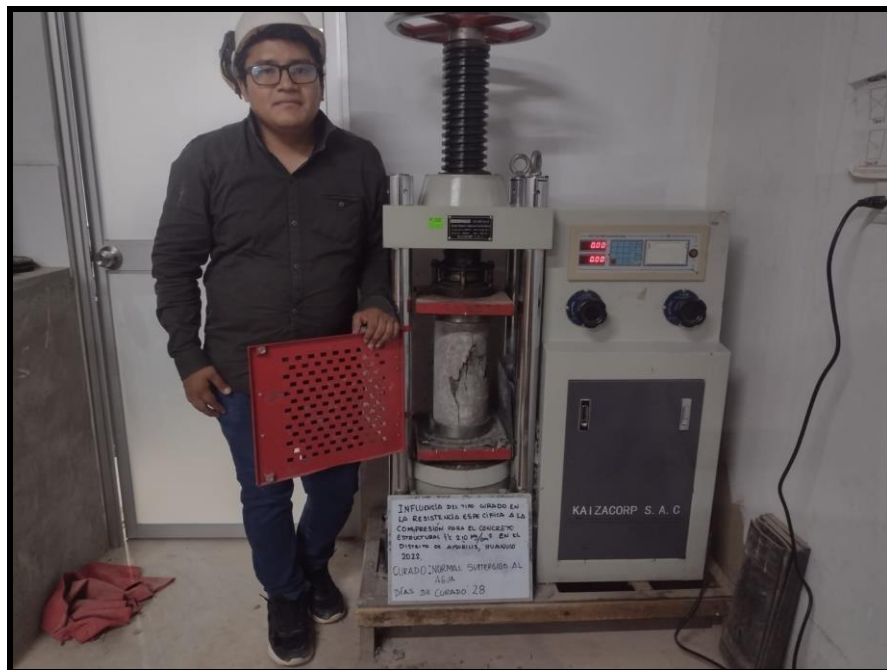
Se observa fisuras verticales de la probeta Tipo 2.
