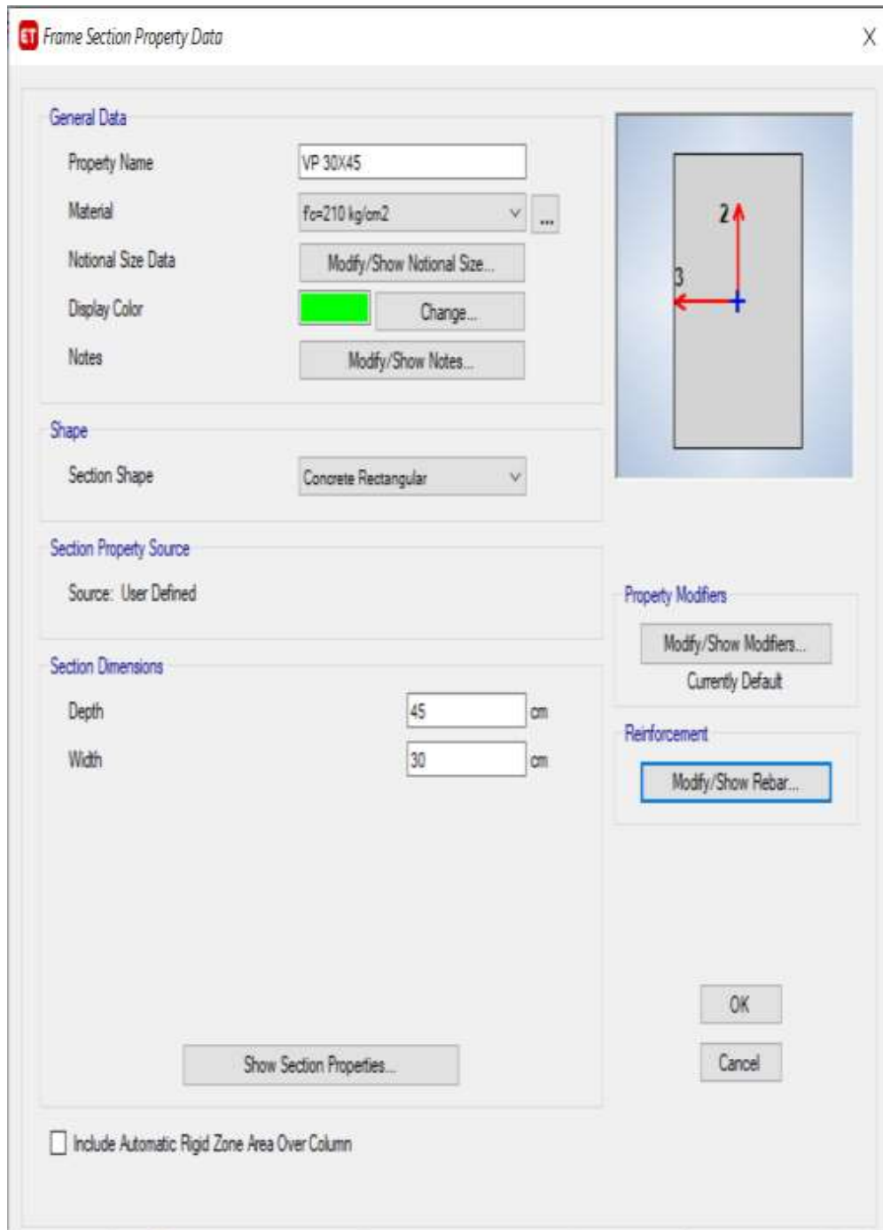
Figura 7 Dimensionamiento de Viga Principal
