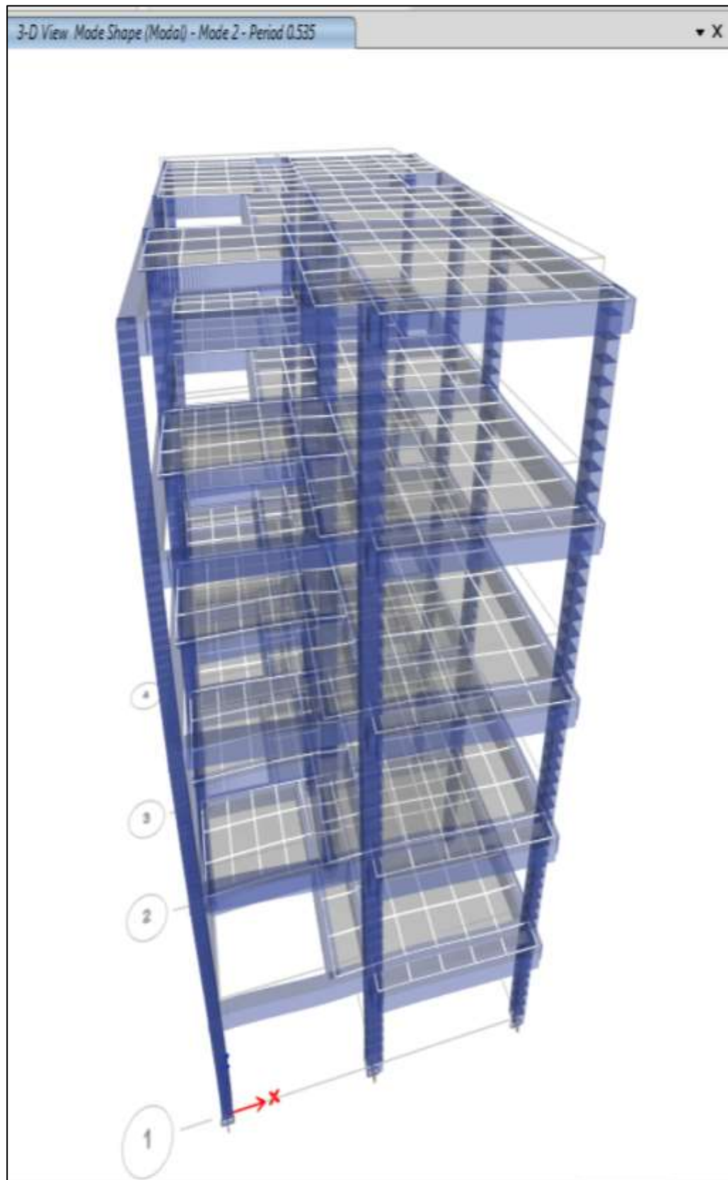
Figura 28 Desplazamiento lateral en Y
