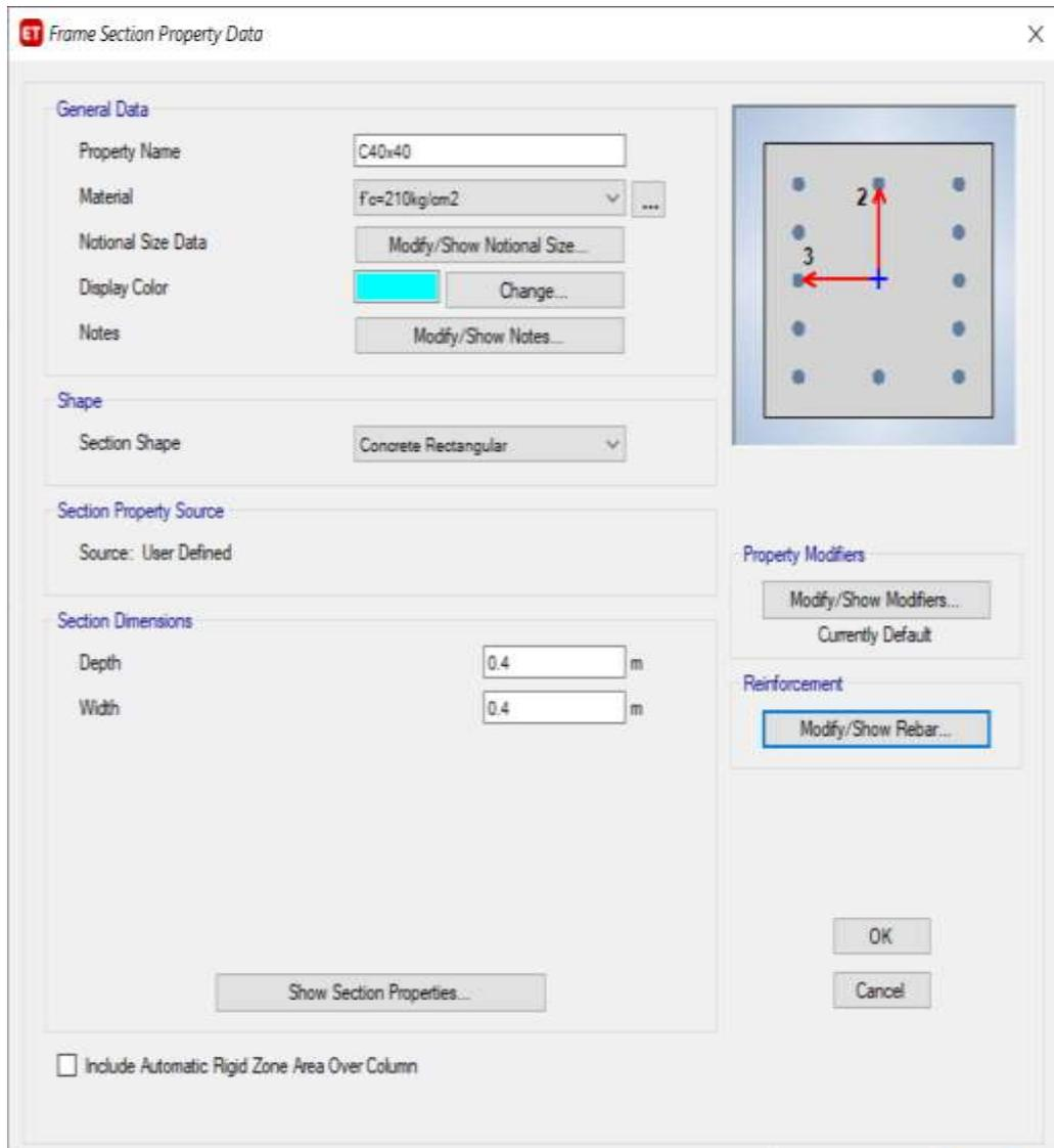
Nota: Se observa las propiedades de la sección de columna central de 40x40 cm<sup>2</sup> en el software Etabs v18.
