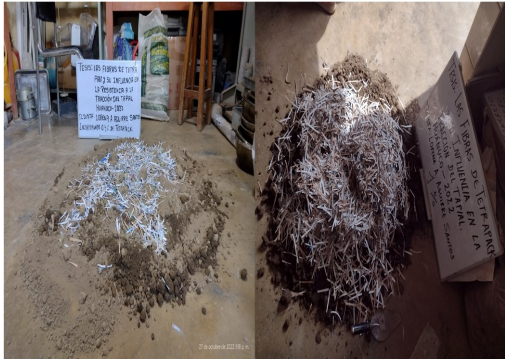
Figura 7 se observa las mezclas de los agregados con fibras de Tetra Pack para los respectivos porcentajes
