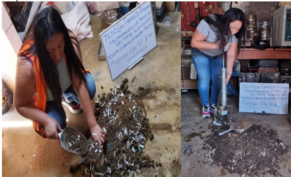
Figura 8 se observa las mezclas de los agregados con fibras de Tetra Pack con su respectivo porcentaje siendo añadidos a los cilindros para que se compactado con el martillo compactador
