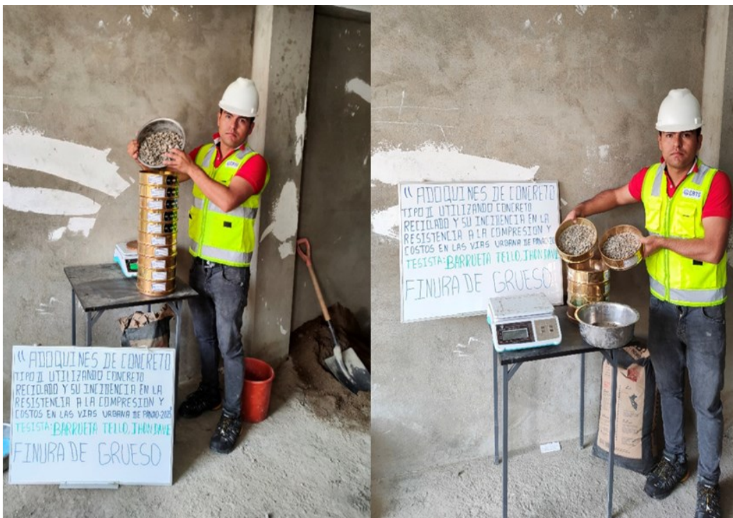
Fotografía 6 Granulometría del agregado grueso
