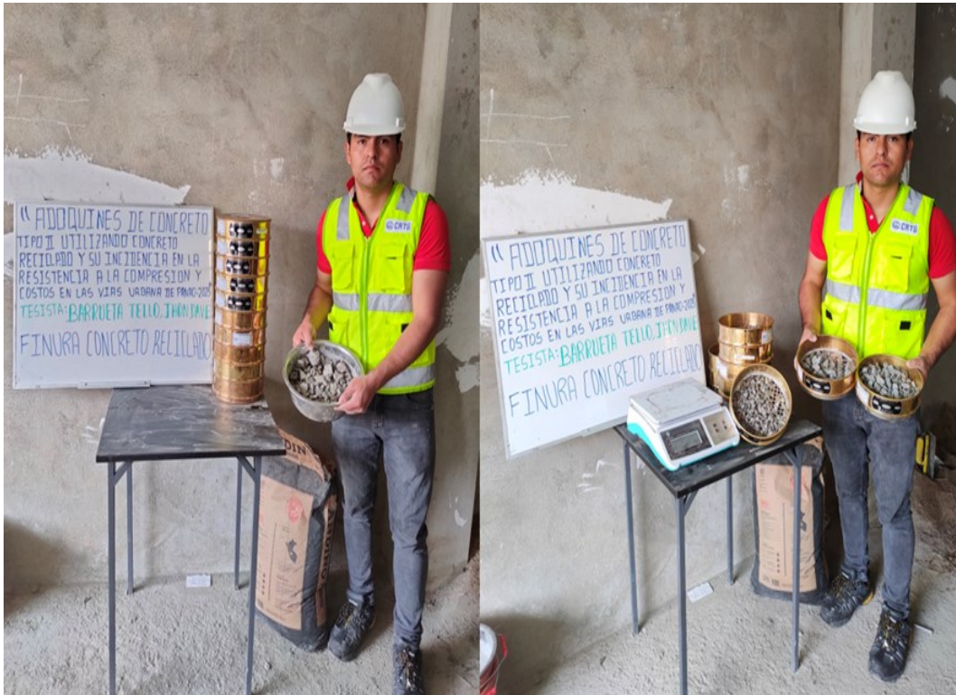
Fotografía 2 Granulometría del concreto reciclado.
