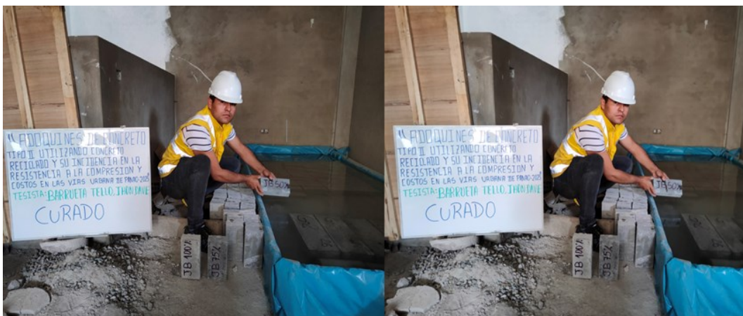
Fotografía 17 Curado de los adoquines tipo II con adición de 50% de concreto reciclado
