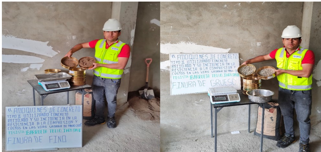
Figura 6 Granulometría del agregado fino y agregado grueso
