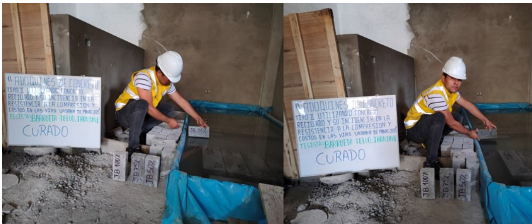
Fotografía 17 Curado de los adoquines tipo II con adición de 50% de concreto reciclado
