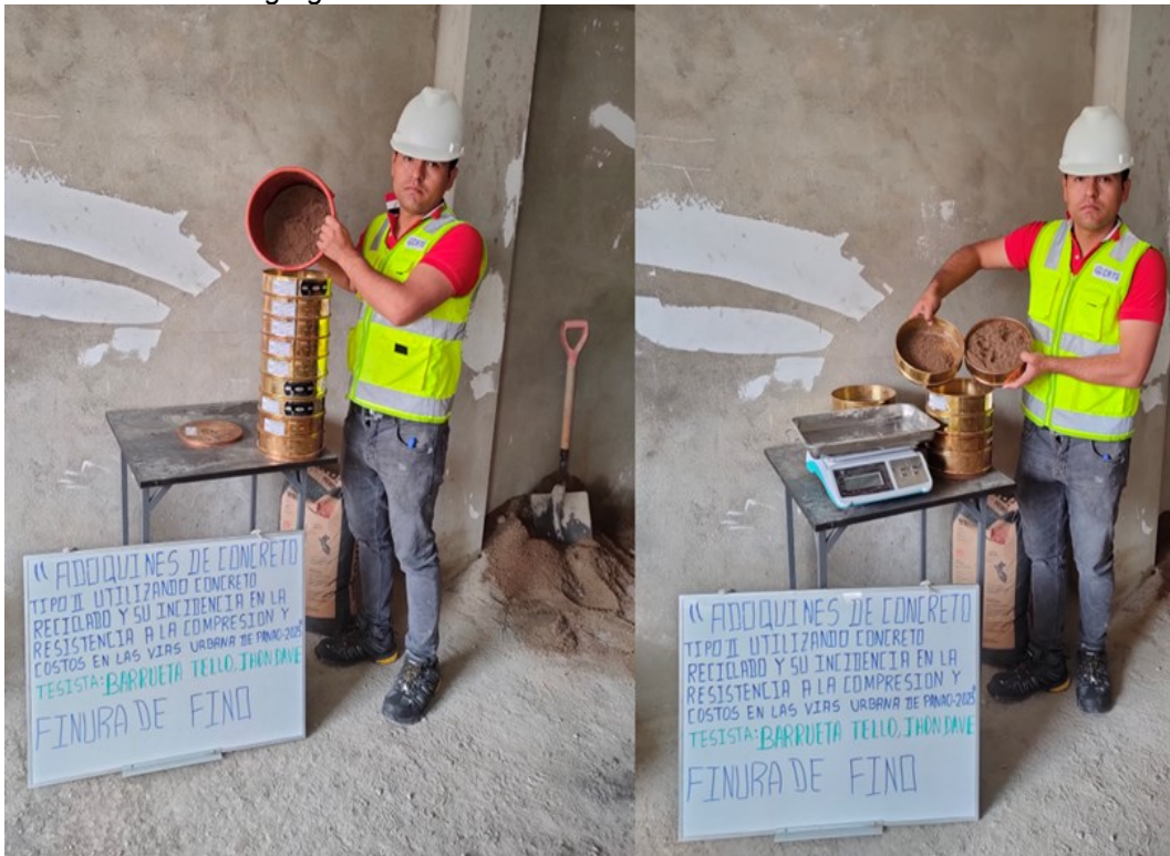
Fotografía 5 Granulometría del agregado fino
