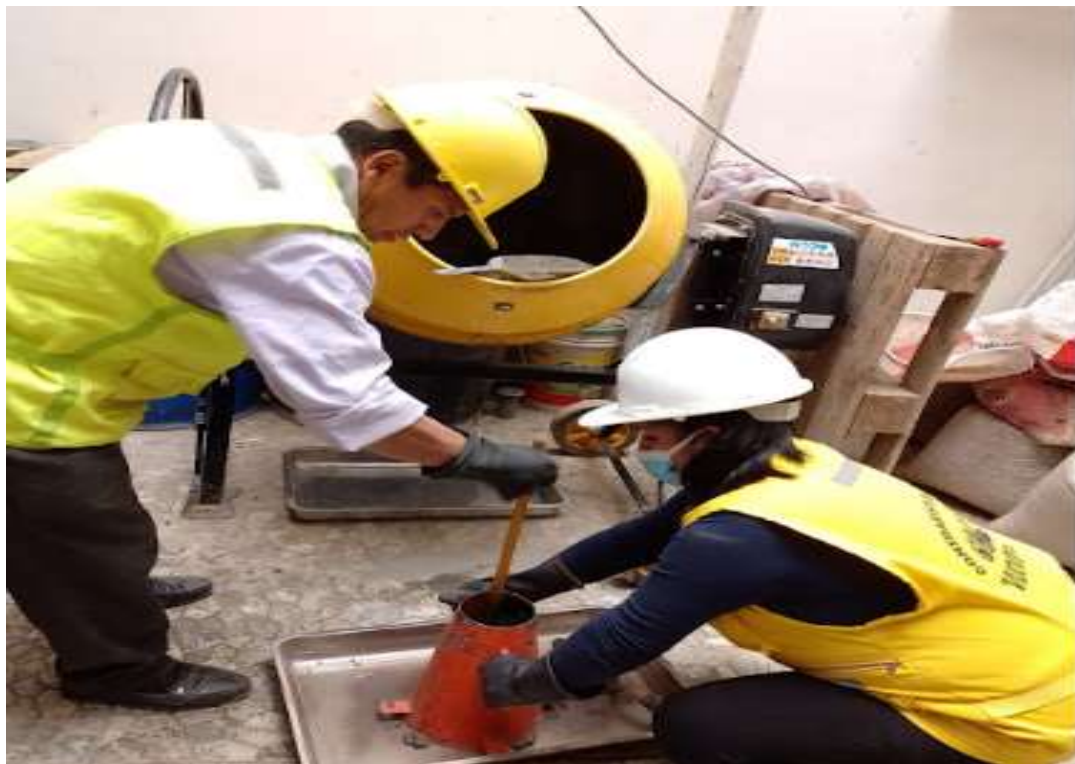
Ensayo del asentamiento del concreto, que consiste en compactar una muestra de concreto fresco en un molde cónico. varillado
