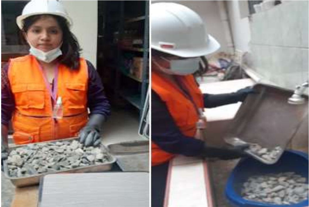
Limpieza y lavado de los agregados para separar y eliminar las partículas más finas.
