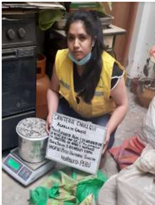
Ensayo peso unitario suelto del agregado grueso de la cantera Acochacan y la cantera Chullqui.
