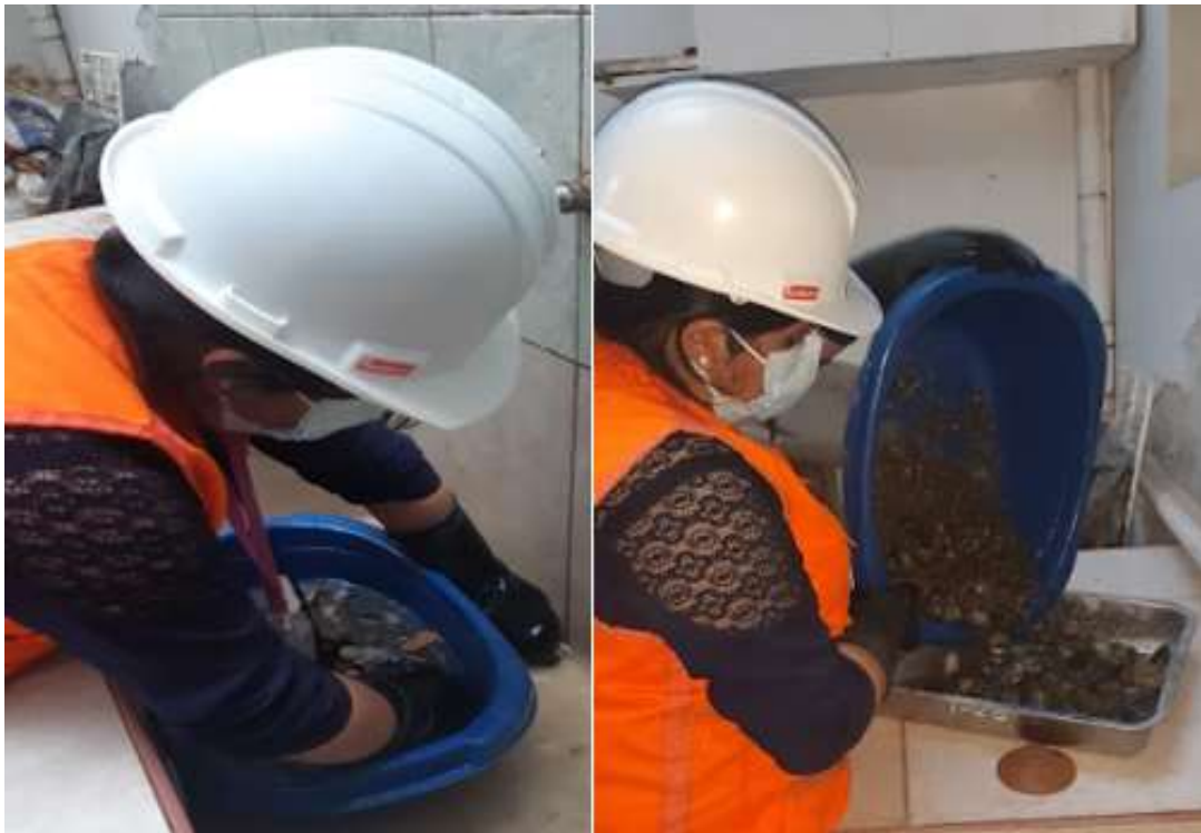
Limpieza y lavado de los agregados para separar y eliminar las partículas más finas.
