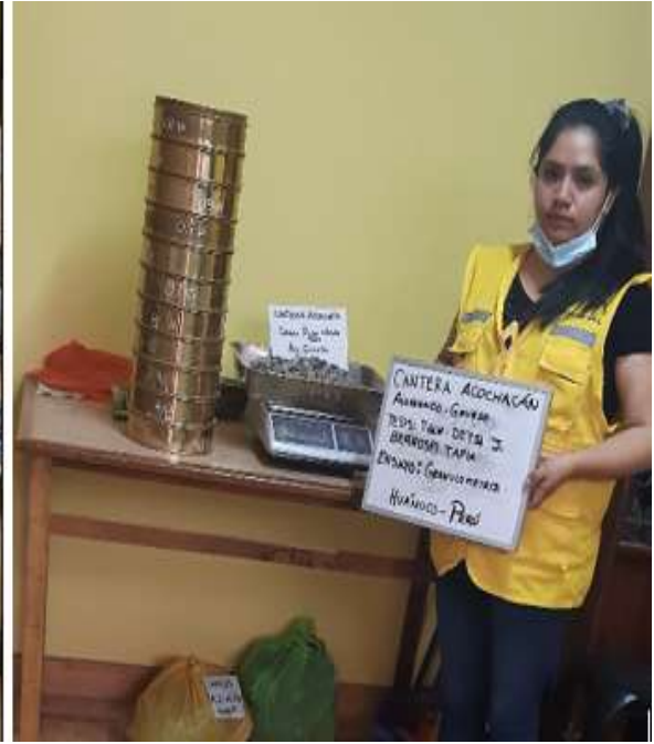
Proceso de granulometría del peso seco lavado del agregado grueso de la cantera Cochachinche
