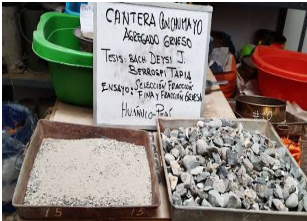
Selección para la fracción fina y fracción grueso cantera Conchumayo.
