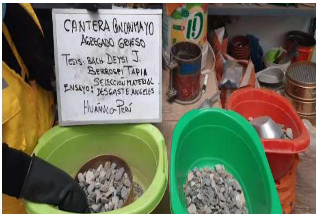
Selección del material y el desgaste del agregado grueso de la cantera Conchumayo.
