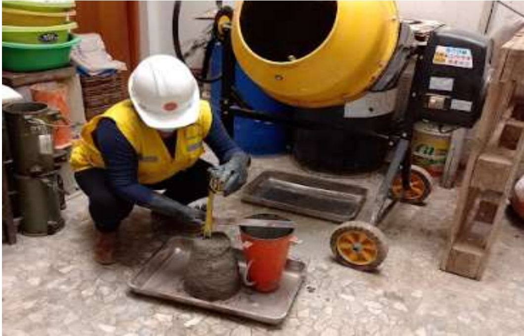
Elaboración de las probetas de concreto, con los agregados seleccionados para su ensayo resistencia a la compresión.
