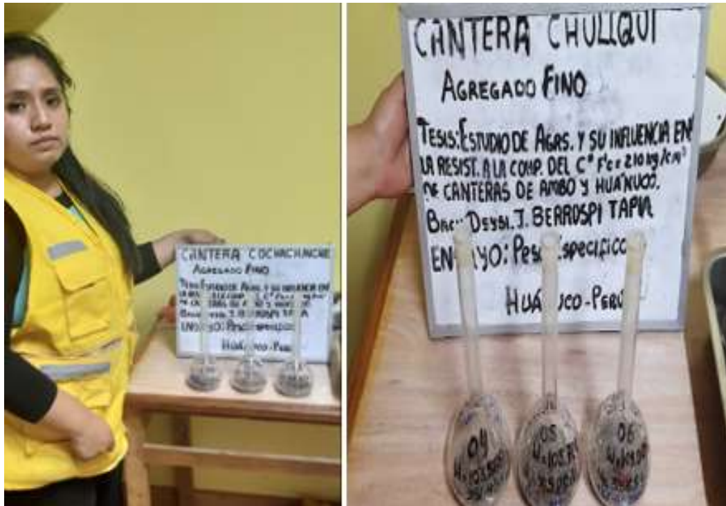
Ensayo del peso específico del agregado fino de la cantera de Pitumama y Conchumayo.
