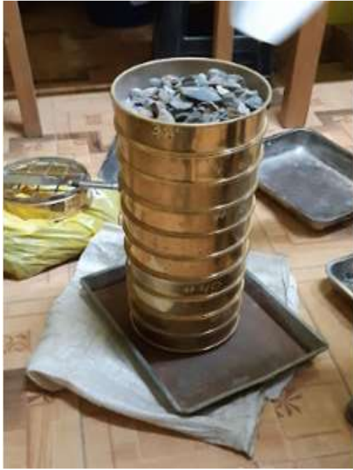
Proceso de granulometría del peso seco lavado del agregado grueso de la cantera Cochachinche
