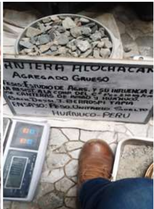
Ensayo peso unitario suelto del agregado grueso de la cantera Acochacan y la cantera Chullqui.
