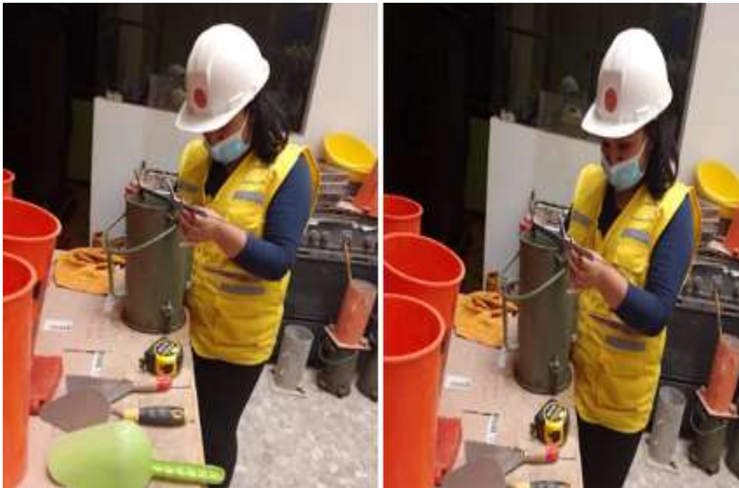
Elaboración de las probetas de concreto, con los agregados seleccionados para su ensayo resistencia a la compresión.
