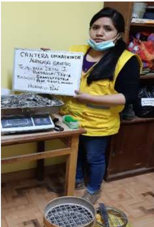
Granulometría del agregado grueso para determinar el tamaño del material de la cantera Conchumayo
