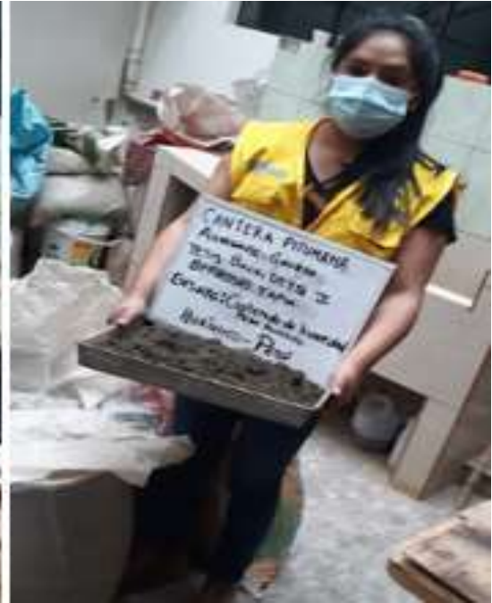
Ensayo peso unitario suelto del agregado grueso de la cantera Acochacan y la cantera Chullqui.
