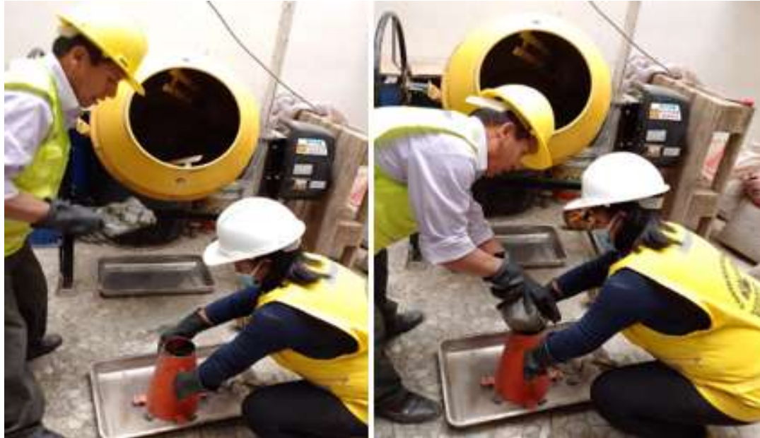
Ensayo del asentamiento del concreto, que consiste en compactar una muestra de concreto fresco en un molde cónico. varillado
