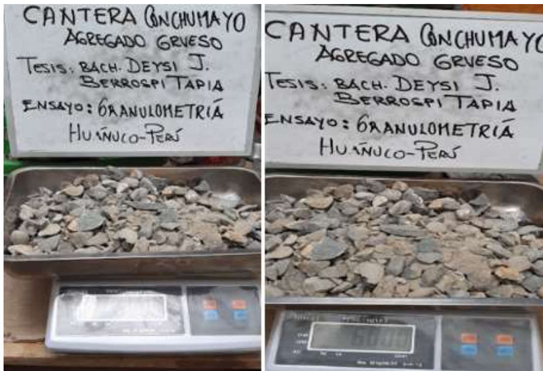
Selección del material y el desgaste del agregado grueso de la cantera Conchumayo.
