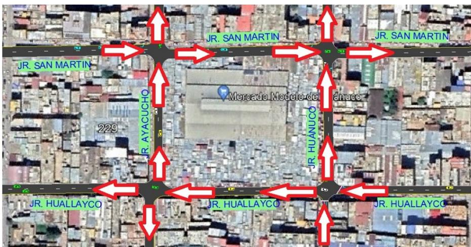
Nota: El cambio de direccionamiento o sentido optimiza la salida y/o evacuación del tráfico vial de la intersección más crítica, el cual se encuentra entre el Jr. Huallayco y el Jr. Ayacucho.
