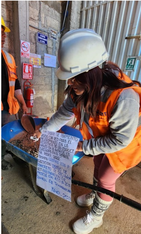
Fotografía 20 Preparación de la mezcla con RCD al 20% (medición de temperatura)
