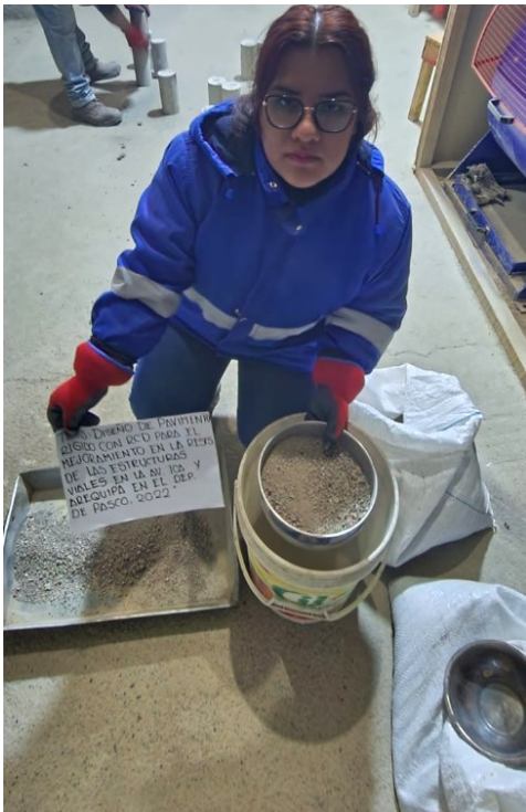
Tamizado de Residuos de construcción y demolición (RCD)
