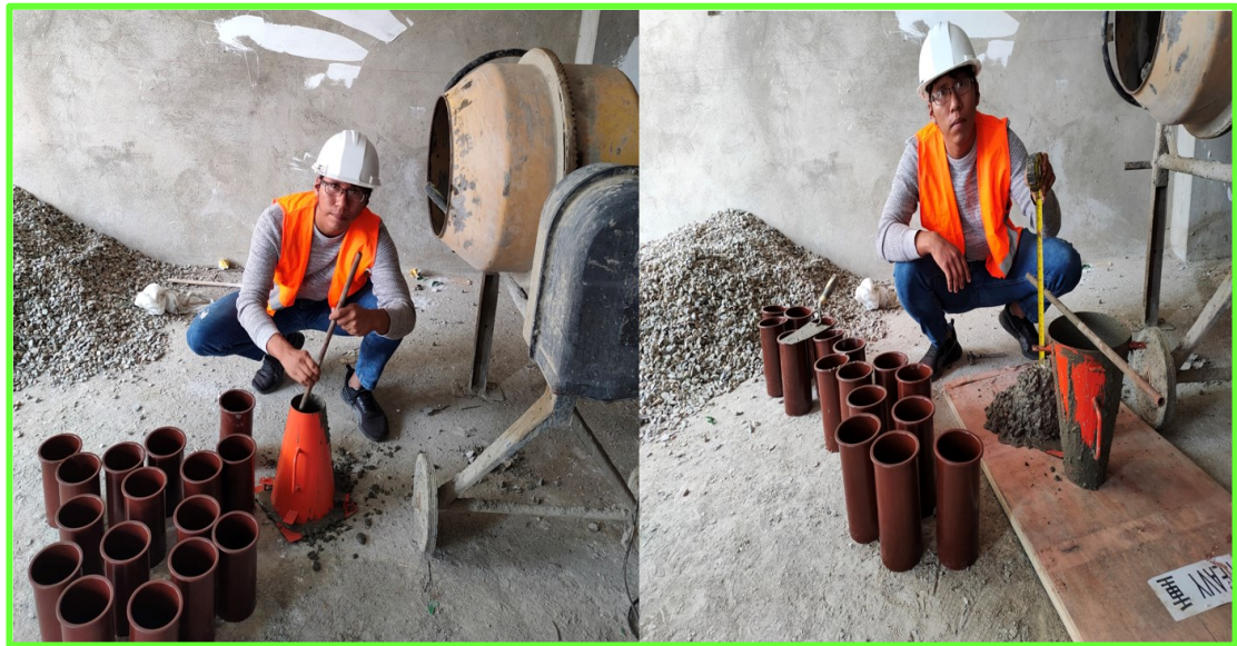
Figura 30 Ensayo de asentamiento
