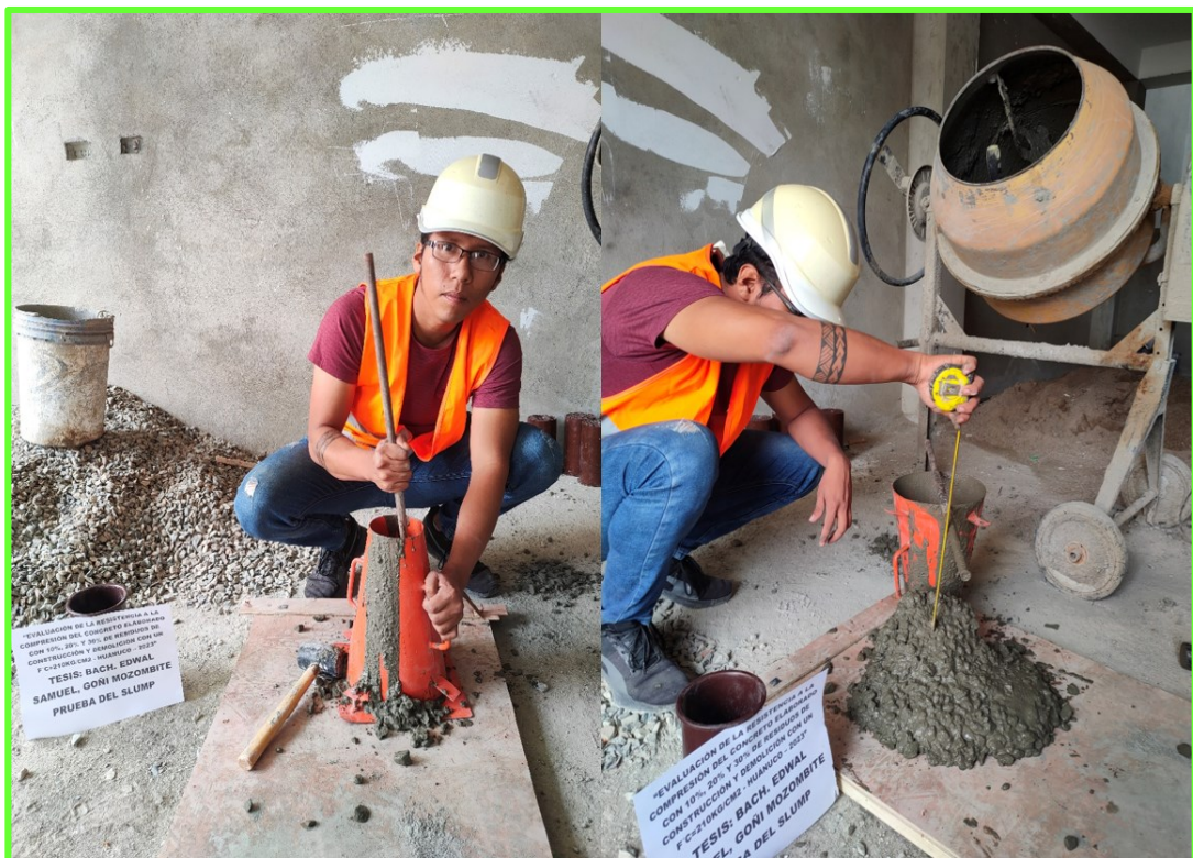
Figura 31 Ensayo de asentamiento para el concreto con residuos de construcción y demolición
