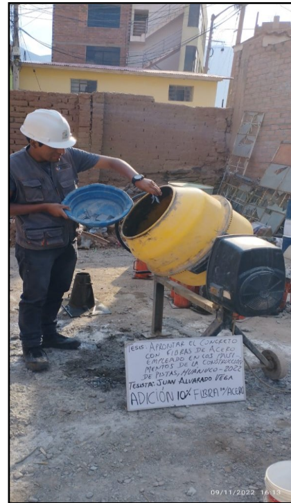
ADHESIÓN DE ESPECIMENES DE ACERO EN LA FABRICACIÓN DE CONCRETO SEGUN DISEÑO.
