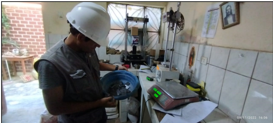
PESADO DE MATERIALES DE ADHESIÓN QUE SERÁ USADO EN LA FABRICACION DE CONCRETO SEGUN DISEÑO
