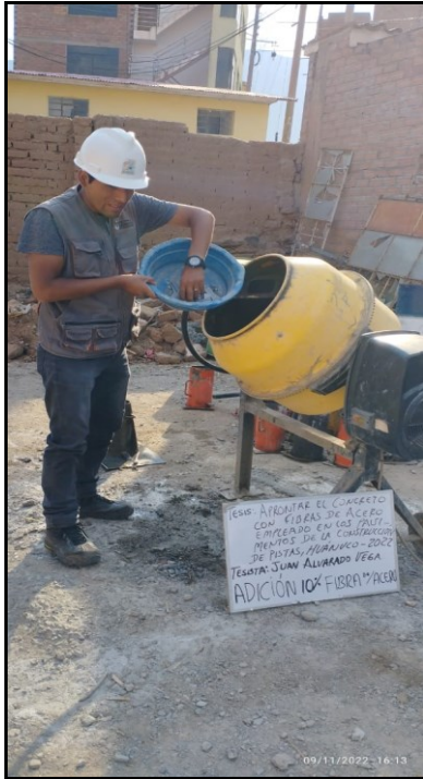
ADHESIÓN DE ESPECIMENES DE ACERO EN LA FABRICACIÓN DE CONCRETO SEGUN DISEÑO.
