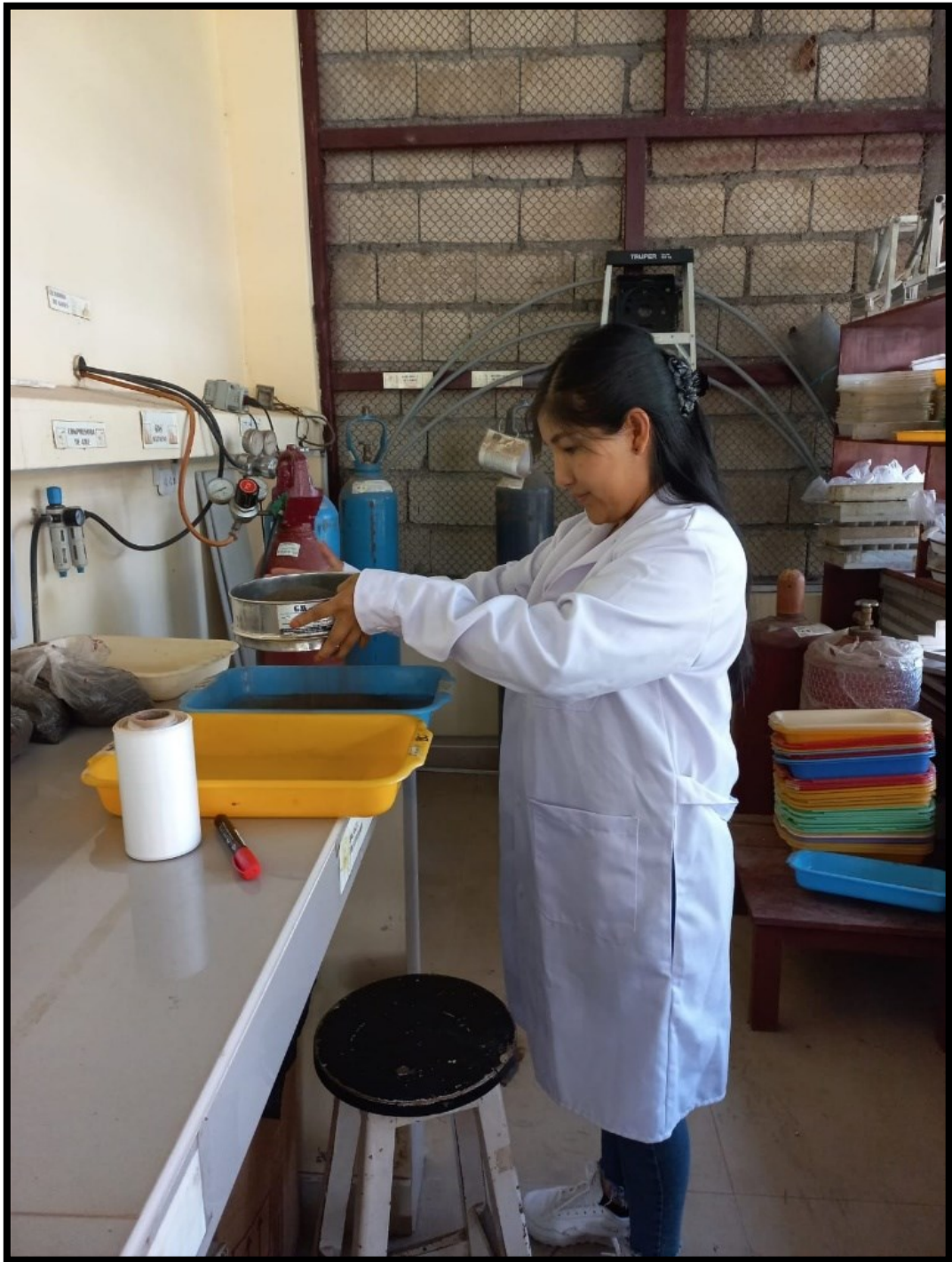
Figura 9 Cerniendo la tierra para realizar el análisis de concentración de plomo
