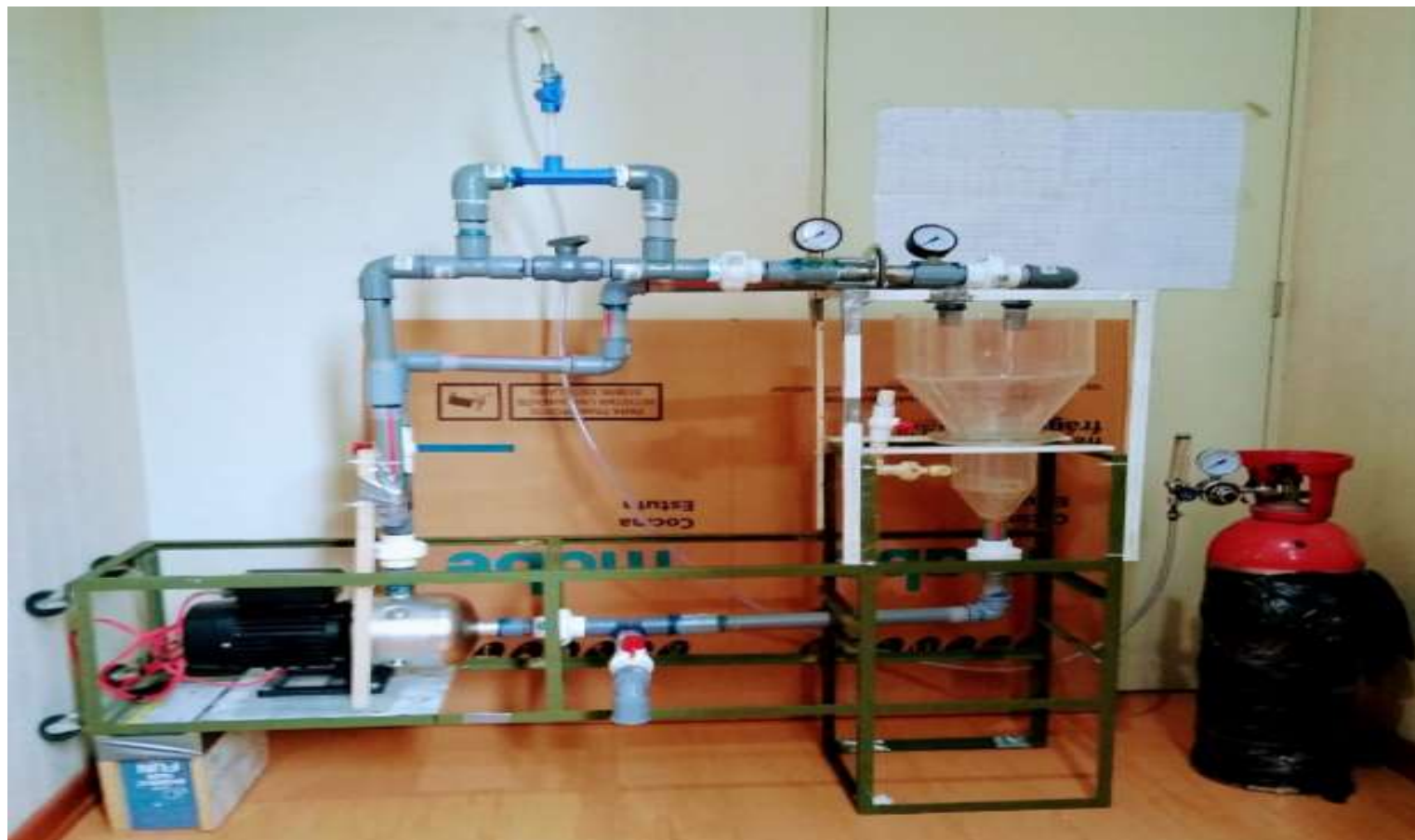
Fotografía de la vista panorámica del módulo construido para ablandar el agua subterránea del distrito de Luyand
