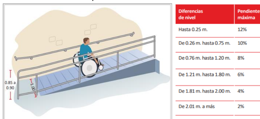
Figura 65 Características de la rampa
