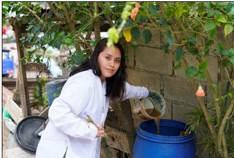
Figura 14 Agregando la melaza preparada al biodigestor
