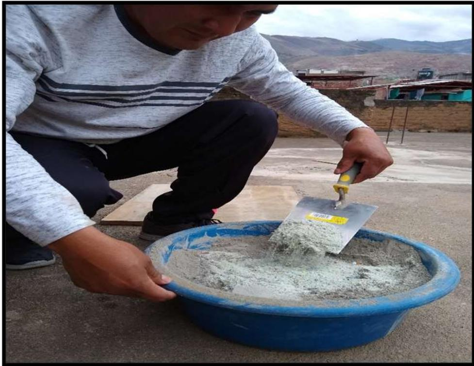
Encofrado de la mezcla con plástico finamente triturado
