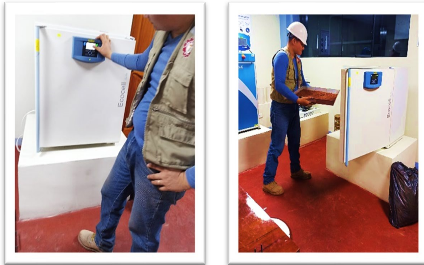
Figura 6 Secado en el horno de la muestra
