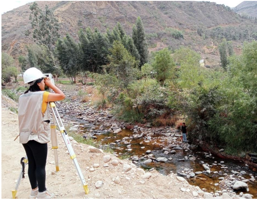
Fotografía 5: Levantamiento topográfico del cauce del río
