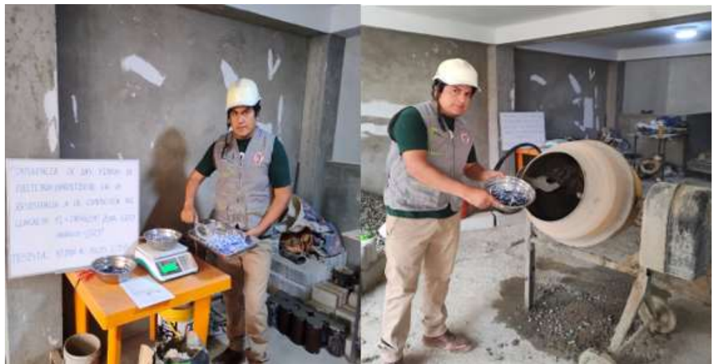
Figura 10 Pesaje y diseño de mezcla de concreto con adición de con adición de politetrafluoroetileno en un (0,8, 1 y 1,2) %
