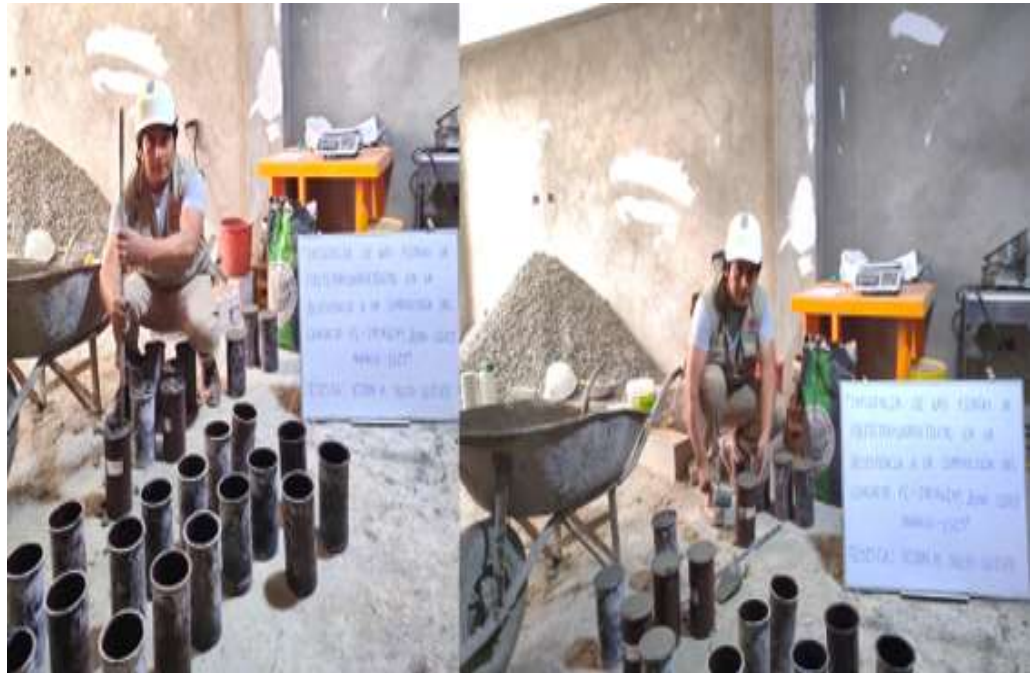
Figura 10 Pesaje y diseño de mezcla de concreto con adición de con adición de politetrafluoroetileno en un (0,8, 1 y 1,2) %
