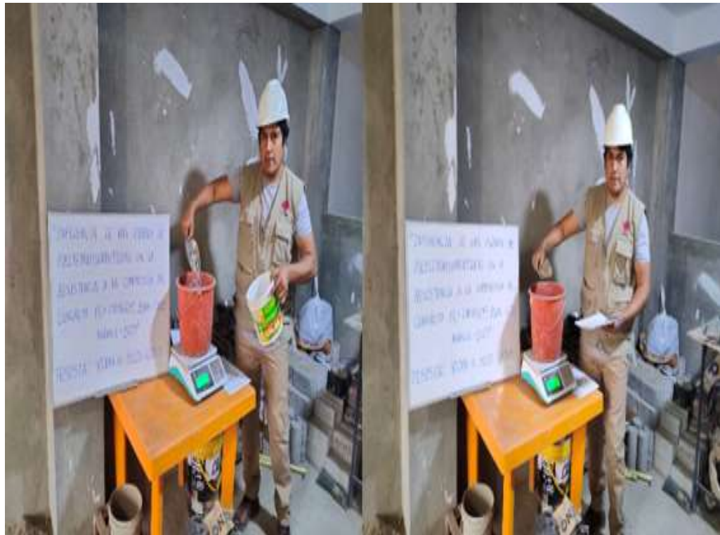
Figura 6 Pesaje del cemento y el agua para el diseño de mezcla de los testigos de concreto con adición de politetrafluoroetileno
