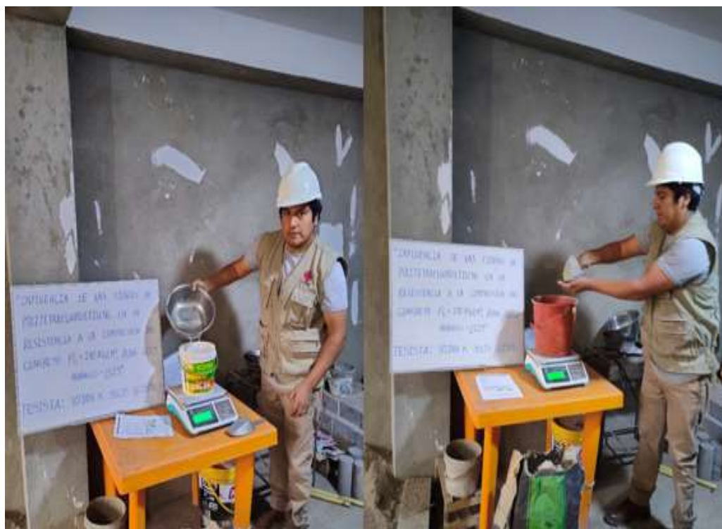
Figura 6 Pesaje del cemento y el agua para el diseño de mezcla de los testigos de concreto con adición de politetrafluoroetileno
