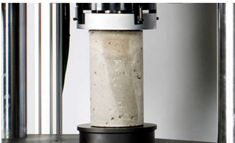
Figura 3 Ensayo de compresión del concreto
