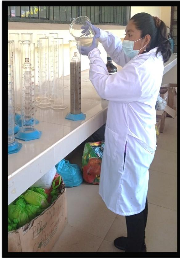
Determinación de los análisis físicos del suelo – método de la probeta
