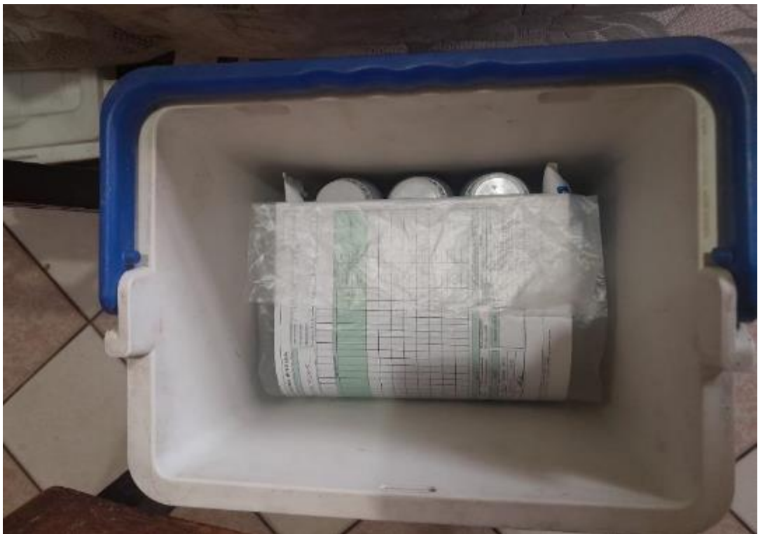
Figura 33 Almacenamiento y traslado de las muestras del agua post tratamiento para su análisis al laboratorio ALAB (Lima)
