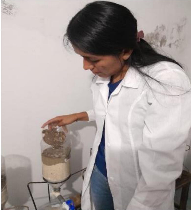
Figura 28 Colocando los otros estratos a base de arena gruesa, arena fina y piedras
