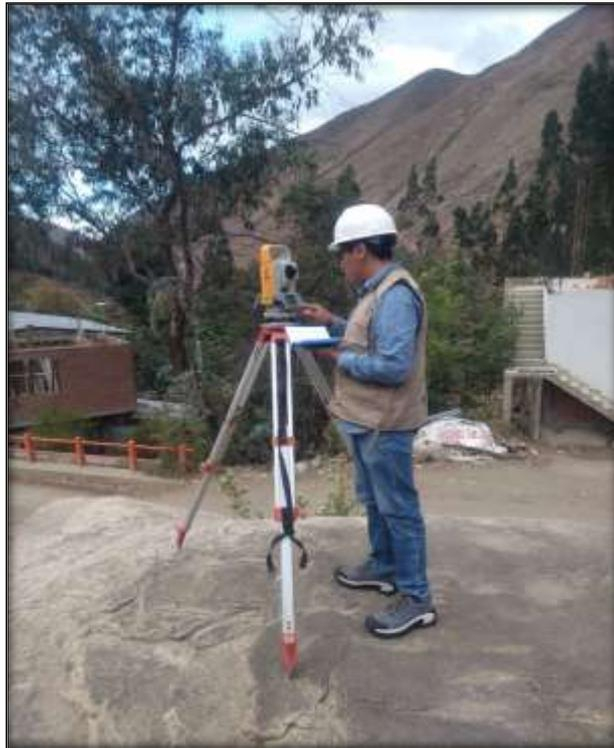
Usamos la estación total 2LS CYGNUS (TOPCON), que sirve para la ejecución del levantamiento terminado.
