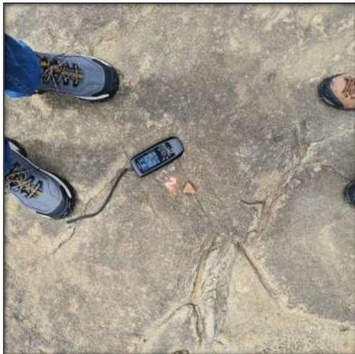
Marcando coordenadas del GPS en uno de los puntos E-2 para referenciar en la estación total.
