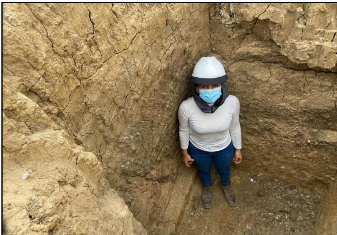
Calicata 03, Obteniendo la estratigrafía 0.75m de arena arcillosa (SC) y hasta los 3m de profundidad se encontró Grava Limosa con arena (GM).
