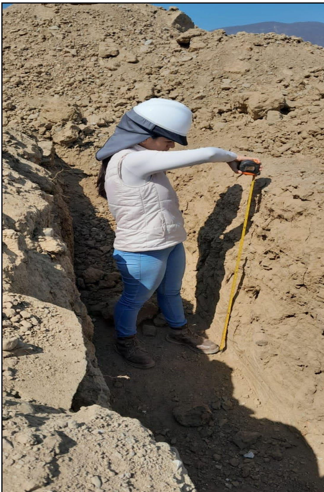
Calicata 02, Obteniendo la estratigrafía 1.05m de arena arcillosa (SC) y hasta los 3m de profundidad se encontró Grava pobremente graduada con Limo y arena (GP-GM).
