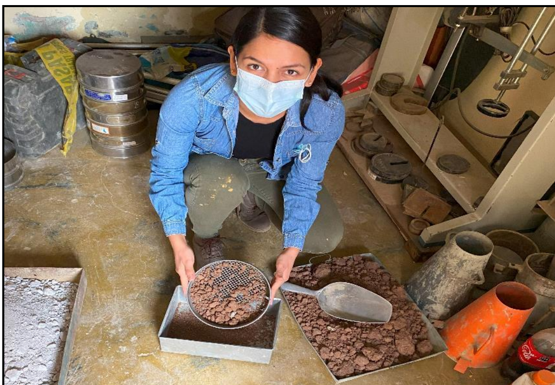
Material retenido en la malla N°04
