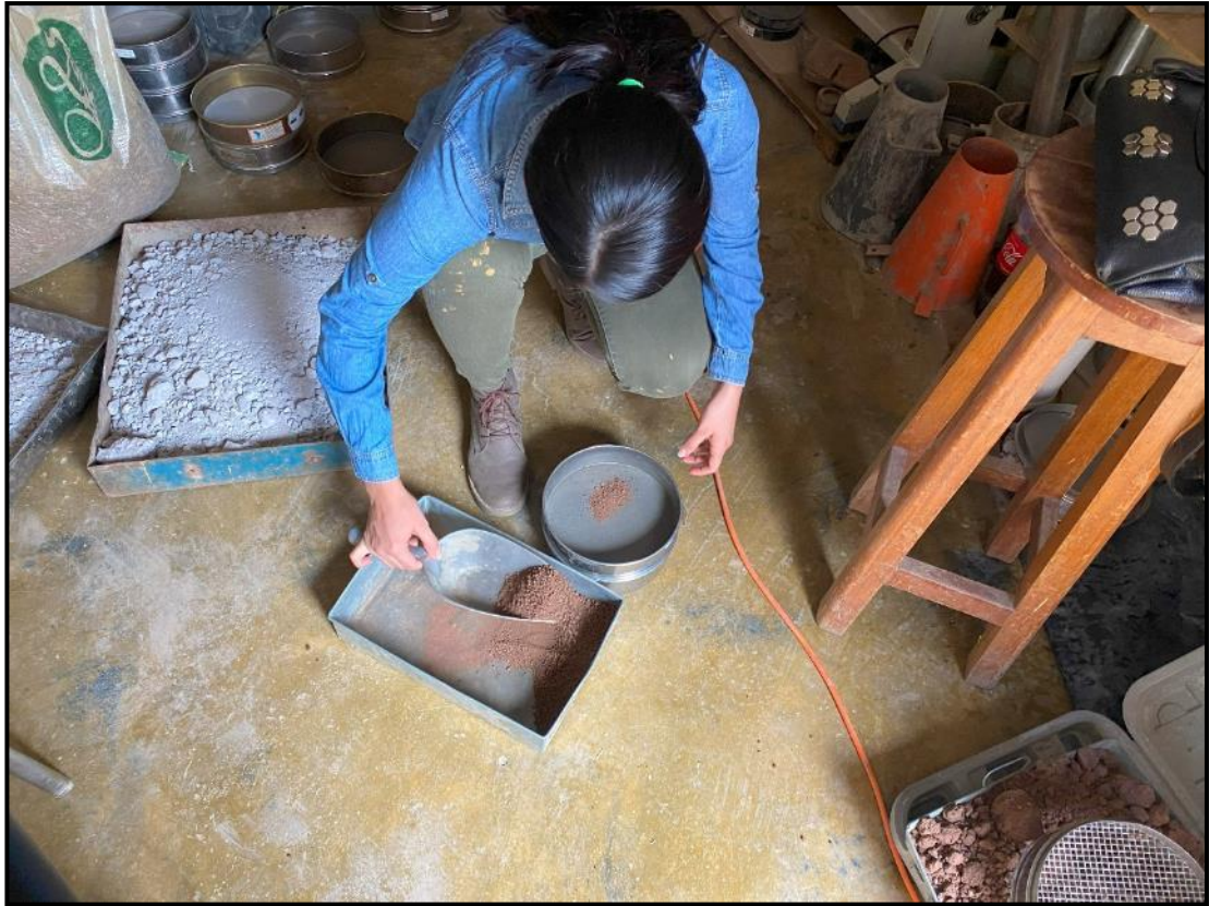
Aplicación de material fino sobre la malla N°200, obteniendo partículas muy finas.
