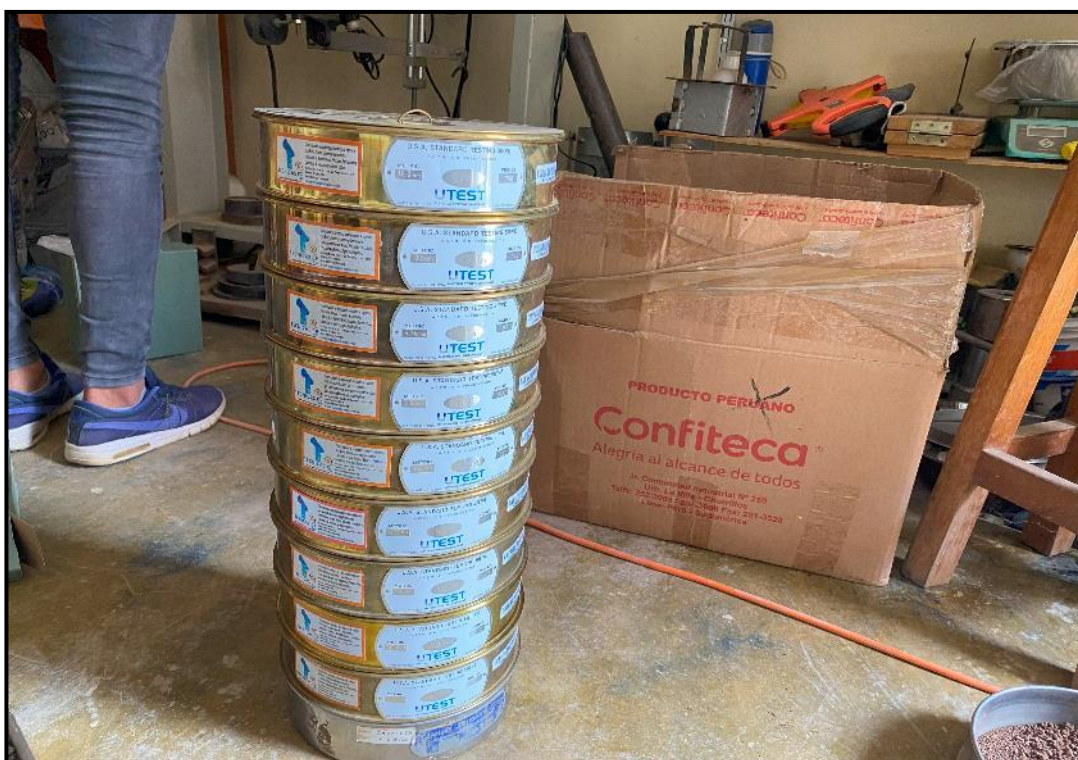
Se observa el juego de tamiz colocados en condición de degradación del tamaño más grueso hasta la malla más fina tamiz N°200.
