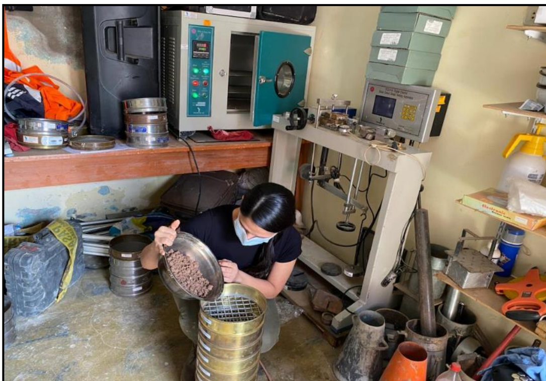
Vertido del material para el análisis granulométrico mediante el tamizado de las muestras para la clasificación de suelo.
