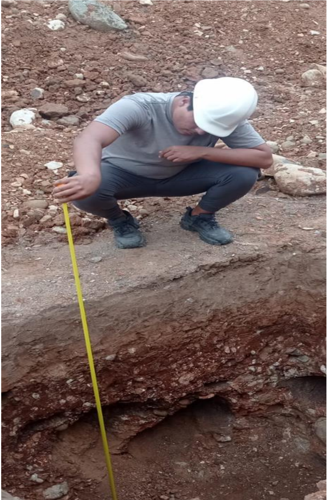
MEDICION DE LA CALICATA CON UNA ALTURA DE 2M
