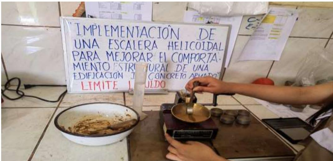
Nota: En la figura 86 se registró el número de golpes necesarios para que la muestra adquiriera la consistencia suficiente para comenzar a fluir. Finalmente, el límite líquido se calculó con base en el número de golpes.
