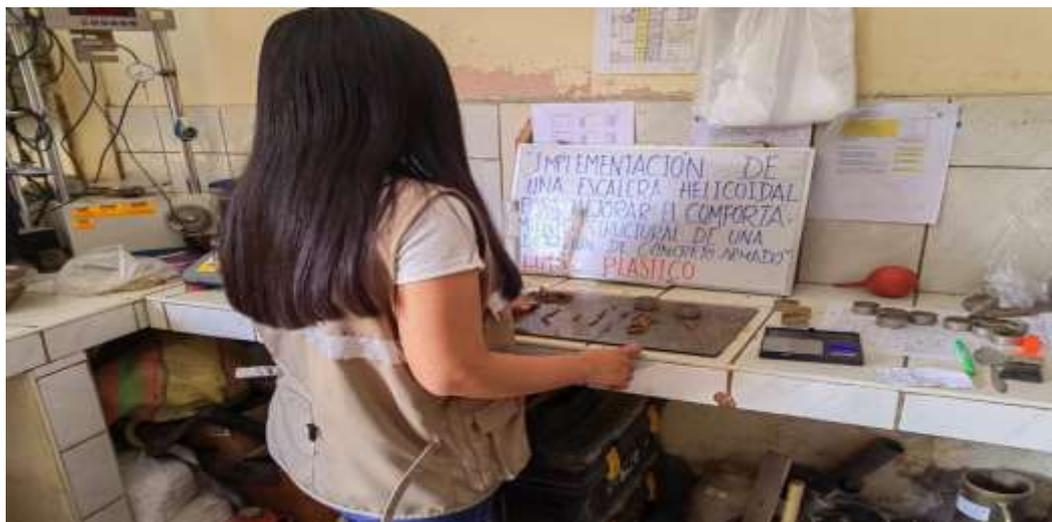
Nota: En la figura 87 se nota la preparación de la porción de la muestra homogeneizada y se moldeo hasta formar un hilo con un diámetro de aproximadamente 3mm.
