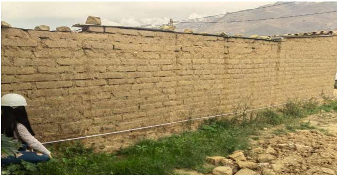
Nota: En la figura 90 se aprecia los puntos de referencia, se procedió a medir con la wincha a lo largo del terreno, manteniéndola recta y sin tensiones. Finalmente se anotó cuidadosamente las medidas tomadas en nuestra libreta de campo.
