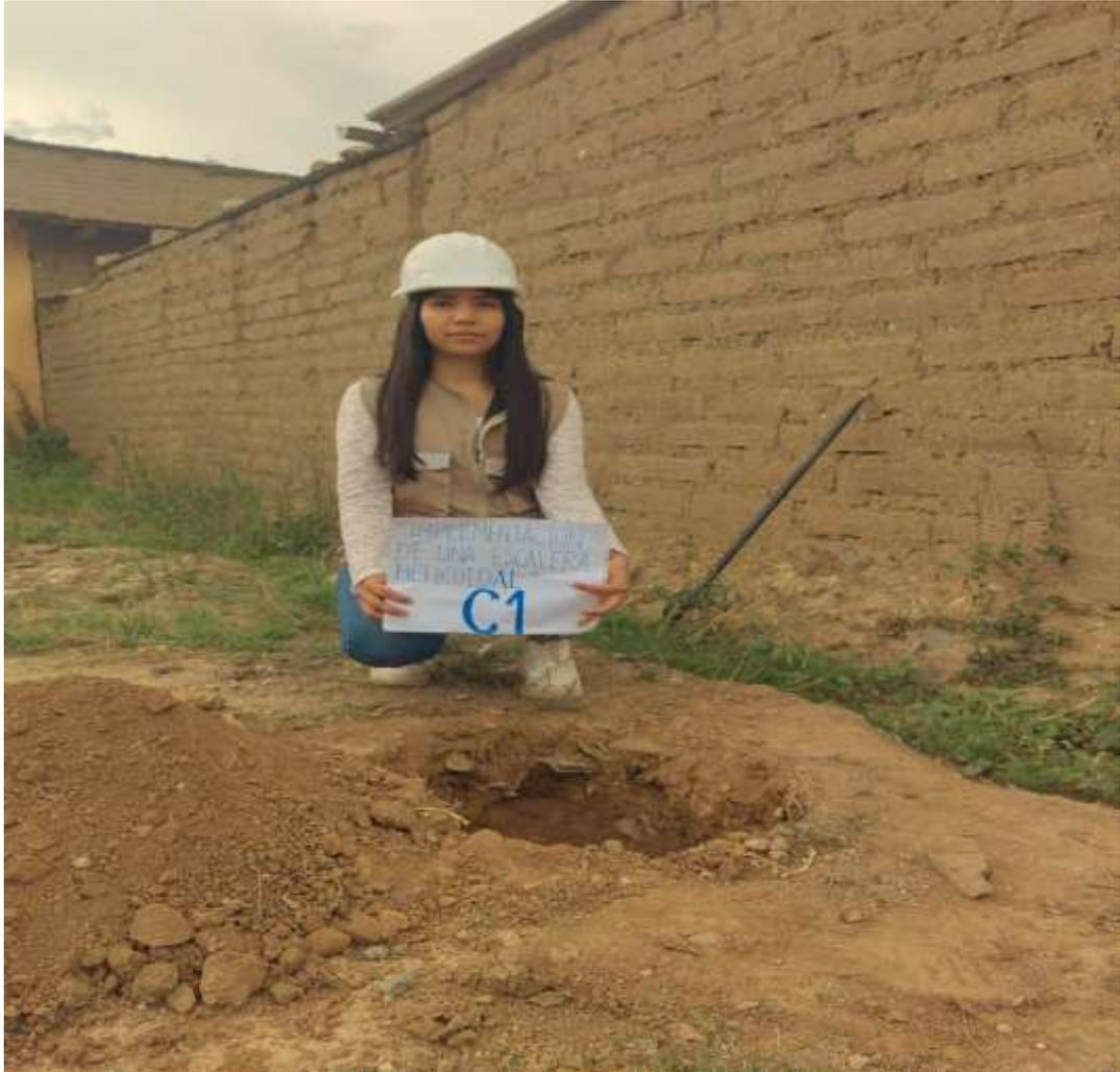
Nota: En la figura 79 se aprecia el lugar donde se realizó la calicata, se comenzó a cavar con la pala, luego se utilizó el pico para romper capas más duras del suelo, posteriormente se midió y se registró el espesor y las características de cada capa de suelo, anotando cualquier cambio significativo o hallazgo relevante. Se recogieron las muestras para análisis. Al finalizar, se tomó precauciones para asegurar la seguridad del área excavada y se tapó adecuadamente.
