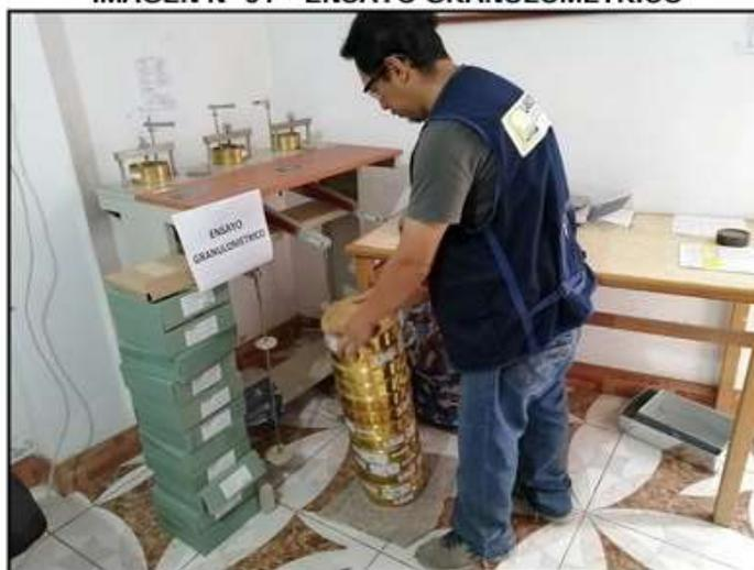
**Distribución Granulométrica;** Se denomina distribución granulométrica de un suelo a la división de este en diferentes fracciones, seleccionadas por el tamaño de sus partículas componentes; las partículas de cada fracción se caracterizan porque su tamaño se encuentra comprendido entre un valor máximo y un valor mínimo, en forma correlativa para las distintas fracciones de tal modo que el máximo de una fracción es el mínimo de la que le sigue correlativamente.
