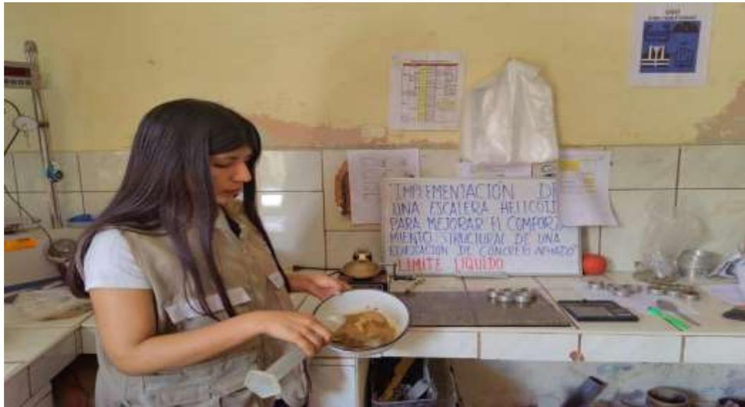
Nota: En la figura 83 se nota la preparación de la muestra, es decir se tomó una muestra de suelo y se homogenizo con agua para formar una pasta de consistencia uniforme.
