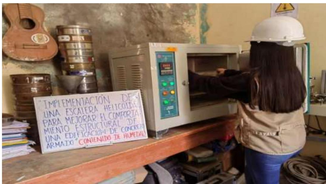
Nota: En la figura 81 se muestra que el tesista coloco en el horno de secado a una temperatura específica (generalmente entre 105°C y 110°C) durante un período de tiempo determinado (generalmente 24 horas).
