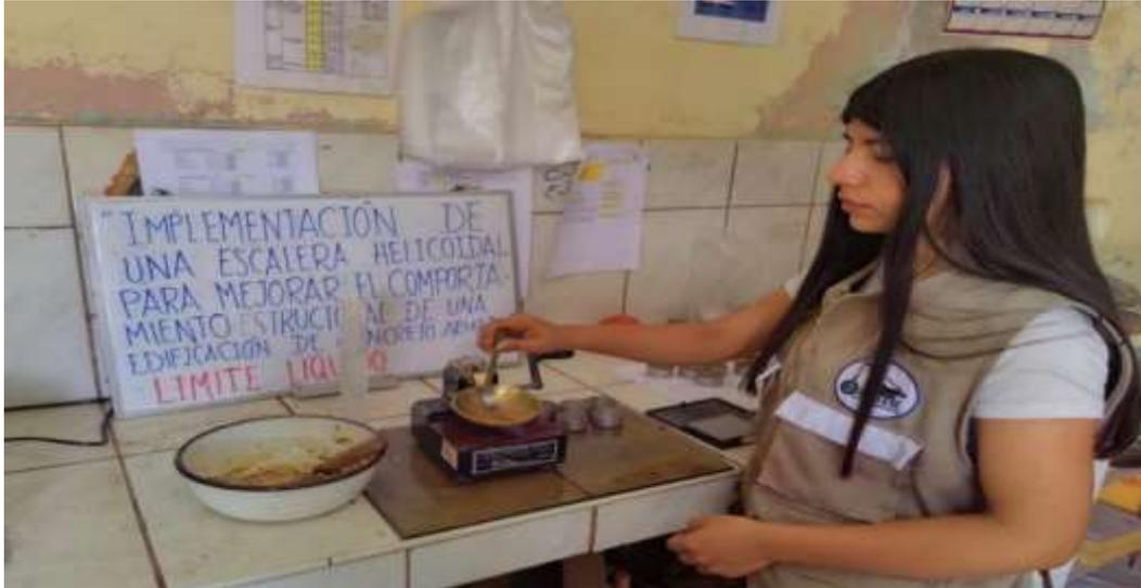
Nota: En la figura 85 se nota el ensayo de golpes sobre la copa de Casagrande, aplicando una pequeña cantidad de energía a la muestra. La pasta se va moldeando hasta perder su forma y fluir ligeramente.
