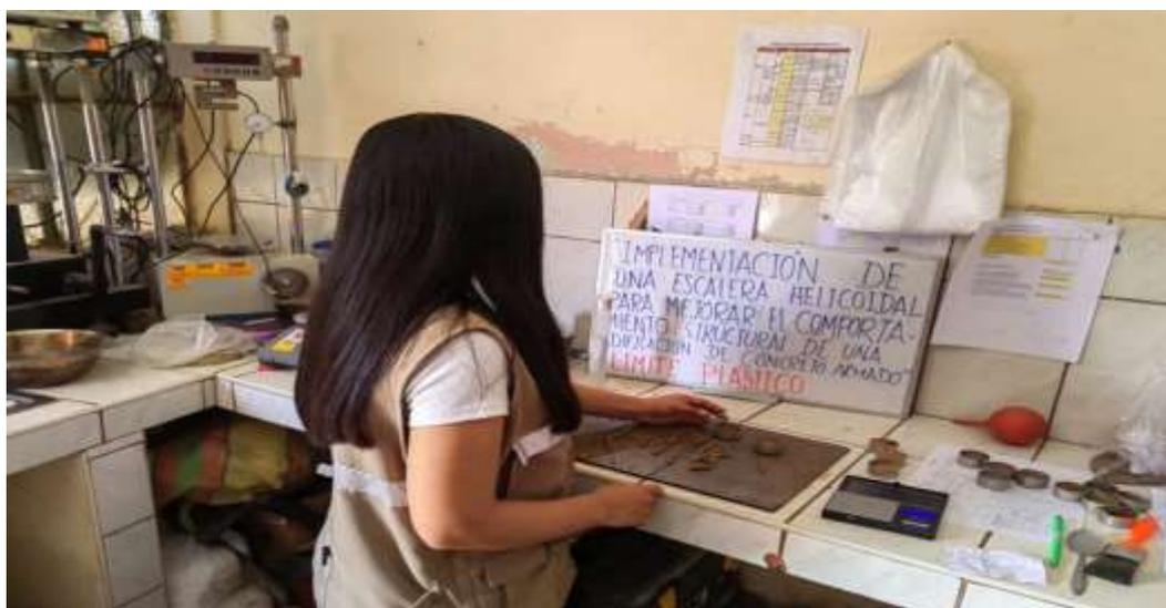
Nota: En la figura 88 se realizó el ensayo de enrollamiento del hilo de suelo sobre una placa de vidrio. Se enrolló hasta que se rompió. Finalmente, el límite plástico se calculó con base en la humedad en la que el hilo de suelo se rompió.
