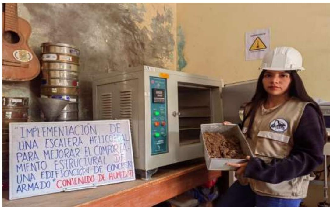
Nota: En la figura 80 se aprecia al tesista sostener la muestra representativa del suelo para ser analizada.
