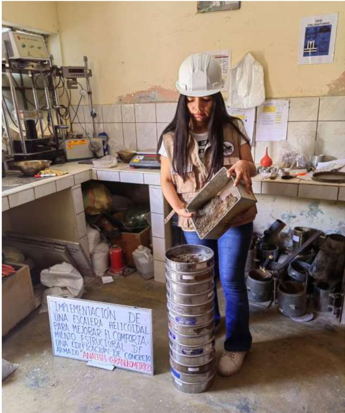
Nota: En la figura 82 se aprecia la colocación de la muestra en el tamiz superior y se tamizo agitando manualmente. Después de tamizar y se registró la masa de material retenido en cada tamiz y se calculó el porcentaje de material retenido en cada tamiz respecto al peso inicial de la muestra.
