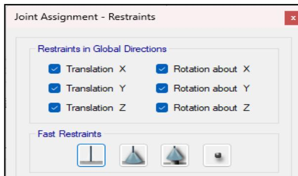
*Nota: En la anterior imagen se puede apreciar la asignación de las restricciones en la base de la estructura para el diseño estructural de un auditorio en el software ETABS.*
