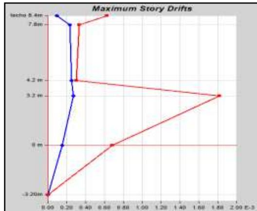
Nota: En la anterior imagen se puede apreciar las derivas elásticas Y-Y de la norma E030 2018 (se aprecia las derivas por niveles y se observa que la máxima deriva se encuentra en el nivel 3.2m siendo esta la que mayor desplazamiento lateral relativo) de la estructura para el diseño estructural de un auditorio en el software ETABS.
