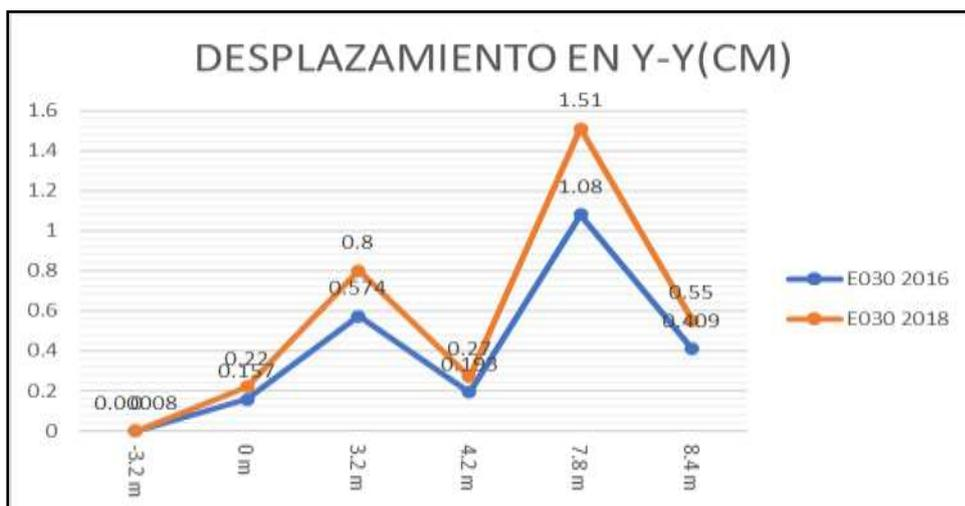
Nota: En la anterior imagen se puede apreciar la comparación de desplazamiento máxima X-X entre la norma E030 2016 y E030 2018. (se aprecia Los desplazamientos por niveles y se observa que la máxima deriva se encuentra en el nivel 7.8m siendo esta la que mayor desplazamiento lateral relativo) de la estructura para el diseño estructural de un auditorio en el software ETABS.
