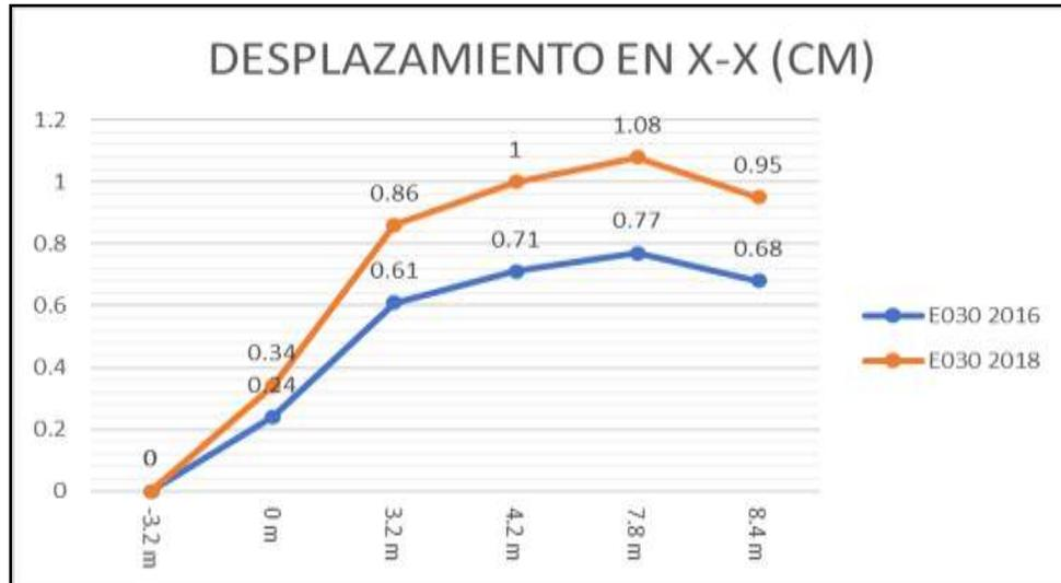
Nota: En la anterior imagen se puede apreciar la comparación de desplazamiento máxima X-X (Fuerza cortante basal corregida) entre la norma E030 2016 y E030 2018. (se aprecia Los desplazamientos por niveles y se observa que la máxima deriva se encuentra en el nivel 7.8m siendo esta la que mayor desplazamiento lateral relativo) de la estructura para el diseño estructural de un auditorio en el software ETABS.
