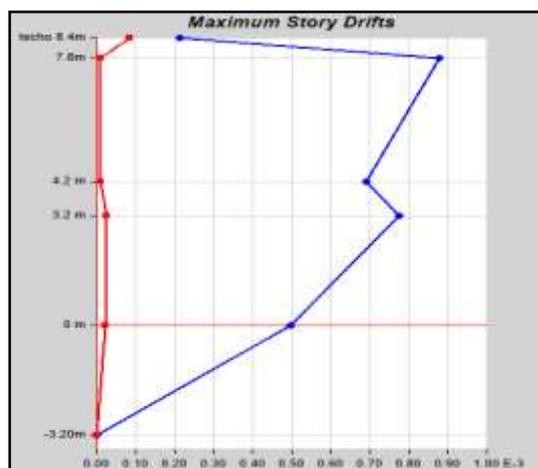
Nota: En la anterior imagen se puede apreciar las derivas elásticas X-X de la norma E030 2016(se aprecia las derivas por niveles y se observa que la máxima deriva se encuentra en el nivel 7.8m siendo esta la que mayor desplazamiento lateral relativo) de la estructura para el diseño estructural de un auditorio en el software ETABS.
