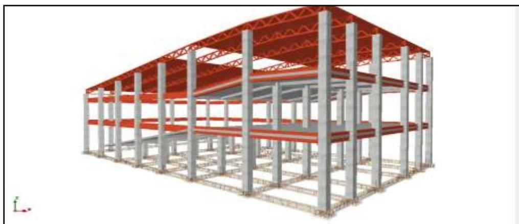
*Nota: En la anterior imagen se puede apreciar la vista isométrica del modelamiento completo de la estructura para el diseño estructural de un auditorio en el software CYPE 3D.*
