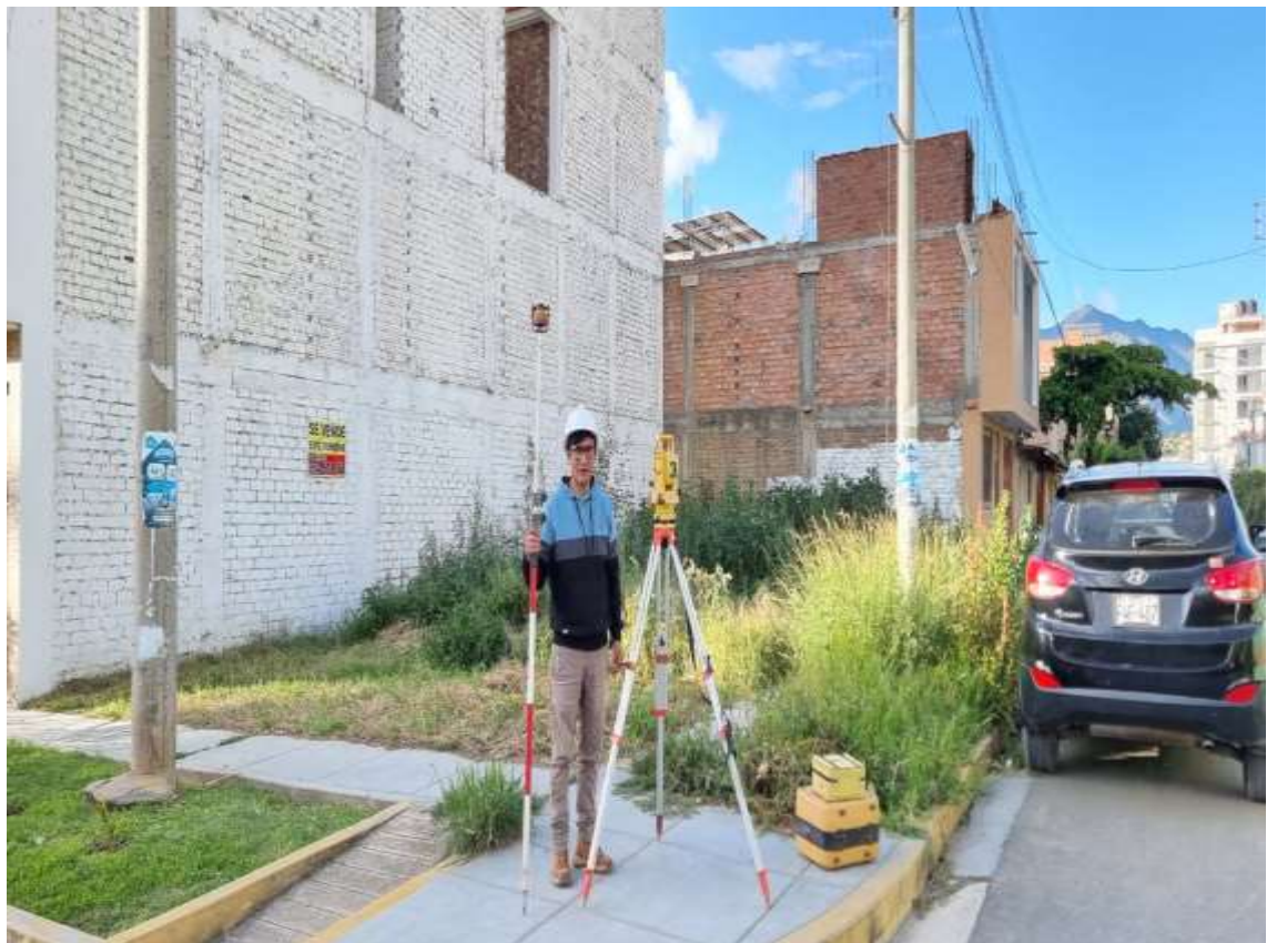
Se muestra los instrumentos empleados para realizar el levantamiento topográfico del terreno, como son: Estación total Topcon, prisma, jalón, trípode y otros.
