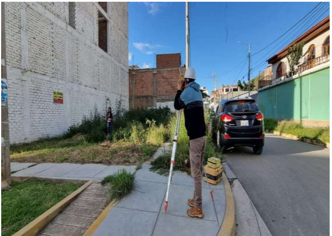
La imagen muestra la toma de puntos del terreno para determinar el perfil, el área, el perímetro, y otros componentes que se tiene en el lugar propuesto para la tesis.
