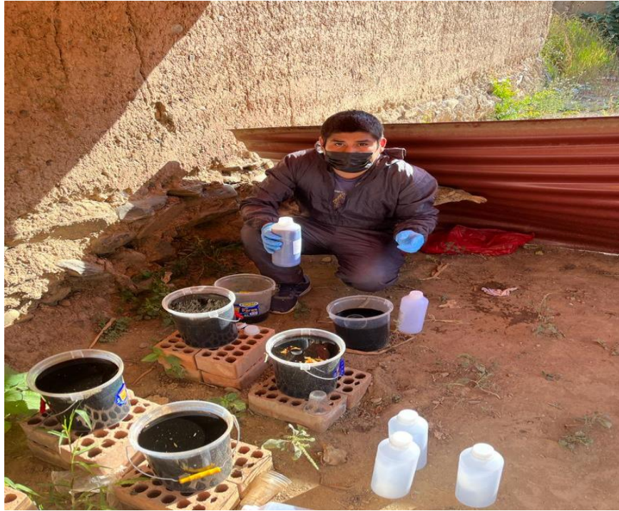
Toma de muestra de los lixiviados tratados
