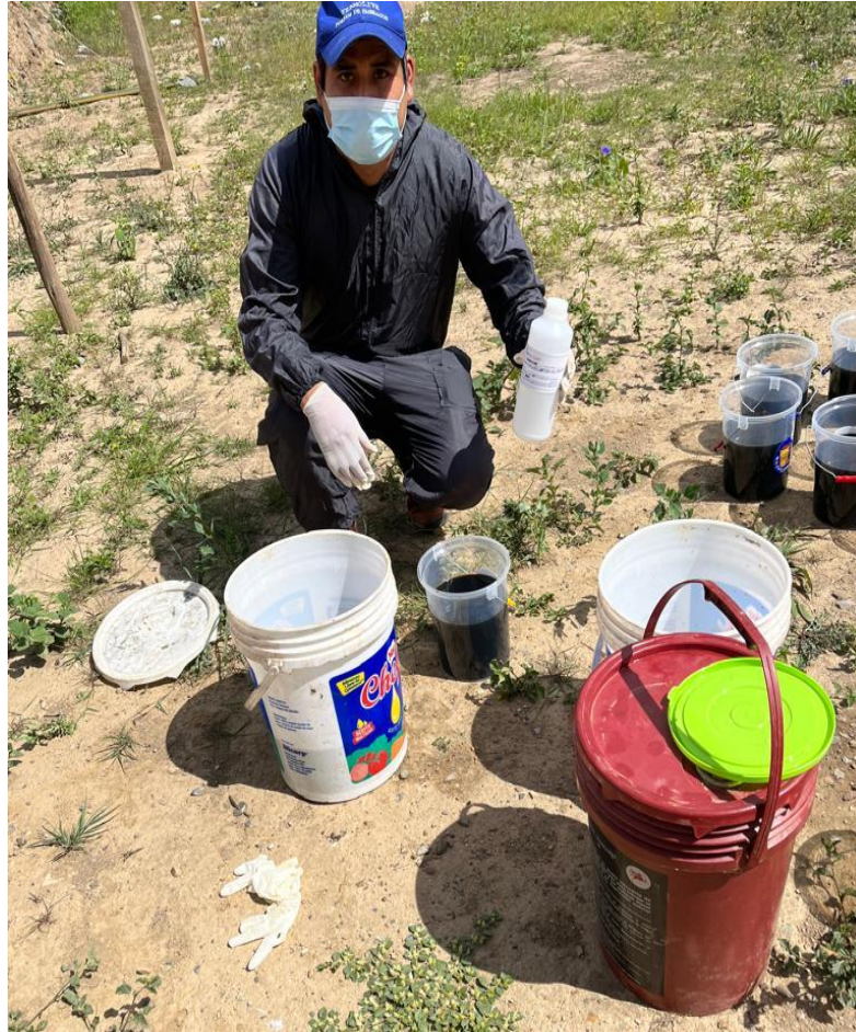
Tratamiento del lixiviado con sulfato férrico
