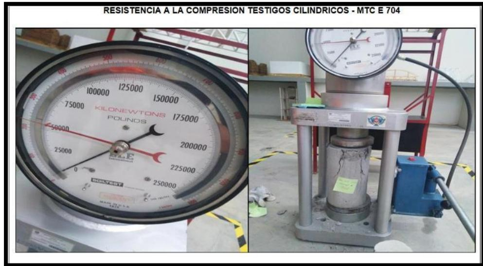
*Nota:* Se observa el equipo utilizado para la prueba de resistencia a la compresión de la probeta.
