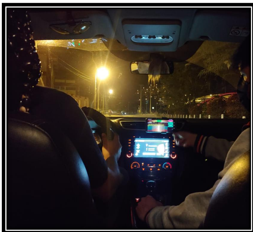
Se observa al tesista realizando el cálculo del IRI mediante el aplicativo para smartphone IRI ABAKAL en el día 03.
