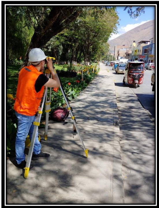
Se observa al tesista realizando la nivelación topográfica el día 03.
