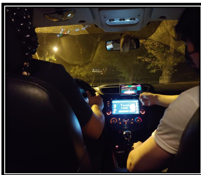
Se observa al tesista realizando el cálculo del IRI mediante el aplicativo para smartphone IRI ABAKAL el día 04.
