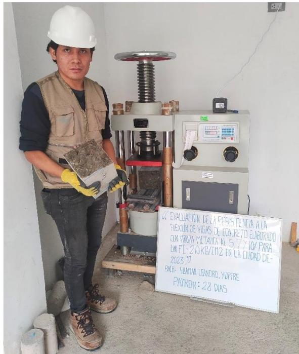
Nota: Se observa el final del ensayo del MR para la muestra de viga del grupo patrón.
