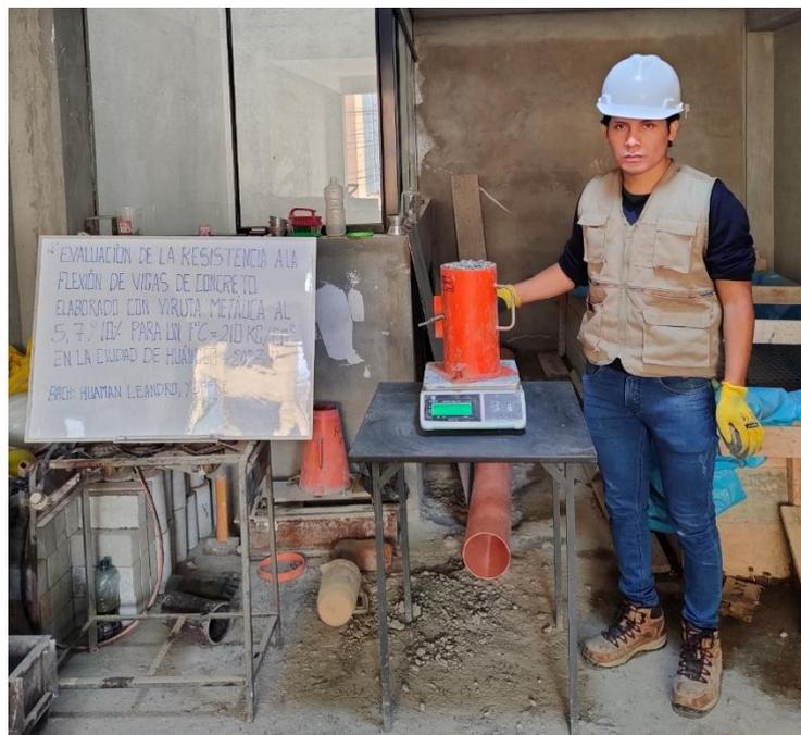
*Nota: se pesará el molde con el agregado grueso suelto sin compactar para determinar los valores según la NTP 400.017*
