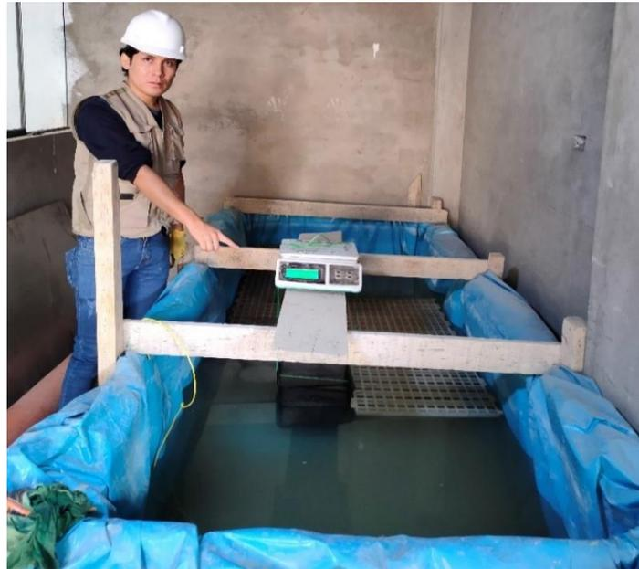
*Nota: se pesará el molde con el agregado grueso saturado en agua como lo estipula la NTP 400.021*
