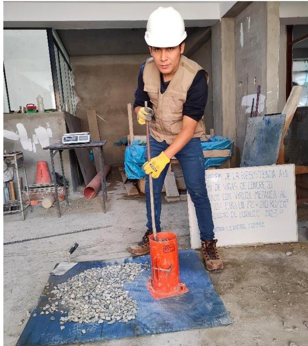
*Nota: se llenara el recipiente con el agregado grueso hasta el ras que se tendrá que compactar con 25 golpes a cada 1/3 de volumen por capa usando una varilla redondeada de 16mm de diámetro.*
