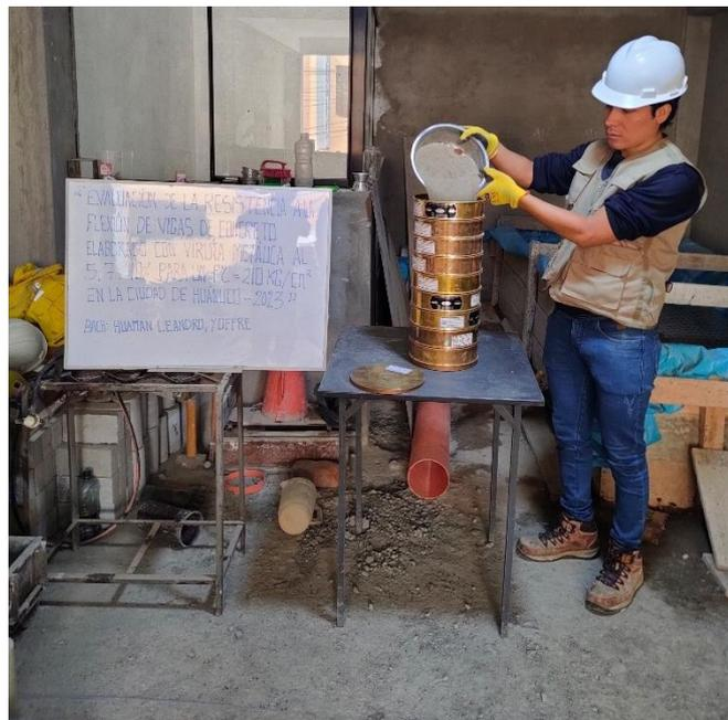
*Nota: se muestra el procedimiento con un peso de 1k para el ensayo granulométrico ordenándose los tamices desde una 3/4" hasta el tamiz N° 200 y se agita los tamices en un periodo 10 min como lo estipula la NTP 400.012 (Granulometría).*
