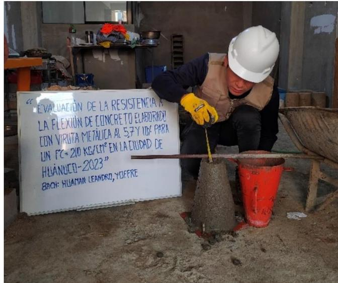
*Nota: Proceso del ensayo cono de Abrams al terminar la compactación de los 25 golpes por cada capa 1/3 se levantará el molde y se invertirá para poder medir desde su base y poder determinar su asentamiento lo cual dio una medida de 2" (seca) según lo indica la NTP. 339.035.*
