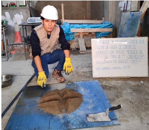
*Nota: se aplanan la pila cónica hasta darle una base circular de tal manera cada cuarto tenga el material original los materiales de uso serán y pesaran dos cuartos diagonales opuestos como lo estipula la NTP 339.089.*
