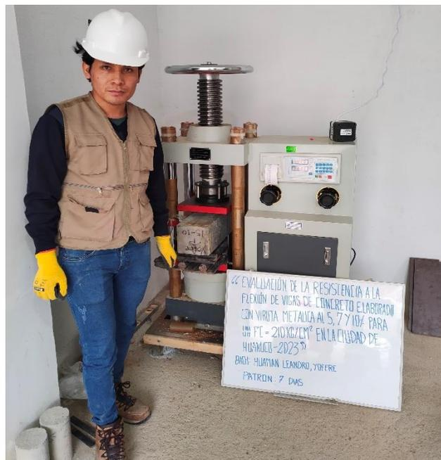
Nota: Se muestra el procedimiento tal como estipula la NTP 339.079 para realizar poder realizar el ensayo.
