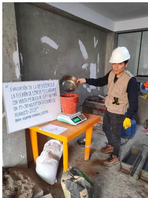
*Nota: se pesará el agua según la dosificación del concreto para  $f'c=210\text{ kg/cm}^2$  como lo indica la norma ACI 211*
