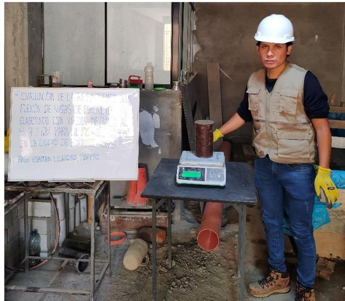
*Nota: se pesará el recipiente con el agregado fino suelto sin compactar para determinar su peso unitario y vacío del agregado como lo estipula la NTP 400.017.*
