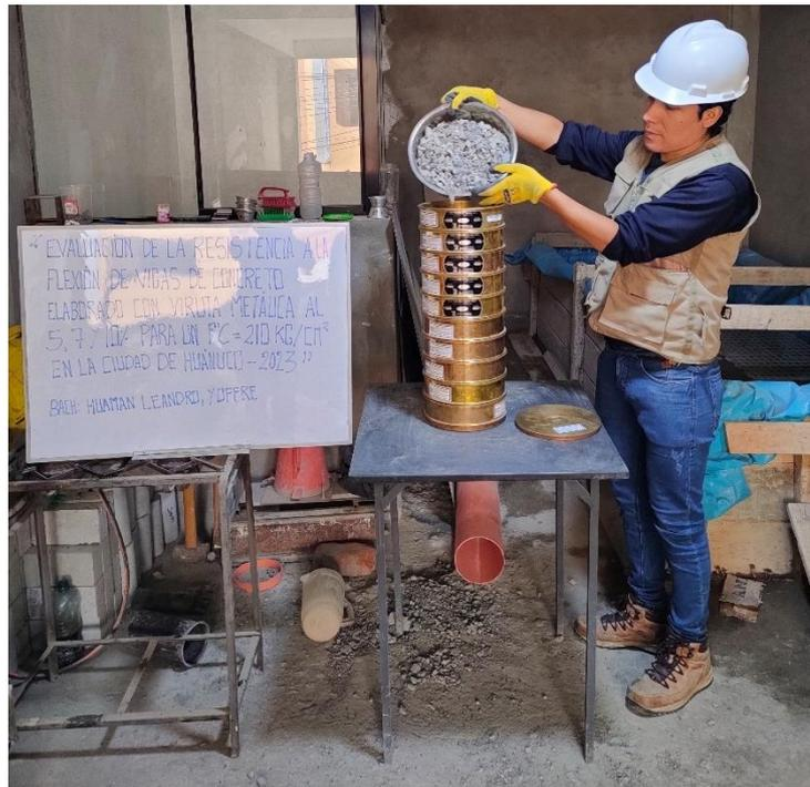
*Nota: se realiza el procedimiento con un peso de 5k para el ensayo granulométrico ordenándose los tamices desde una 1 ½" hasta el tamiz N° 30 y se agita los tamices en un periodo 10 min como lo estipula la NTP 400.012 (Granulometría).*
