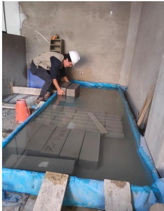
Nota: Las vigas de concreto tanto patrón y con adición de 5%, 7% y 10% de viruta metálica después del fraguado se pondrá a curar las vigas hasta los días de ensayo de resistencia a la flexión.
