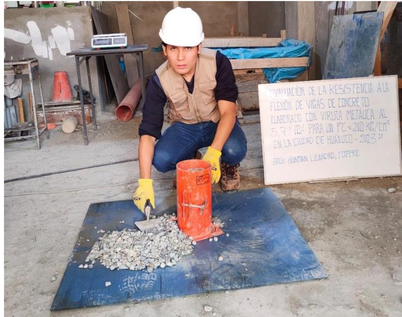
*Nota: se llenara el molde con el agregado grueso hasta el ras sin compactar como lo estipula la NTP 400.017 (Peso unitario y vacío de los agregados)*
