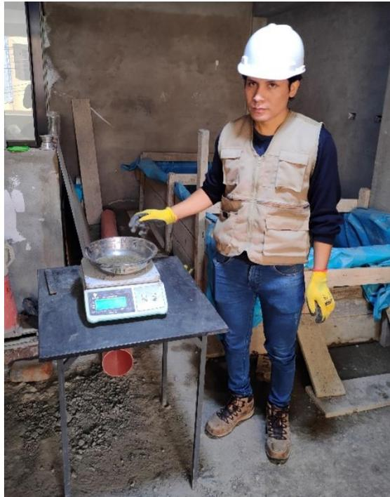
*Nota: se pesa el agregado fino seco más la tara después de ver estado en el horno de  $110^{\circ}\text{C} \pm 5^{\circ}\text{C}$  por un periodo de 24 horas como lo estipula la NTP 339.127 (Contenido de humedad).*
