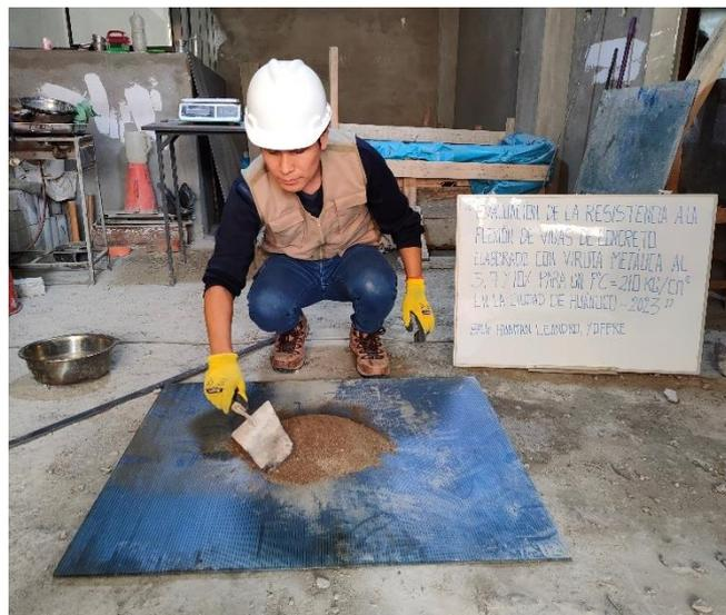
*Nota: se coloca los agregados sobre una superficie dura, limpia y horizontal evitando cualquier pérdida de material o la adición de sustancias extrañas, se apilará el material de forma cónica de modo que el material caiga uniforme por los lados de lo mismo como lo estipula la NTP 339.089*
