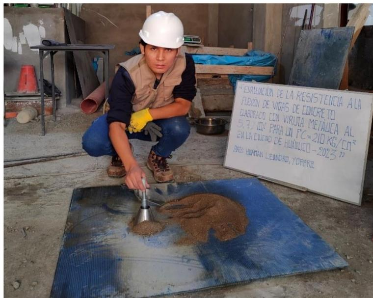
*Nota: el cono de truncado se llenará con el agregado fino húmedo superficial y compactando 25 golpes con el pisón como lo estipula la NTP 400.022.*
