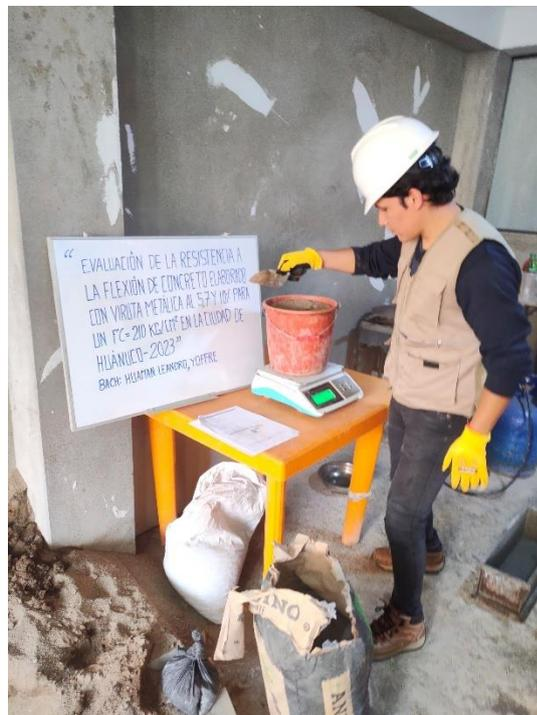
*Nota: se pesará el agregado fino según la dosificación de concreto con  $f'c=210\text{kg/cm}^2$  como lo indica la norma ACI 211*
