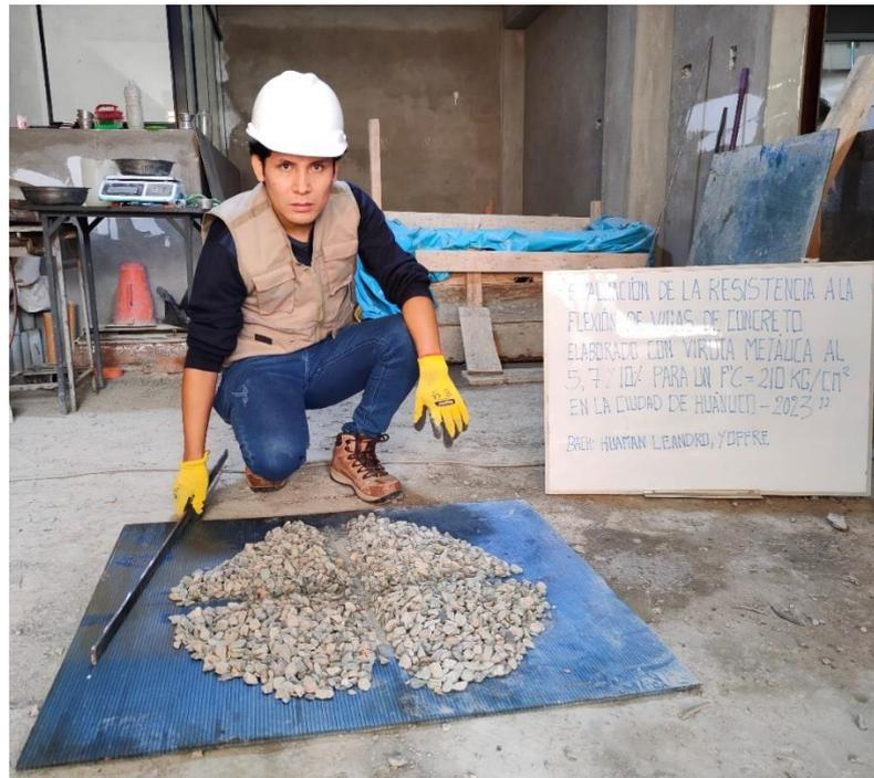
*Nota: se aplanan la pila cónica hasta darle una base circular de tal manera cada cuarto tenga el material original los materiales de uso serán y pesaran dos cuartos diagonales opuestos como lo estipula la NTP 339.089.*
