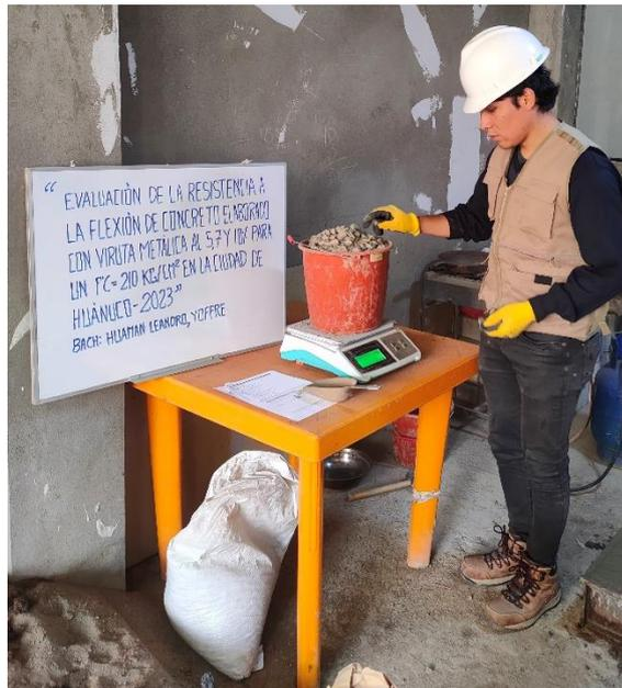
*Nota: se pesará el agregado grueso según la dosificación del concreto con una resistencia  $f'c=210\text{kg/cm}^2$  como lo indica la norma ACI 211*
