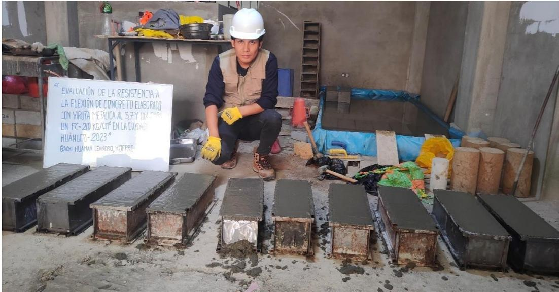
Nota: Las vigas de concreto fraguaron durante 24 horas según lo estipulado en la NTP 339.079.
