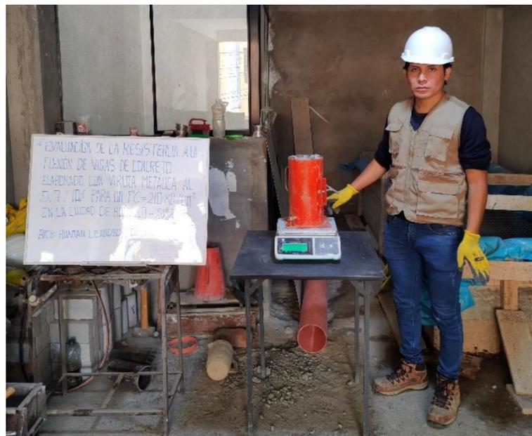
*Nota: se pesará el molde con el agregado grueso compactado para determinar el peso unitario y vacío del agregado grueso como lo estipula la NTP 400.017*
