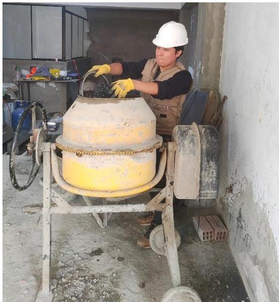
*Nota: Proceso de elaboración del concreto como lo indica la norma ACI 211, se usará la adición 7% de virutas metálica para la elaboración de las muestras de vigas para ser ensayadas según la NTP 339.079.*
