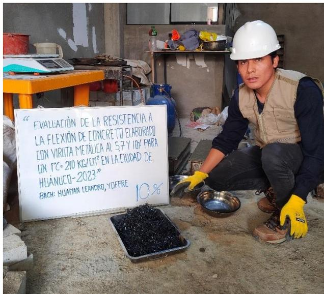
Nota: se seleccionará las virutas metálicas de acero negro en un 10% respecto el agregado grueso, se adicionará la viruta metálica al concreto para realizar las vigas con dimensiones de 50x15x15 cm.
