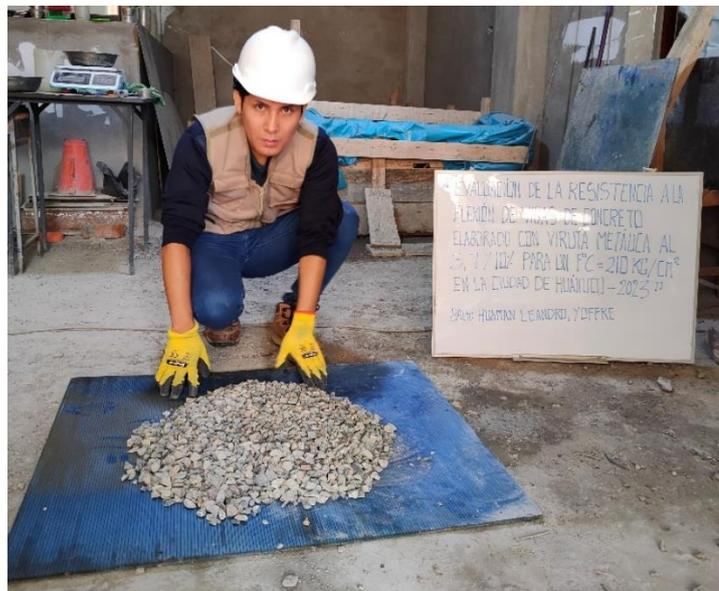
*Nota: se coloca los agregados sobre una superficie dura, limpia y horizontal evitando cualquier pérdida de material o la adición de sustancias extrañas, se apilará el material de forma cónica de modo que el material caiga uniforme por los lados de lo mismo como lo estipula la NTP 339.089.*
