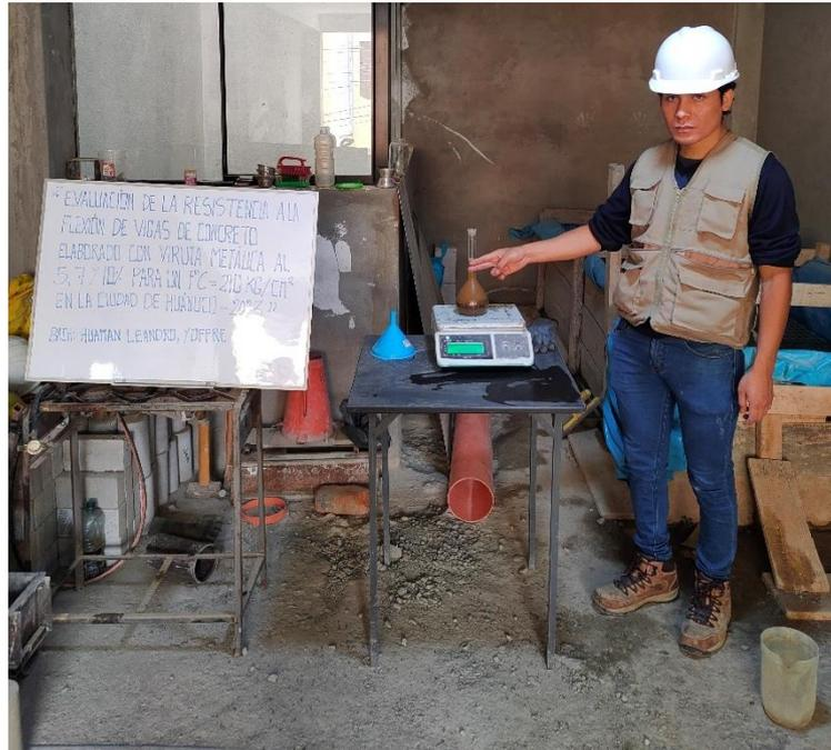
*Nota: se llenará cuidadosamente con agua destilada junto con el agregado fino y sometiendo en baño maría para que quite el aire que se introdujo con el agregado fino como lo estipula la NTP 400.022*
