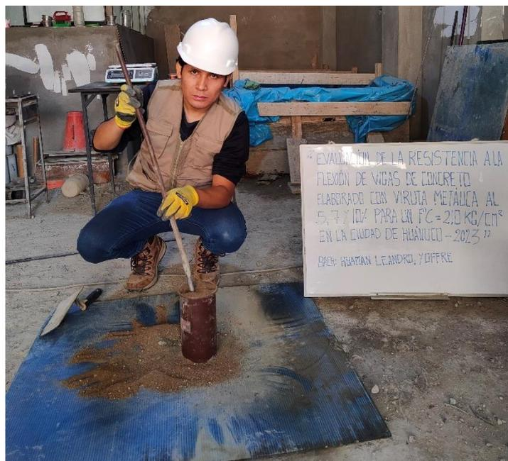
*Nota: se llenara el molde con el agregado fino hasta el ras que se tendrá que compactar con 25 golpes a cada 1/3 de volumen por capa usando una varilla redondeada de 16mm de diámetro y aproximado de 600 mm de longitud como lo estipula la NTP 400.017*
