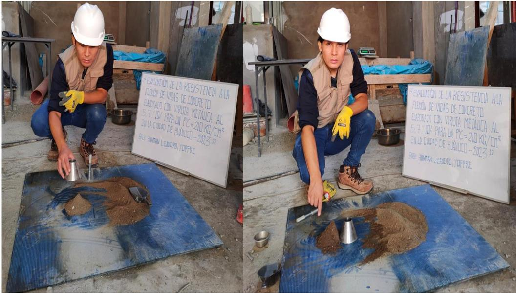
*Nota: si la muestra provisional de superficie no mantiene la forma cónica del cono de absorción se le agregara agua como lo estipula la NTP 400.022*
