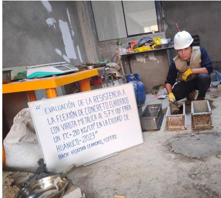
*Nota: se le cubrirá las paredes de los moldes de las vigas con un desmoldante para mayor facilidad para desencofrar.*
