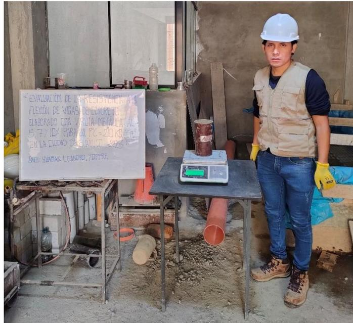
*Nota: se pesará el molde con el agregado fino compactado para determinar el peso unitario y vacío del agregado como lo estipula la NTP 400.017*
