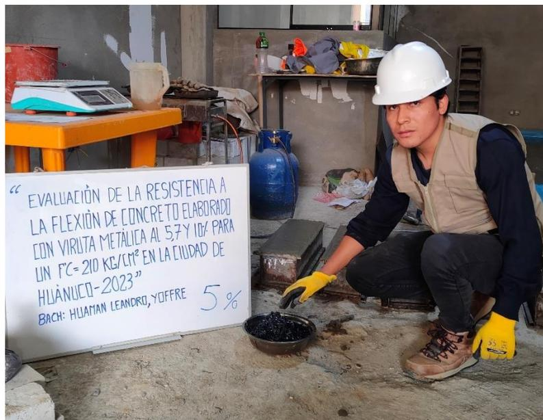
*Nota: se seleccionará las virutas metálicas de acero negro en un 5% respecto el agregado grueso, se adicionará la viruta metálica al concreto  $f'c=210\text{kg/cm}^2$  para la elaboración de las vigas con dimensiones de 50x15x15 cm.*
