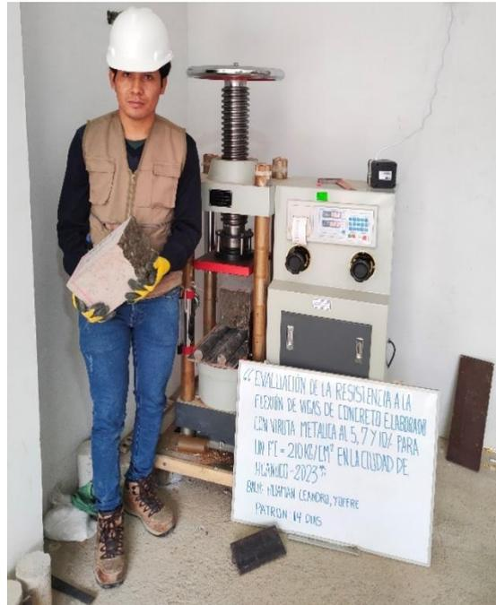
Nota: Se observa el final del ensayo del MR para la muestra de viga del grupo patrón.
