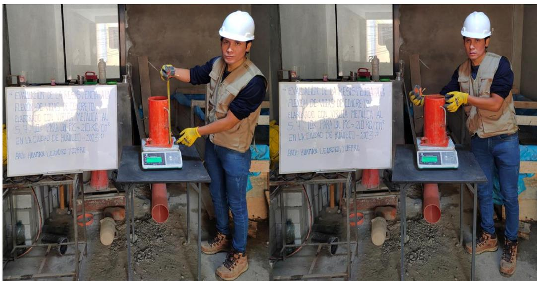
*Nota: se pesará el molde y se determinará el volumen del mismo para hacer los ensayos del agredo compactado y el agregado suelto como lo estipula la NTP 400.017.*
