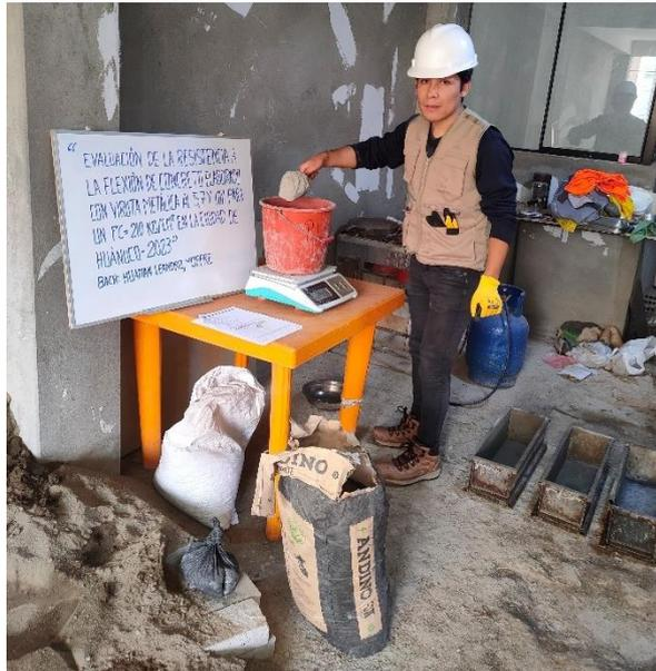
*Nota: se pesará el cemento tipo I según el diseño de la mezcla de concreto con una resistencia  $f'c=210\text{kg/cm}^2$  como lo indica la norma ACI 211.*
