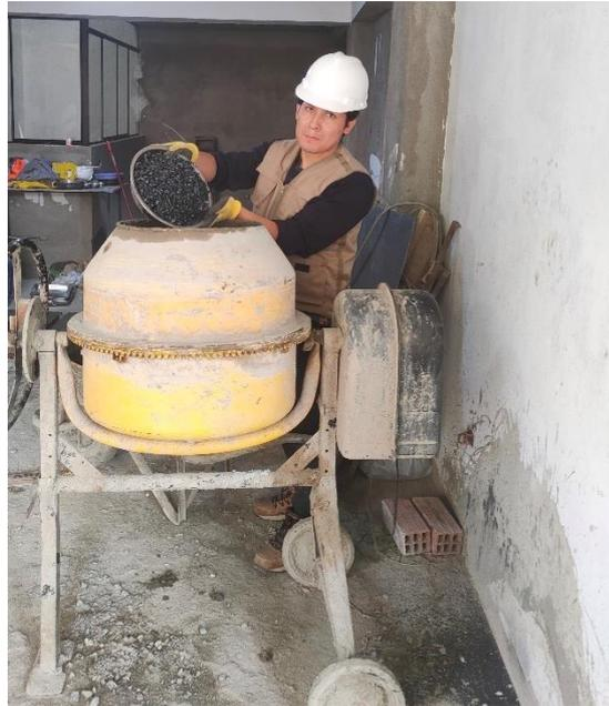
*Nota: Proceso de elaboración del concreto con un  $f'c=210\text{kg/cm}^2$  como lo indica la normativa ACI 211, se usará la adición 5% de virutas metálica para realizar las vigas para ser ensayadas según la NTP 339.079.*
