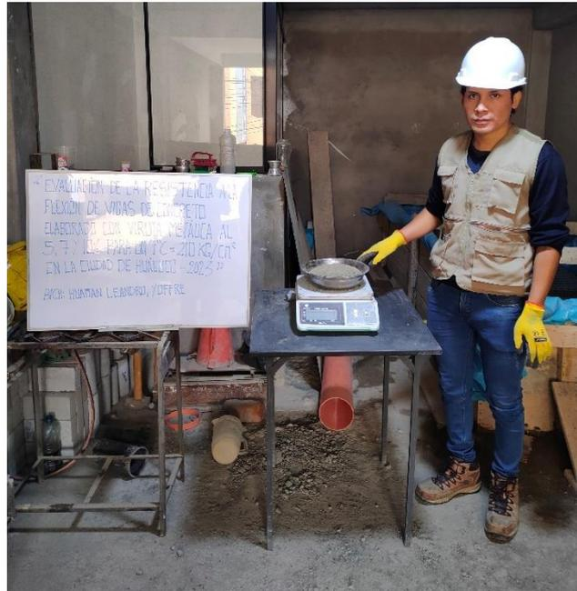
*Nota: se pesa el agregado fino seco más la tara después de ver estado en el horno de  $110^{\circ}\text{C} \pm 5^{\circ}\text{C}$  por un periodo de 24 horas como lo estipula la NTP 400.012 (Granulometría).*
