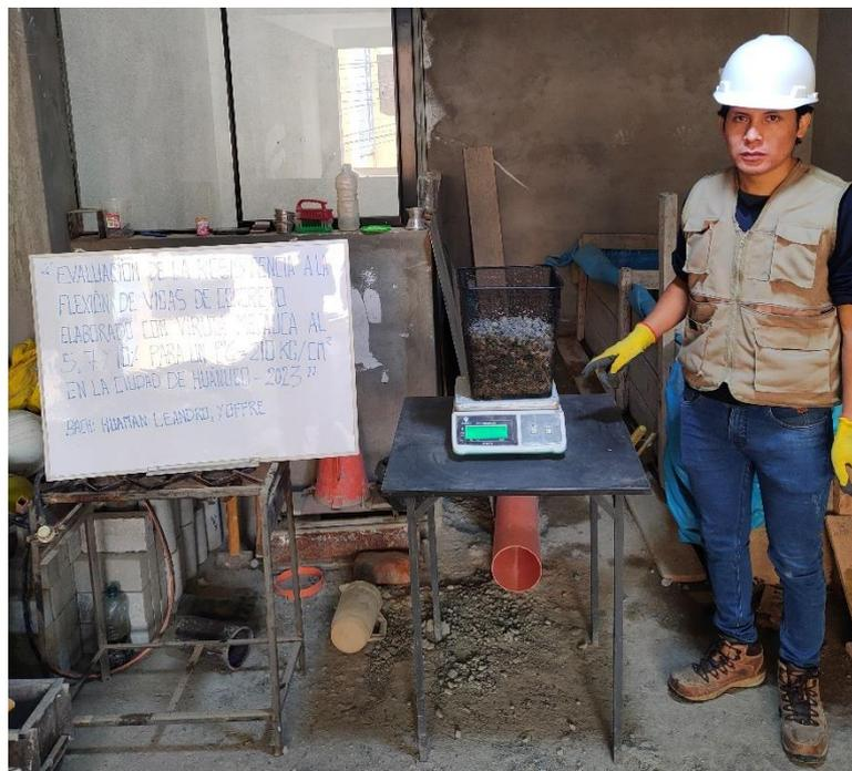
*Nota: se pesará el molde con el agregado grueso saturado en aire como lo estipula la NTP 400.021 (peso específico y absorción del agregado grueso)*
