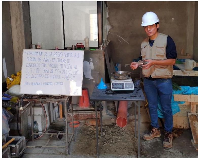
*Nota: se pesará el contenido del matraz y ser llevado al horno de  $110^{\circ}\text{C} \pm 5^{\circ}\text{C}$  por un periodo de 24 horas para determinar la absorción del agredo fino como lo estipula la NTP 400.022*
