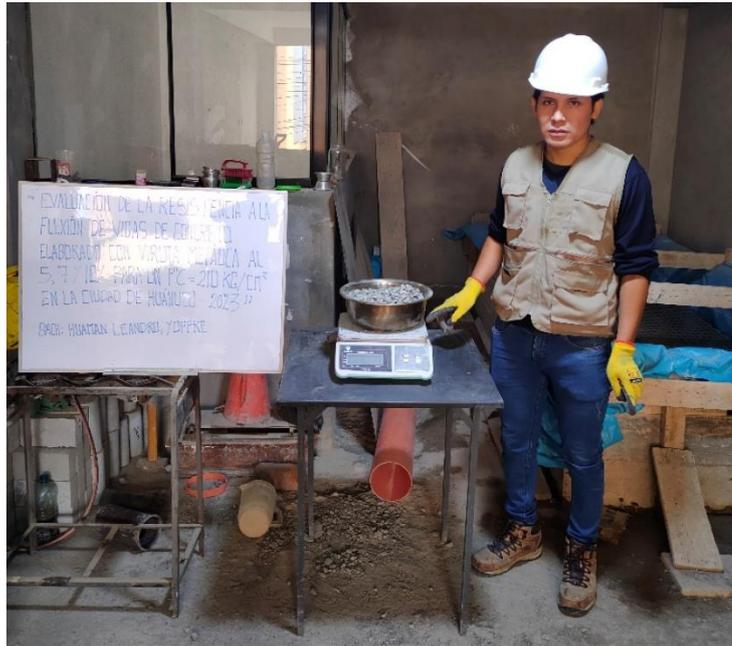
*Nota: se pesa el agregado grueso seco más la tara después de ver estado en el horno de  $110^{\circ}\text{C} \pm 5^{\circ}\text{C}$  por un periodo de 24 horas como lo estipula la NTP 339.127 (Contenido de humedad).*
