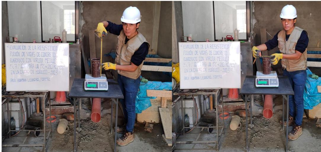
*Nota: se pesará el molde y se determinará el volumen del mismo para hacer los ensayos del agrado compactado y el agregado suelto como lo estipula la NTP 400.017*
