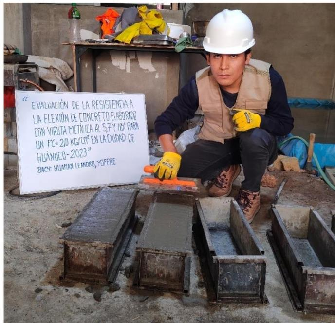
*Nota: Proceso de vaciado de vigas donde se compactará a cada 1/2 de volumen por capa usando una varilla redondeada de 16mm de diámetro y aproximado de 600 mm de longitud se nivelará el concreto al ras con una plancha de pulir según lo indica la NTP. 339.079.*
