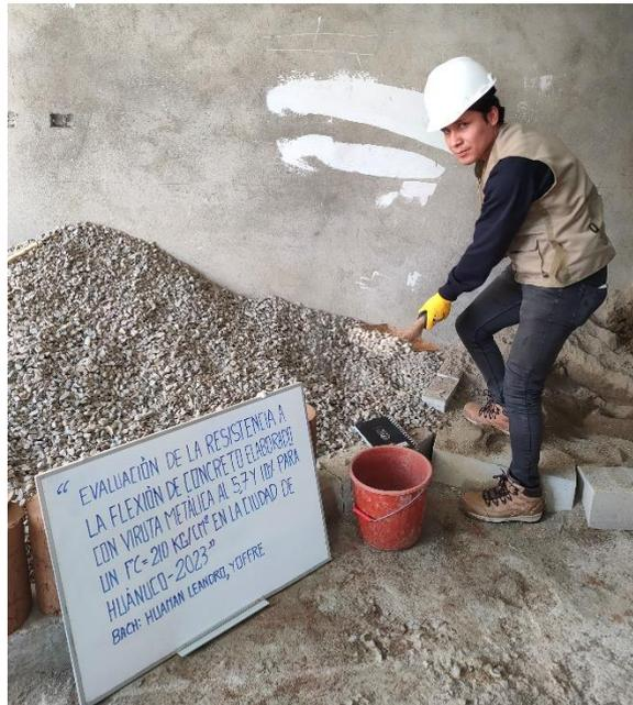
*Nota: se recolecto el agregado grueso de la cantera de Andabamba para para la dosificación del concreto.*
