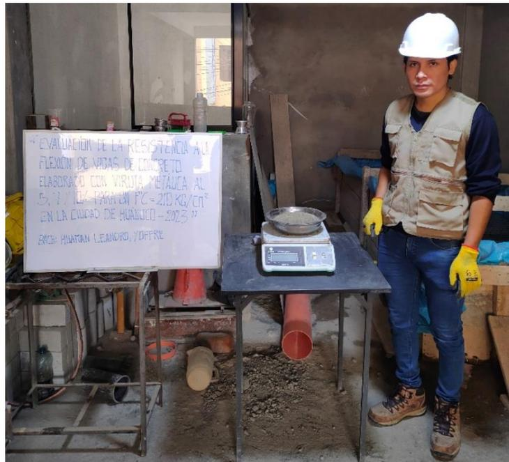
*Nota: se pesará el molde con el agregado seco del suelo en horno a  $110^{\circ}\text{C} \pm 5^{\circ}\text{C}$  por un periodo de 24 horas como lo estipula la NTP 400.022*
