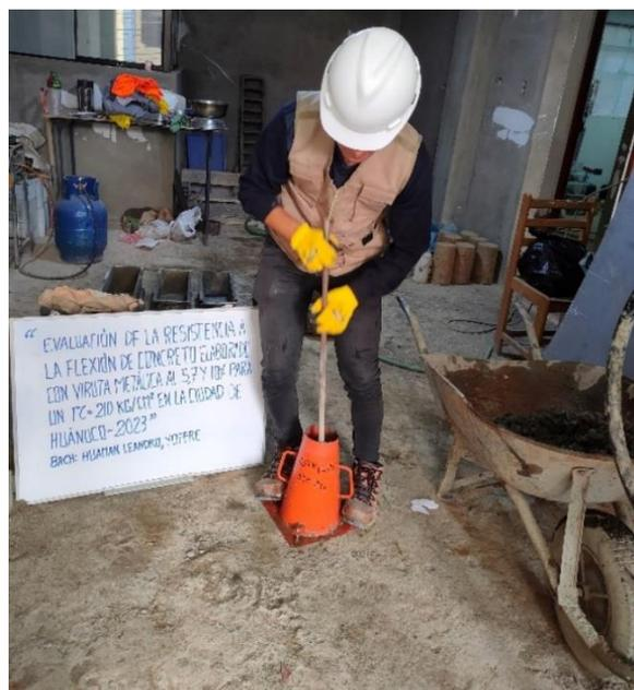
*Nota: Proceso del ensayo cono de Abrams se tendrá que compactar con 25 golpes a cada 1/3 de volumen por capa usando una varilla redondeada de 16mm de diámetro y aproximado de 600 mm de longitud según lo indica la NTP. 339.035.*
