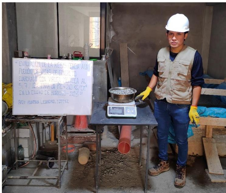
*Nota: se pesa el agregado grueso seco más la tara después de ver estado en el horno de  $110^{\circ}\text{C} \pm 5^{\circ}\text{C}$  por un periodo de 24 horas como lo estipula la NTP 400.012 (Granulometría).*
