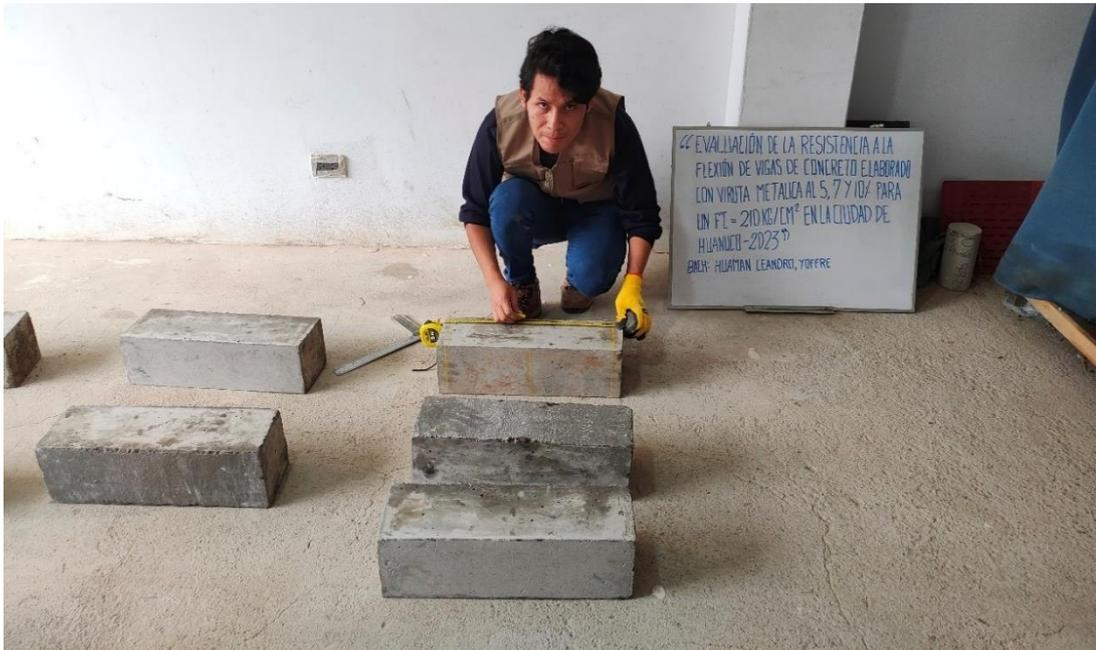
Nota: se trazarán las vigas con respecto a los apoyos con medidas de una 1" a los extremos y una luz de  $L/2$  según el diagrama estipulado en la NTP 339.079.
