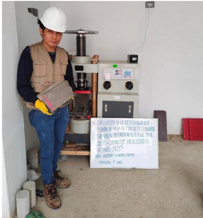
Nota: Se observa el final del ensayo del MR para la muestra de viga del grupo patrón.
