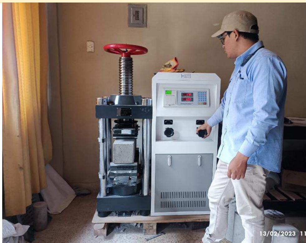
SE PUEDE VISUALIZAR LA ROTURA DE VIGAS A FIN DE VER LA CALIDAD DEL CONCRETO EN PAVIMENTO.
