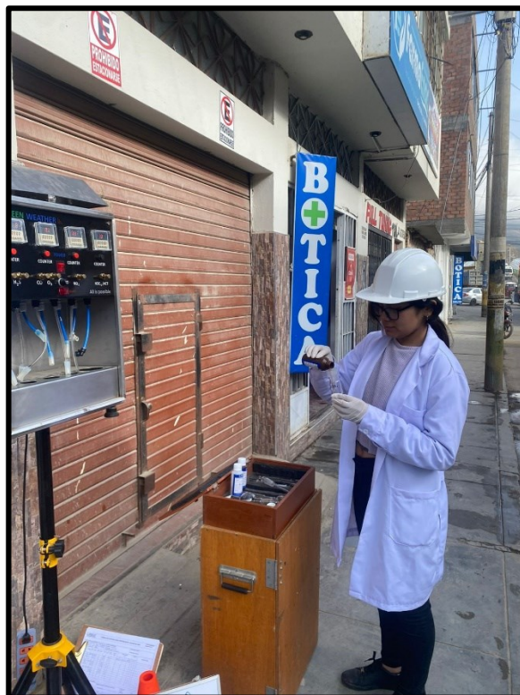
Se vertió la solución captadora para cada gas establecido, siendo utilizada para un buen proceso de muestreo
