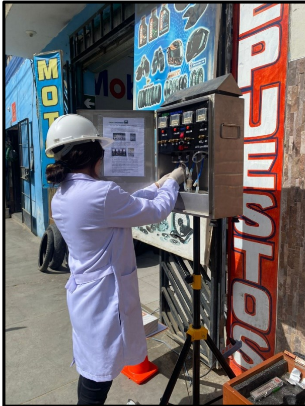
Se colocó los tubos de ensayo en sus respectivos medidores, para cada gas.
