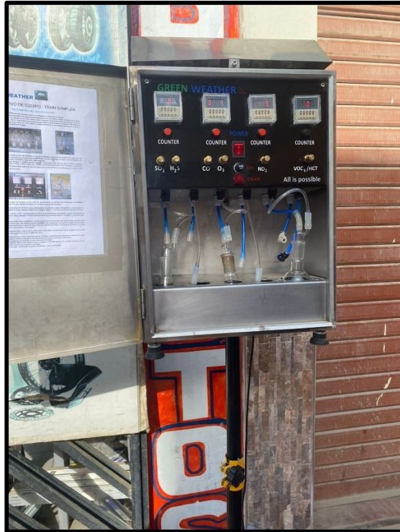
Se calibró el controlador de flujo de cada uno de los medidores del tren de muestreo, para un buen resultado de los gases seleccionados.
