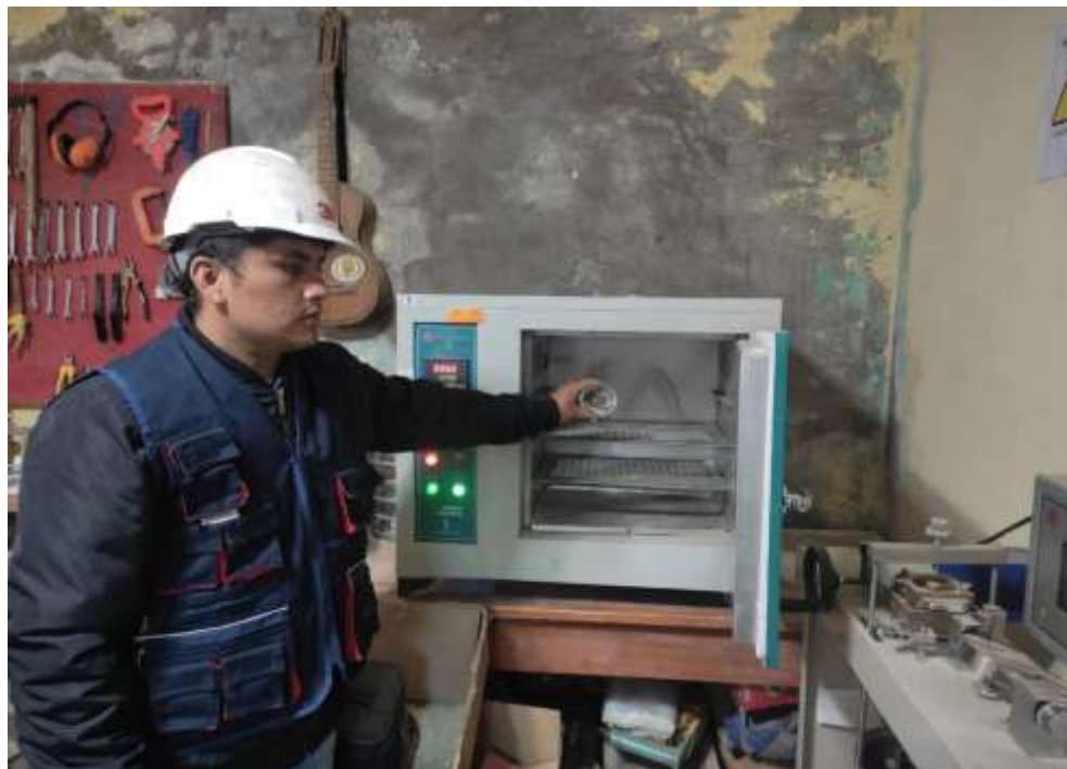
Se aprecia la colocación en el horno de la muestra para determinar el límite plástico
