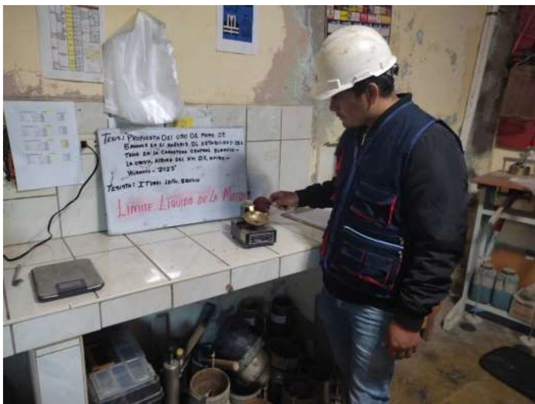
Se aprecia la realización del ensayo de limite liquido con el instrumento Casagrande
