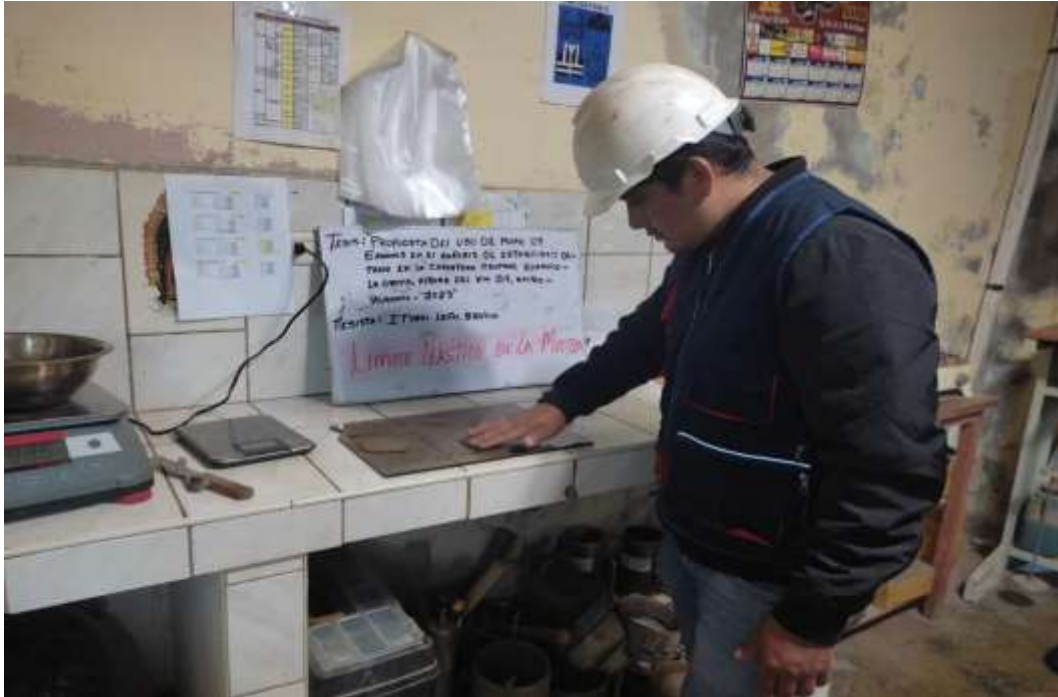
Se aprecia la realización de los choricitos para determinar el límite plástico
