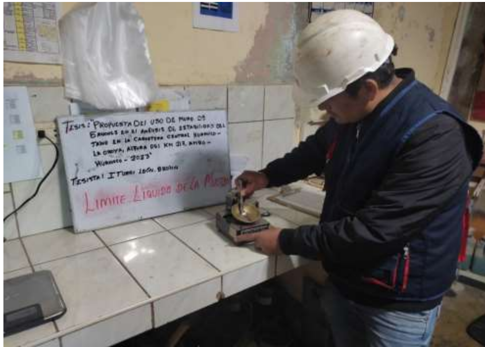
Se aprecia la realización del ensayo de limite liquido con el instrumento Casagrande
