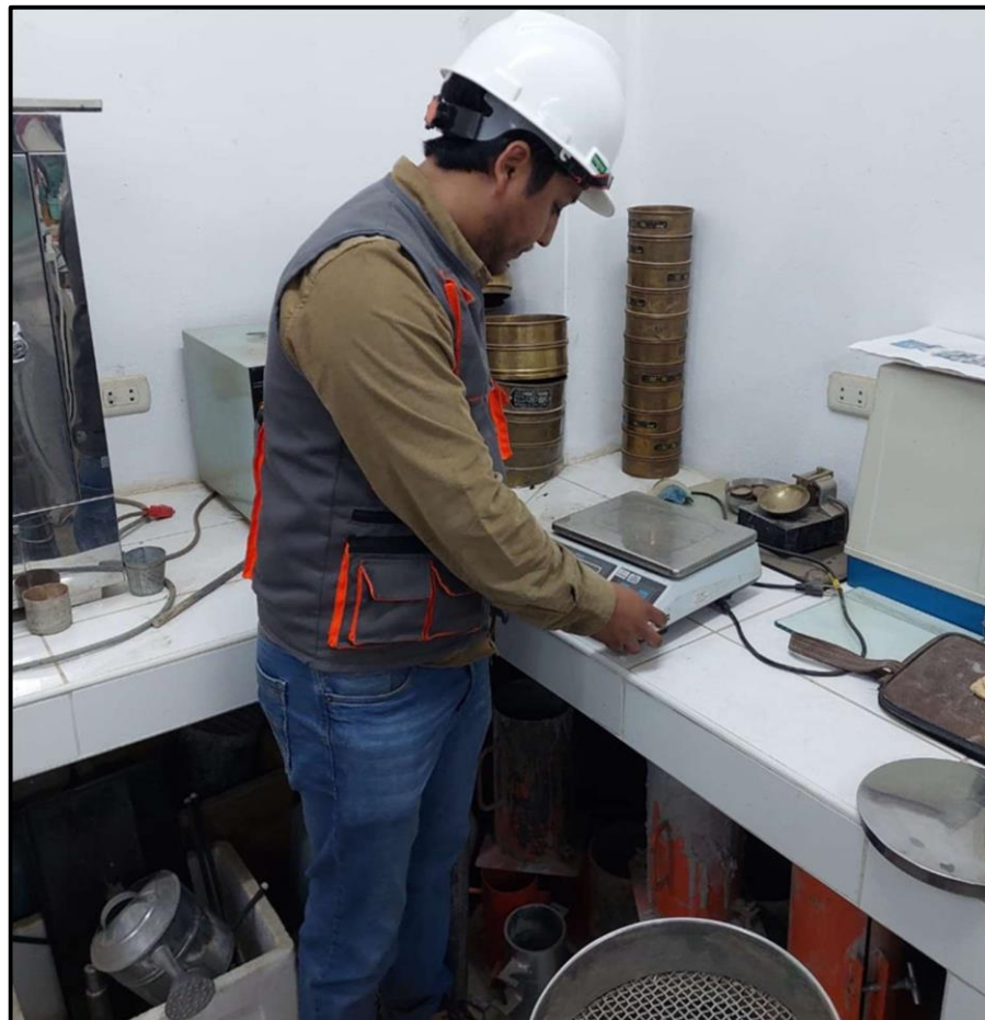
Fotografía 12 Pesaje de la muestra.
