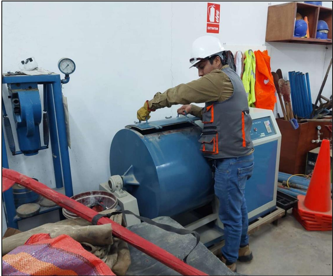
Fotografía 15 Prueba de abrasión Los Ángeles.
