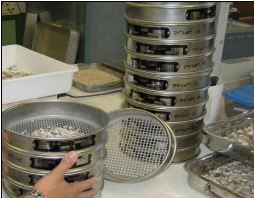
Fotografía 3 Separar el agregado con el tamiz N°4.
