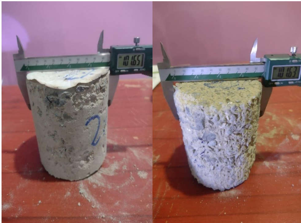
Fotografía 65 Medición de diámetro
