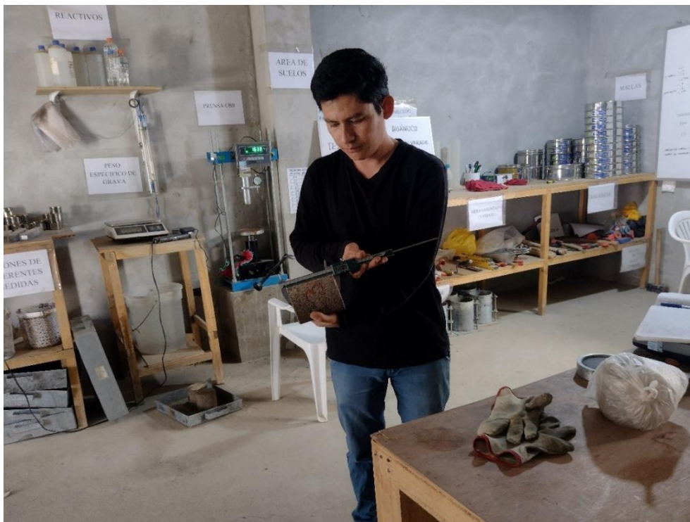
Fotografía 24 Medición de altura de la probeta suelo-cemento
