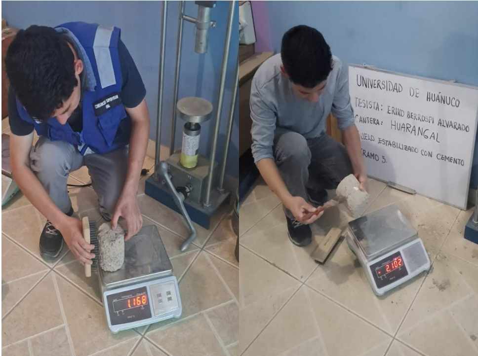
Fotografía 63 Escobillado y limpieza de probetas
