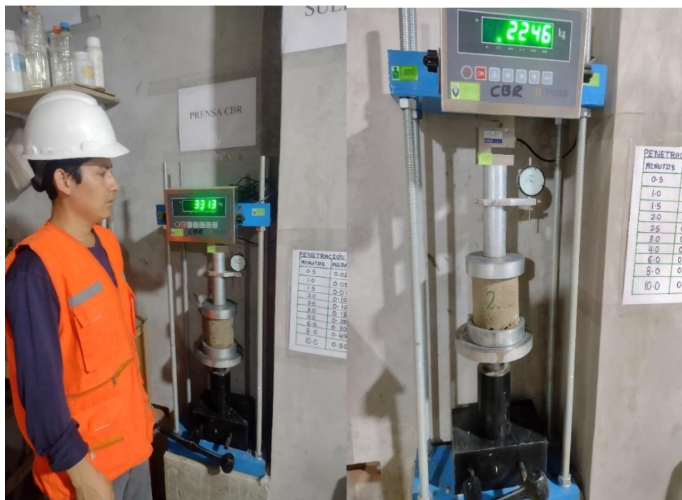
Fotografía 46 Rotura de probetas de suelo-cemento
