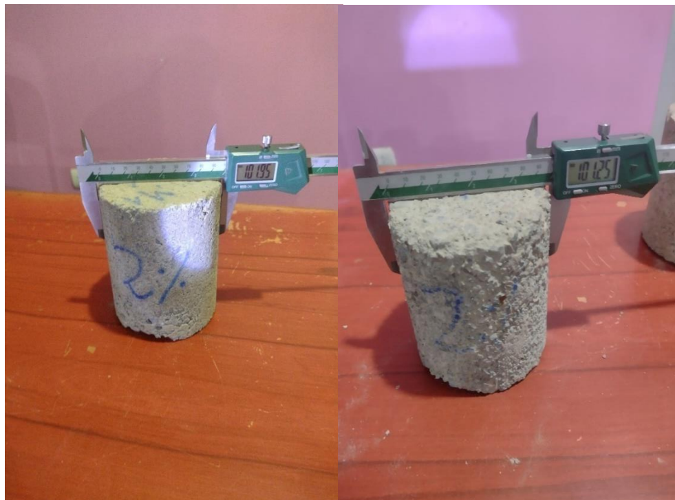
Fotografía 60 Medición de diámetro y la altura
