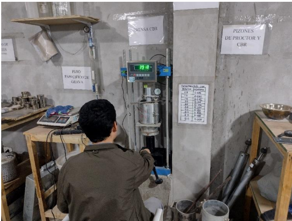
Fotografía 40 Realización del ensayo de CBR
