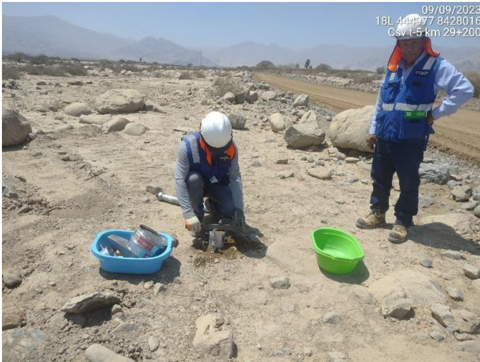
Fotografía 69 Enrazado de la probeta
