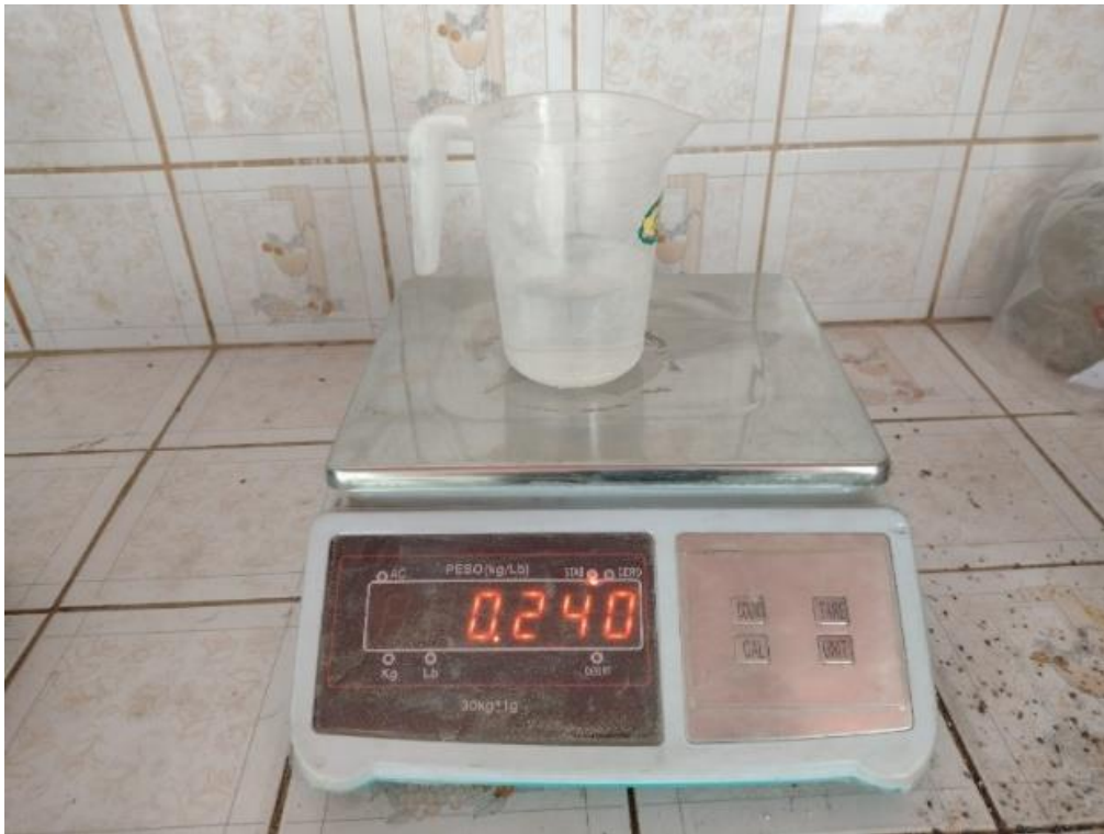
Fotografía 5 Peso del agua para el Proctor modificado
