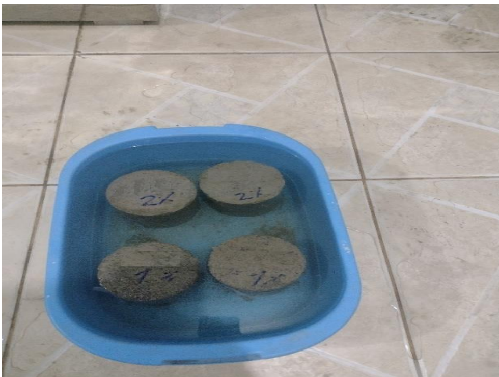
Fotografía 22 Probetas sumergidas en agua para su rotura
