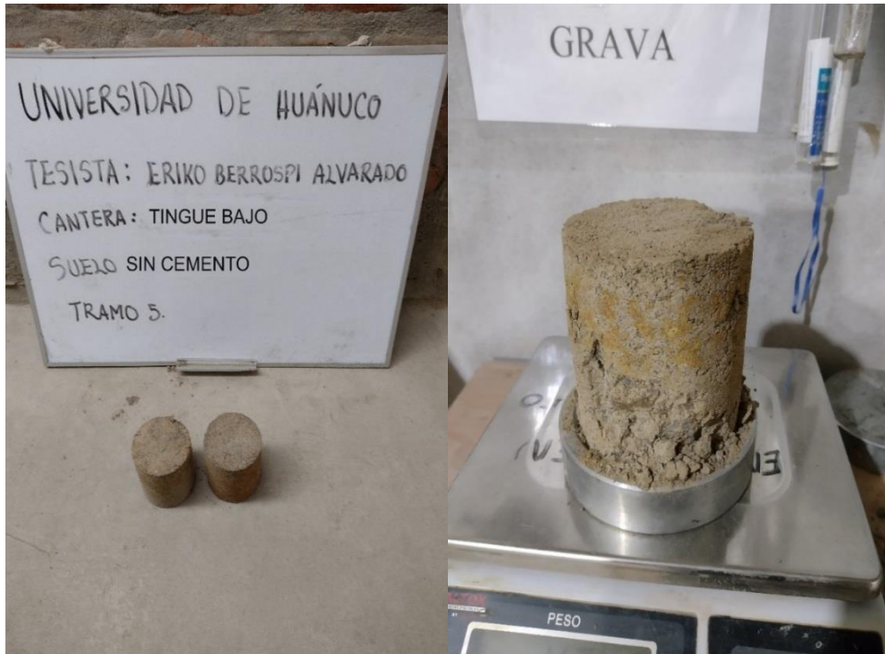
Fotografía 29 Probetas sin cemento
