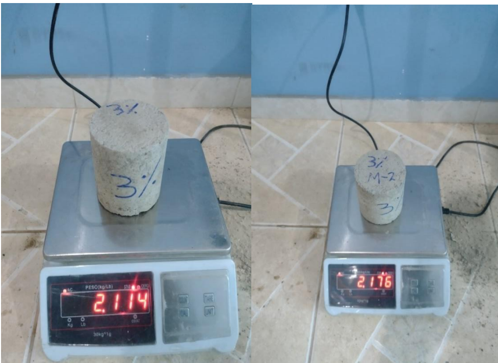
Fotografía 56 Peso seco probeta 3% cemento
