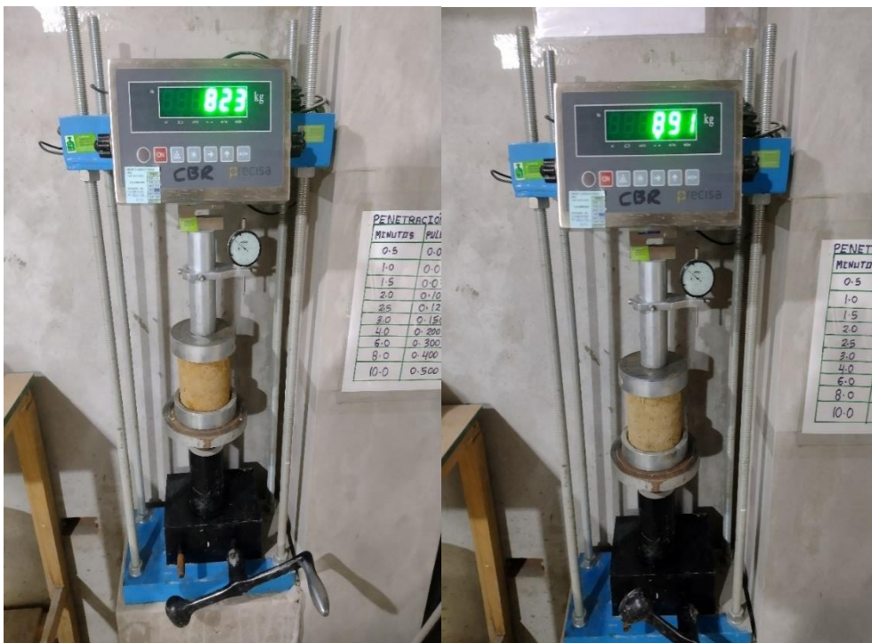
Fotografía 48 Rotura de probetas sin cemento
