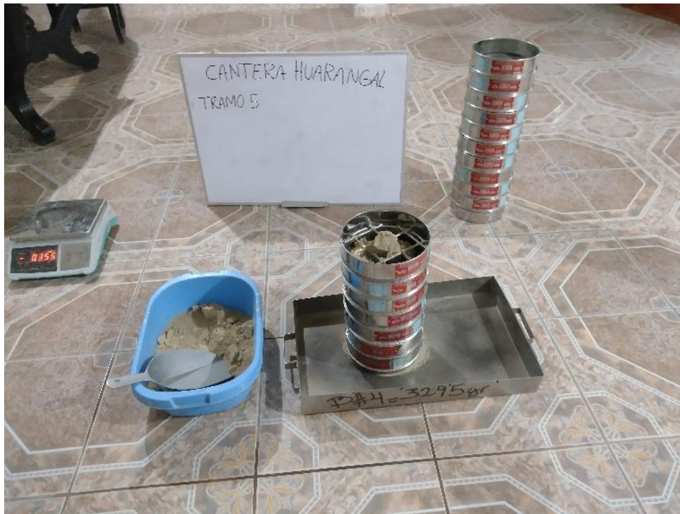
Fotografía 35 Tamizado del agregado grueso
