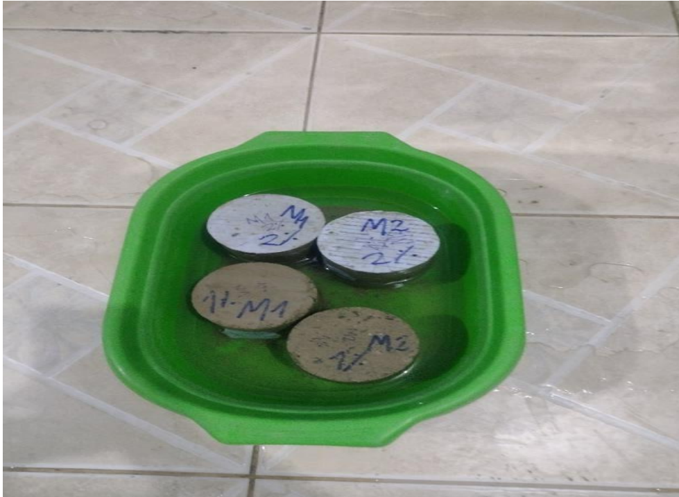
Fotografía 61 Saturación en agua de las probetas
