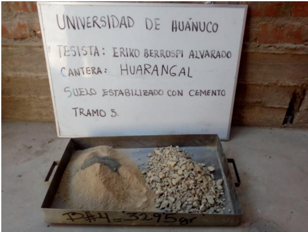
Fotografía 37 Material con cemento para Proctor
