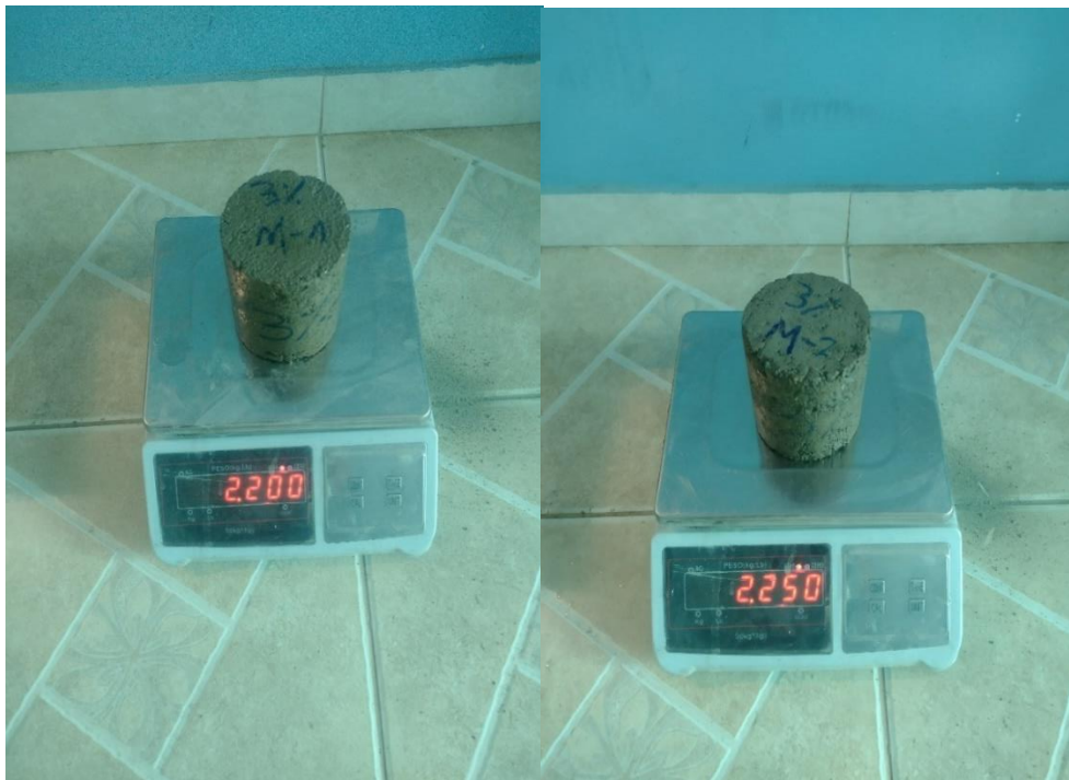
Fotografía 55 Peso húmedo probeta 3% cemento
