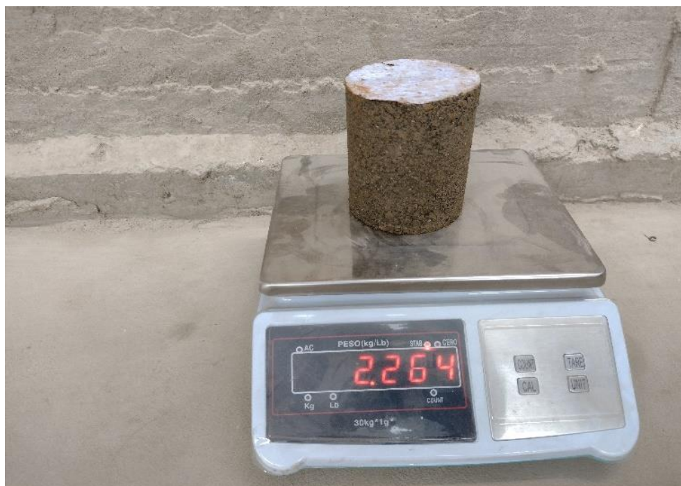
Fotografía 50 Peso probeta húmeda
