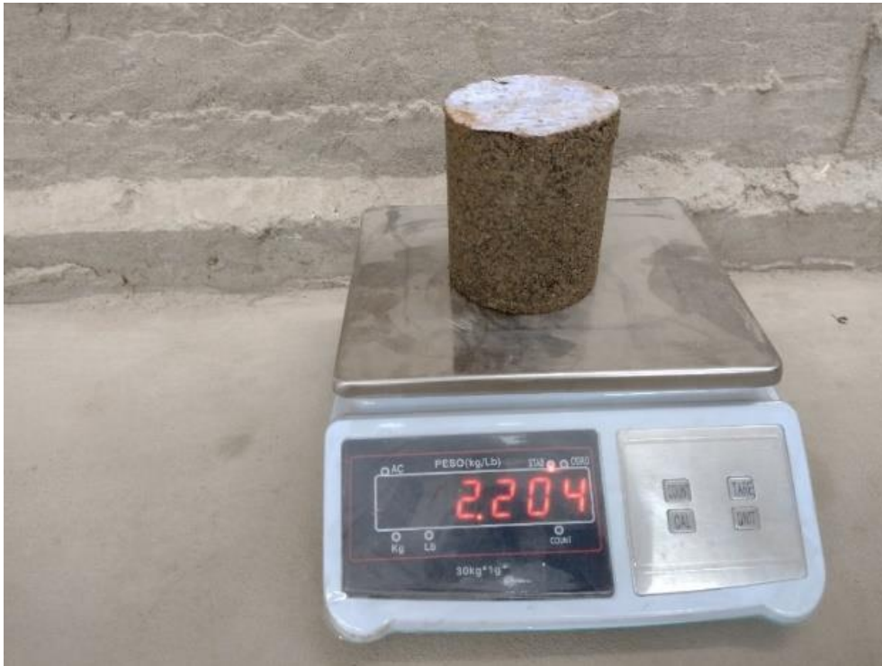
Fotografía 19 Peso de la probeta húmeda
