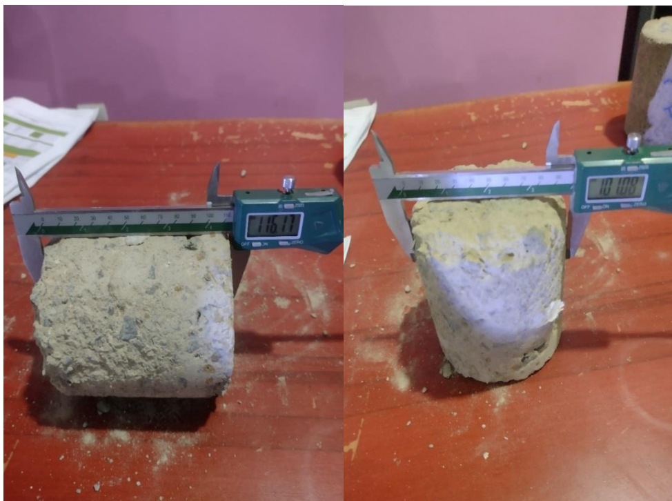
Fotografía 66 Medición de diámetro y la altura
