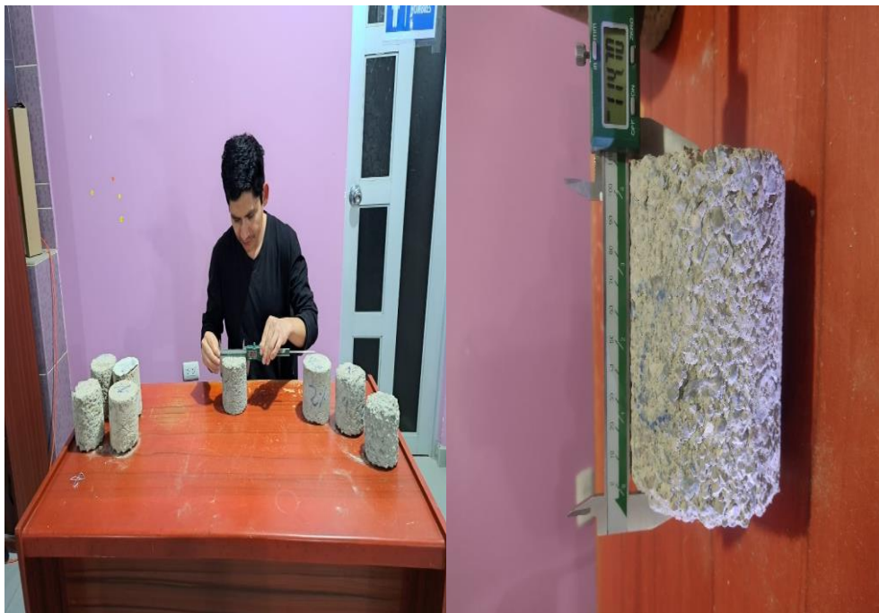
Fotografía 58 Medición del diámetro y la altura
