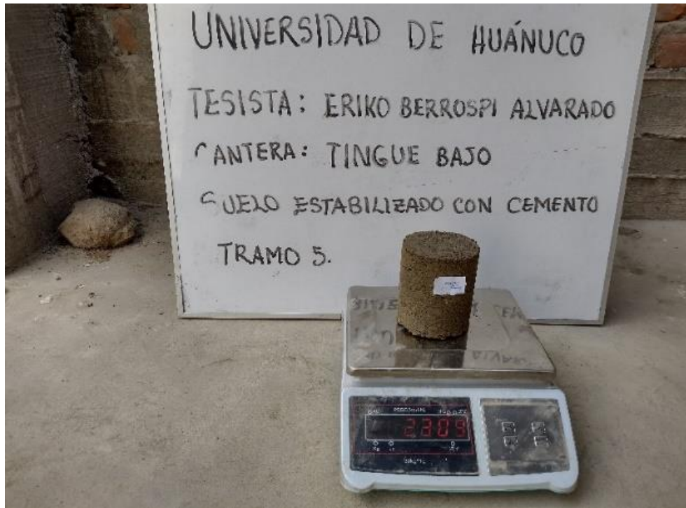
Fotografía 49 Peso probeta húmeda
