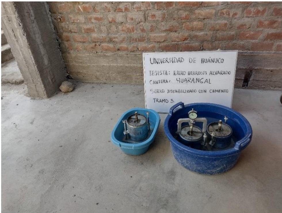
Fotografía 39 Saturación en agua de los moldes de CBR
