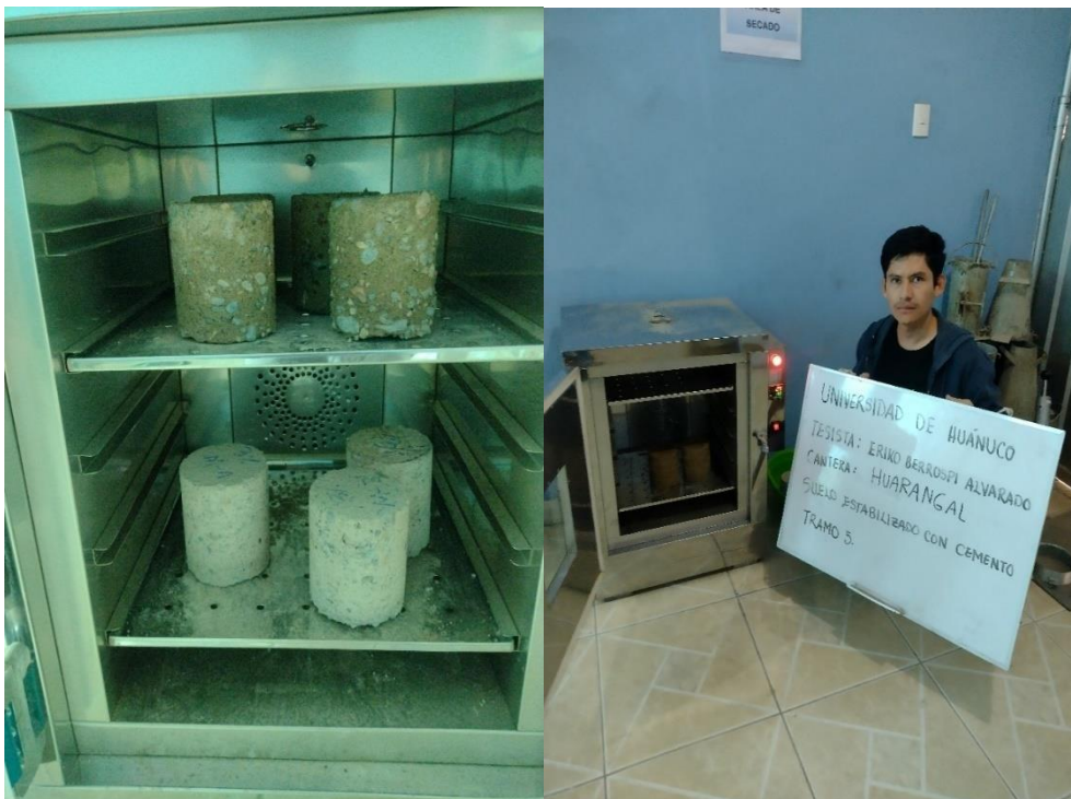
Fotografía 62 Secado en el horno de las probetas
