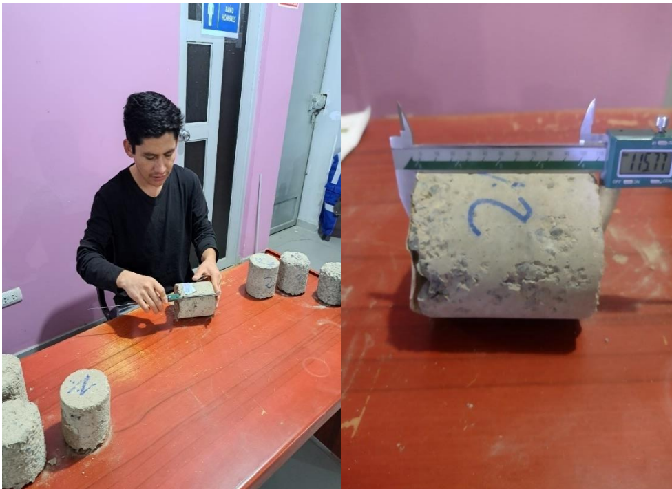
Fotografía 64 Medición de la altura
