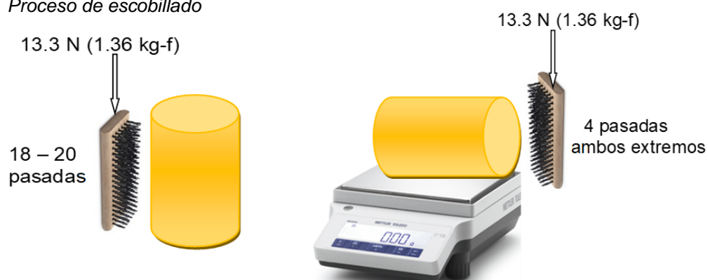
Figura 16 Proceso de escobillado
