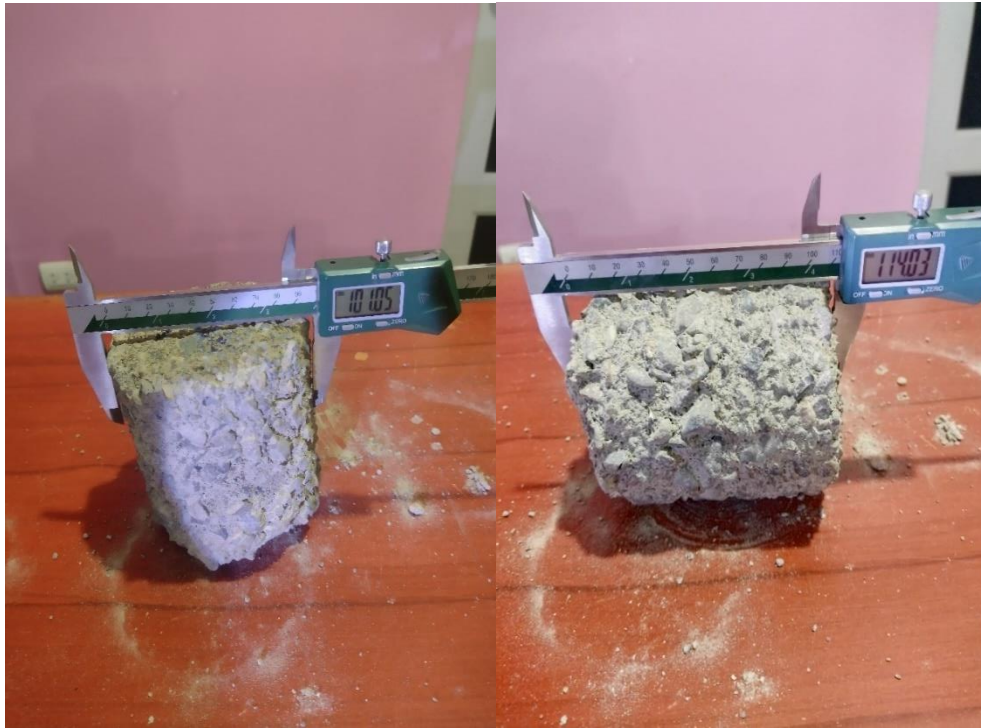
Fotografía 59 Medición de diámetro y la altura
