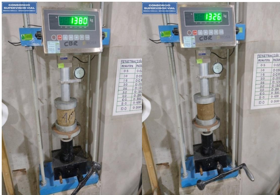
Fotografía 45 Rotura de probetas 1% cemento
