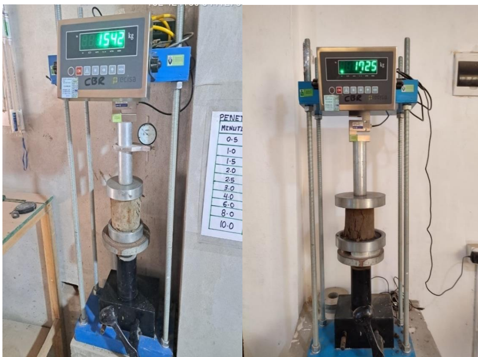
Fotografía 26 Rotura de probeta 2% cemento
