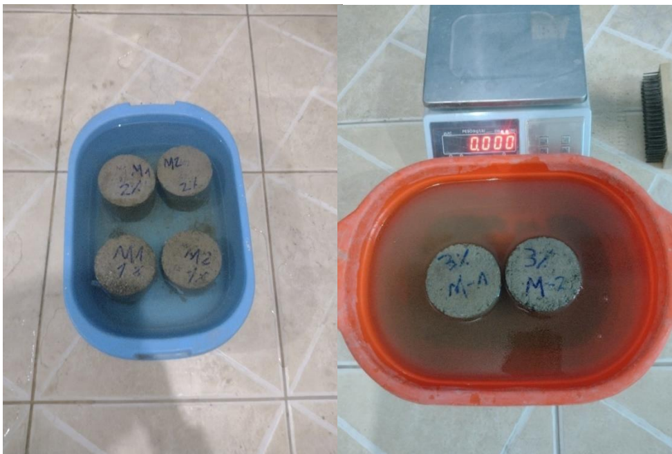
Fotografía 52 Saturación en agua de las Probetas de suelo-cemento
