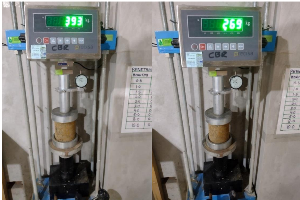
Fotografía 30 Rotura de probeta sin cemento
