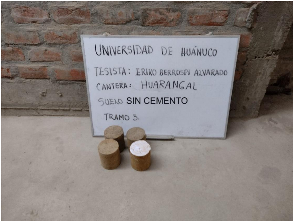
Fotografía 47 Probetas sin cemento
