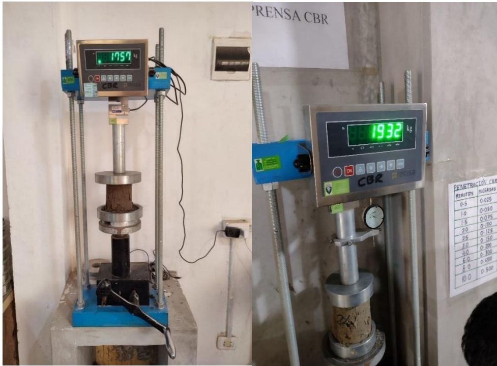
Fotografía 27 Rotura de probeta 2% cemento
