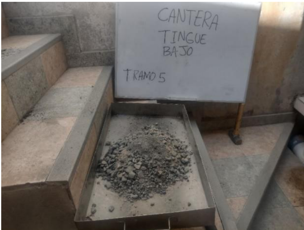
Fotografía 6 Suelo mezclado con cemento
