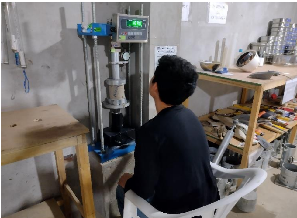
Fotografía 44 Rotura de probeta suelo-cemento en prensa CBR
