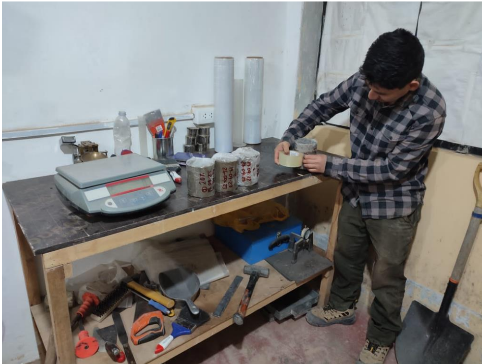
Fotografía 21 Curado de probeta suelo-cemento
