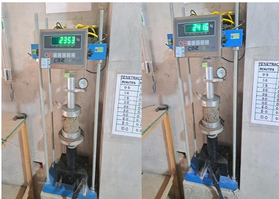
Fotografía 28 Rotura de probeta 3% cemento
