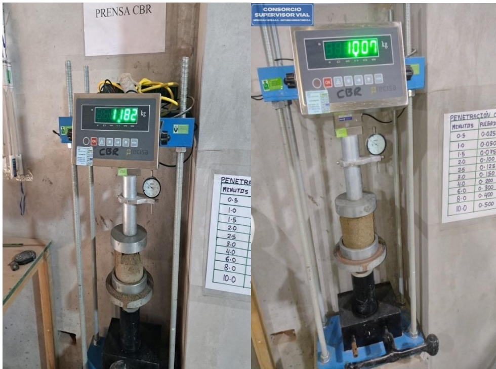
Fotografía 25 Rotura de probeta 1% cemento
