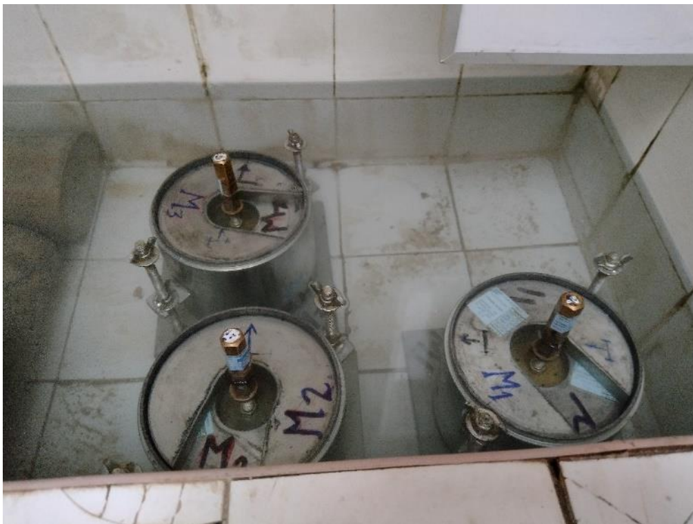
Fotografía 12 Saturación del molde en agua
