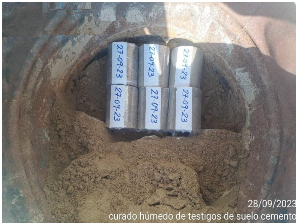
Fotografía 70 Curado en arena húmeda
