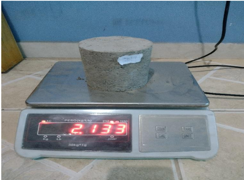
Fotografía 51 Peso probeta seca
