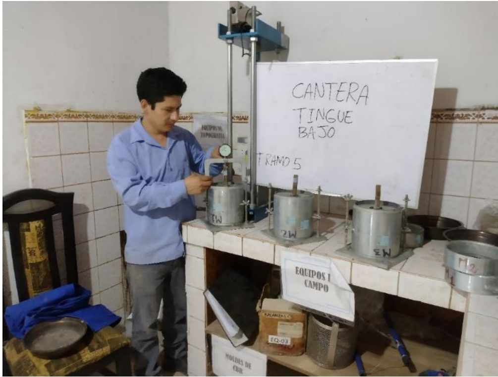
Fotografía 11 Colocación del dial analógico
