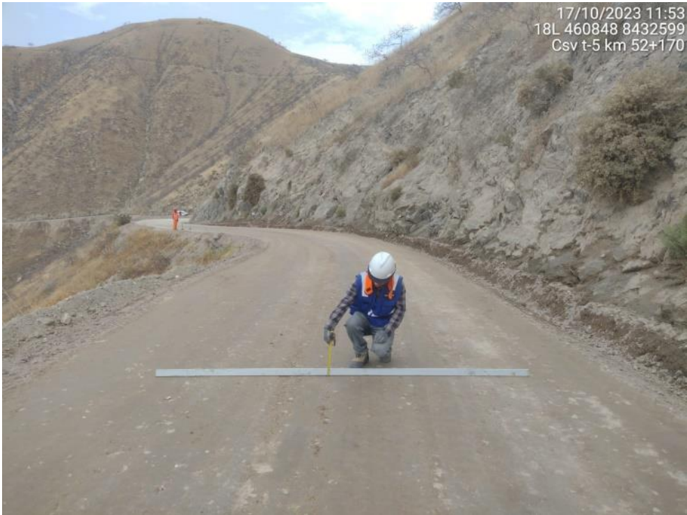
Fotografía 71 Lisura en sección transversal
