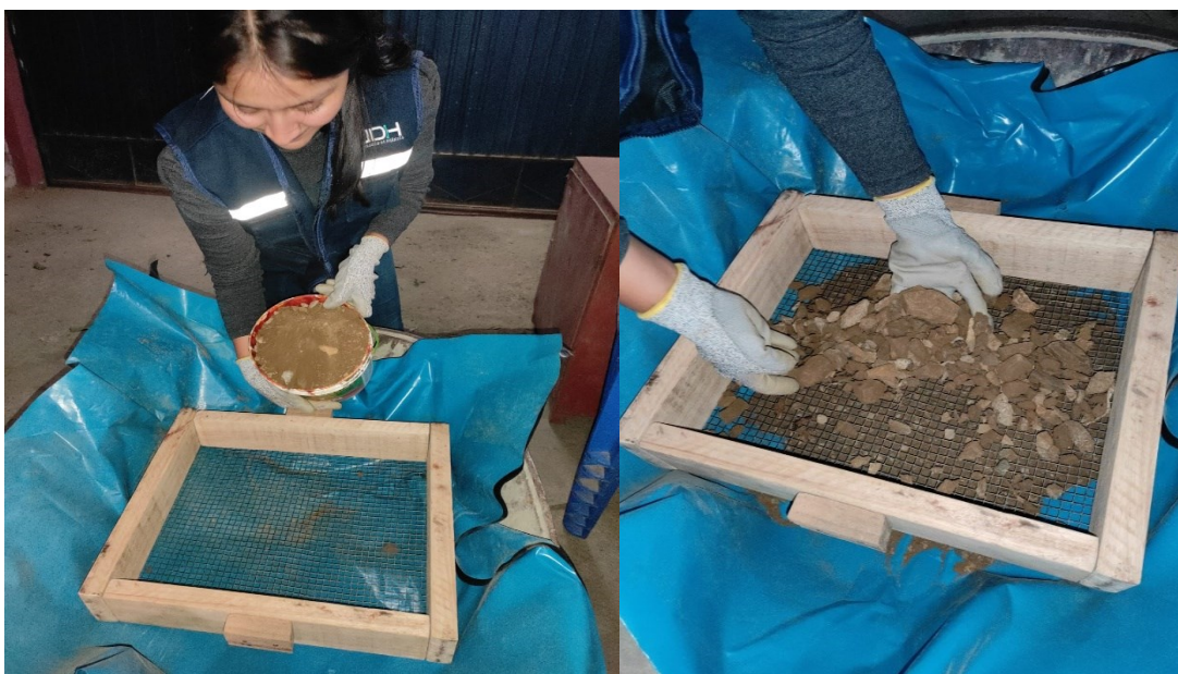
Tamizado de muestra de suelo para separar restos de residuos sólidos.
