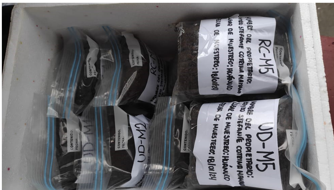
Rotulación y refrigeración de muestras finales para traslado al laboratorio.
