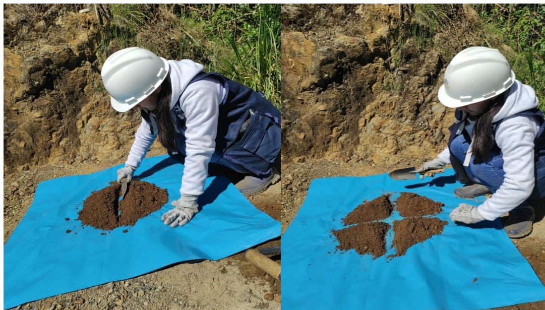
Método de partición para la obtención de muestra de suelo.
