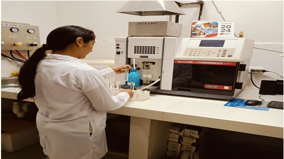
Análisis de metales pesados con el espectrofotómetro de absorción atómica
