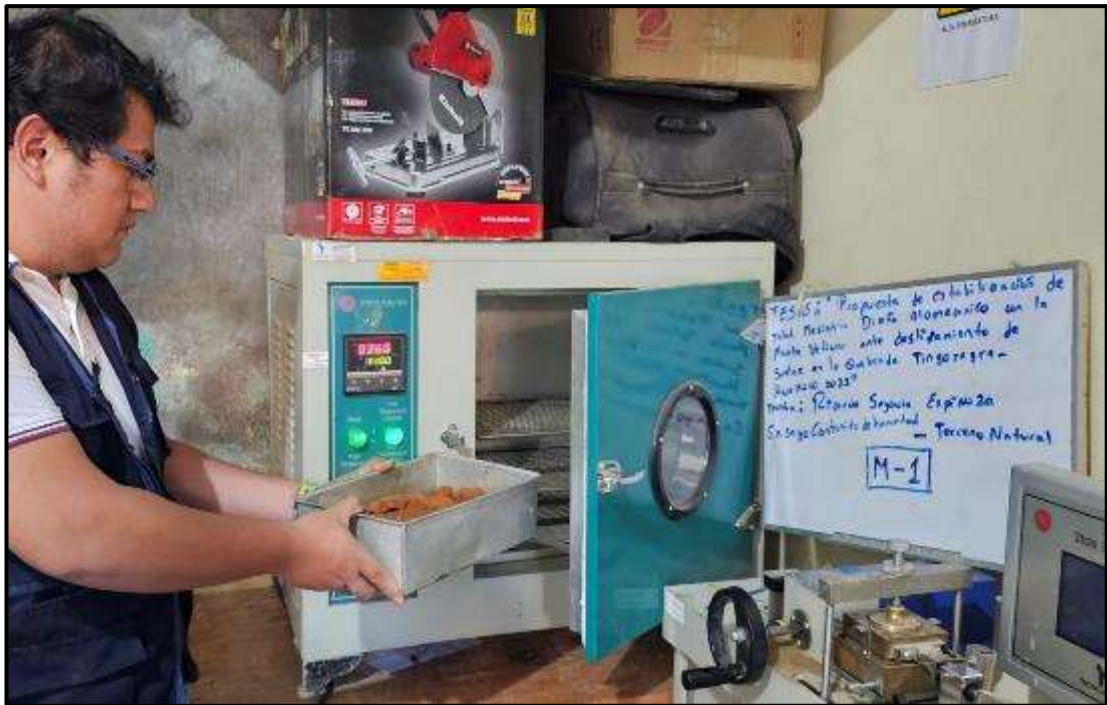
Las muestras 1 y 2 entrando al horno para el secado respectivo
