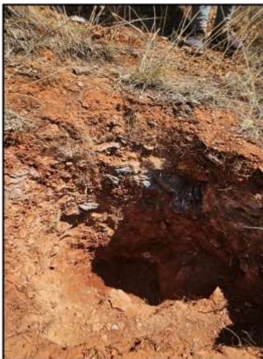
Conclusión de calicata 01 y muestreo del perfil estratigráfico
