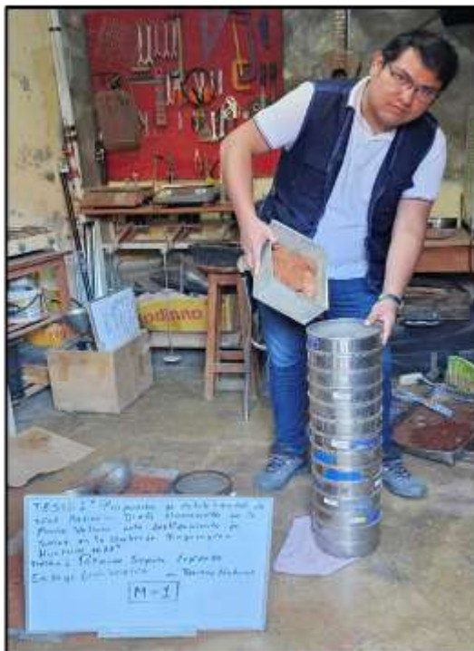
Análisis granulométrico por tamizado de las muestras 1 y 2
