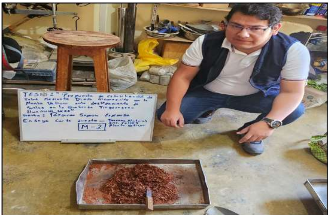
Se le añade agua a la muestra con raíces que pasa de la malla N° 4 para el ensayo de Corte Directo
