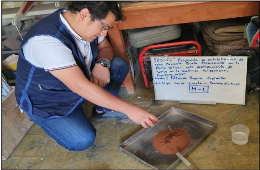
Se le añade agua a la muestra sin raíces que pasa de la malla N° 4 para el ensayo de Corte Directo
