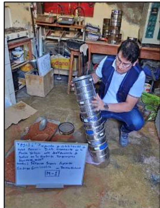
Análisis granulométrico por tamizado de las muestras 1 y 2
