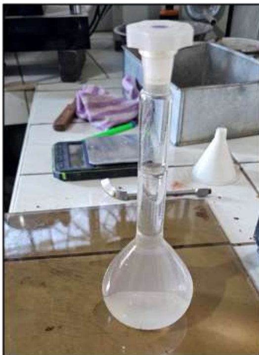
Picnómetro y las muestras para su respectivo ensayo de peso específico
