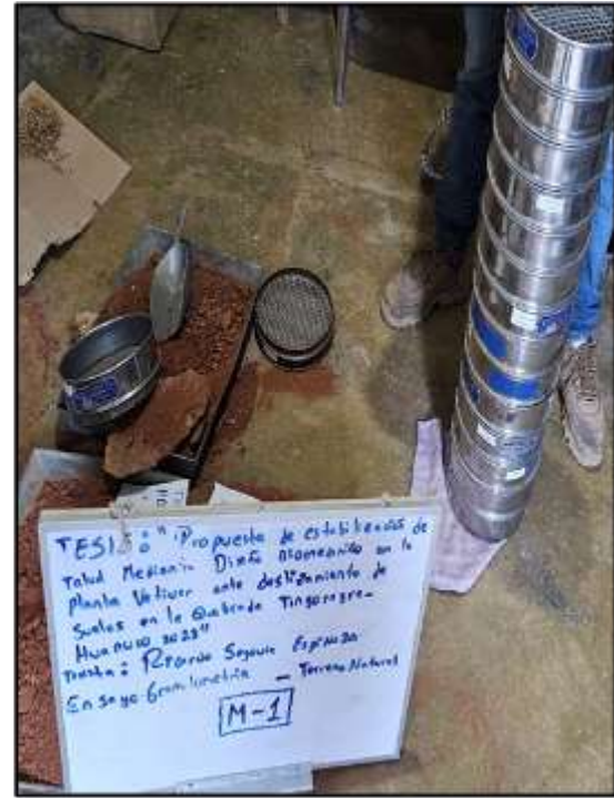
Equipo de granulometría por tamizado de las muestras
