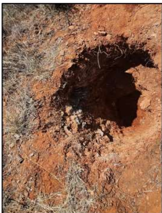
Conclusión de calicata 01 y muestreo del perfil estratigráfico
