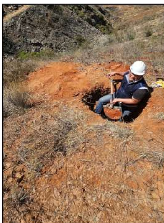
Excavación y Perfilado de calicata 01
