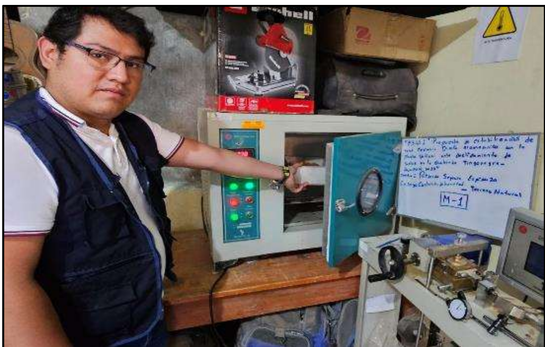
Esta muestra en el horno nos ayudará a obtener el contenido de humedad
