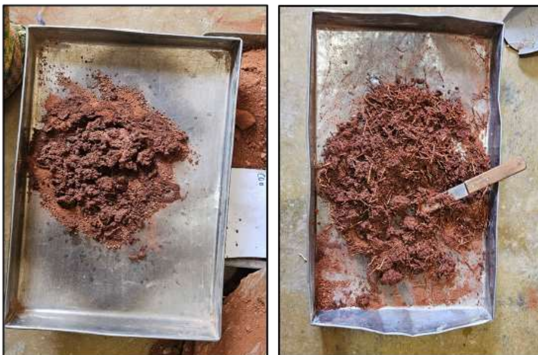
Humedecimiento de las muestras el ensayo de Corte Directo
