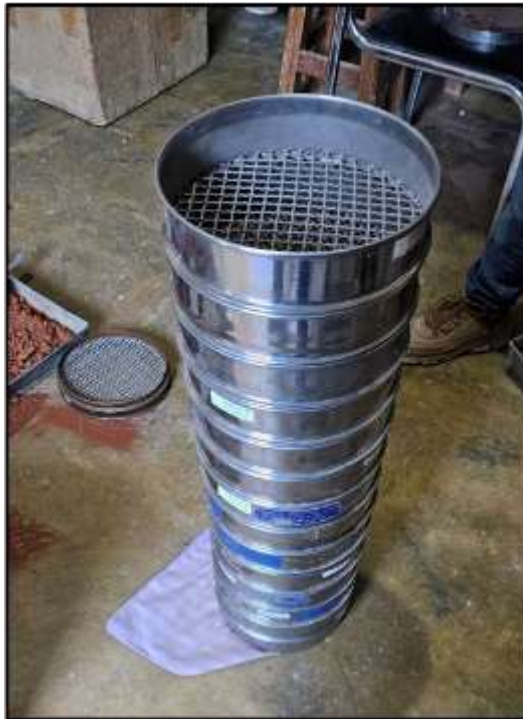
Equipo de granulometría por tamizado de las muestras
