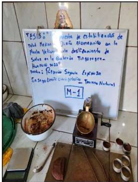
Muestras 1 y 2 estiradas y amasadas de 10 cm
