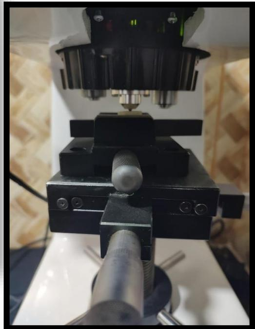
Microdurómetro para la evaluación Inicial de la Microdureza Superficial
