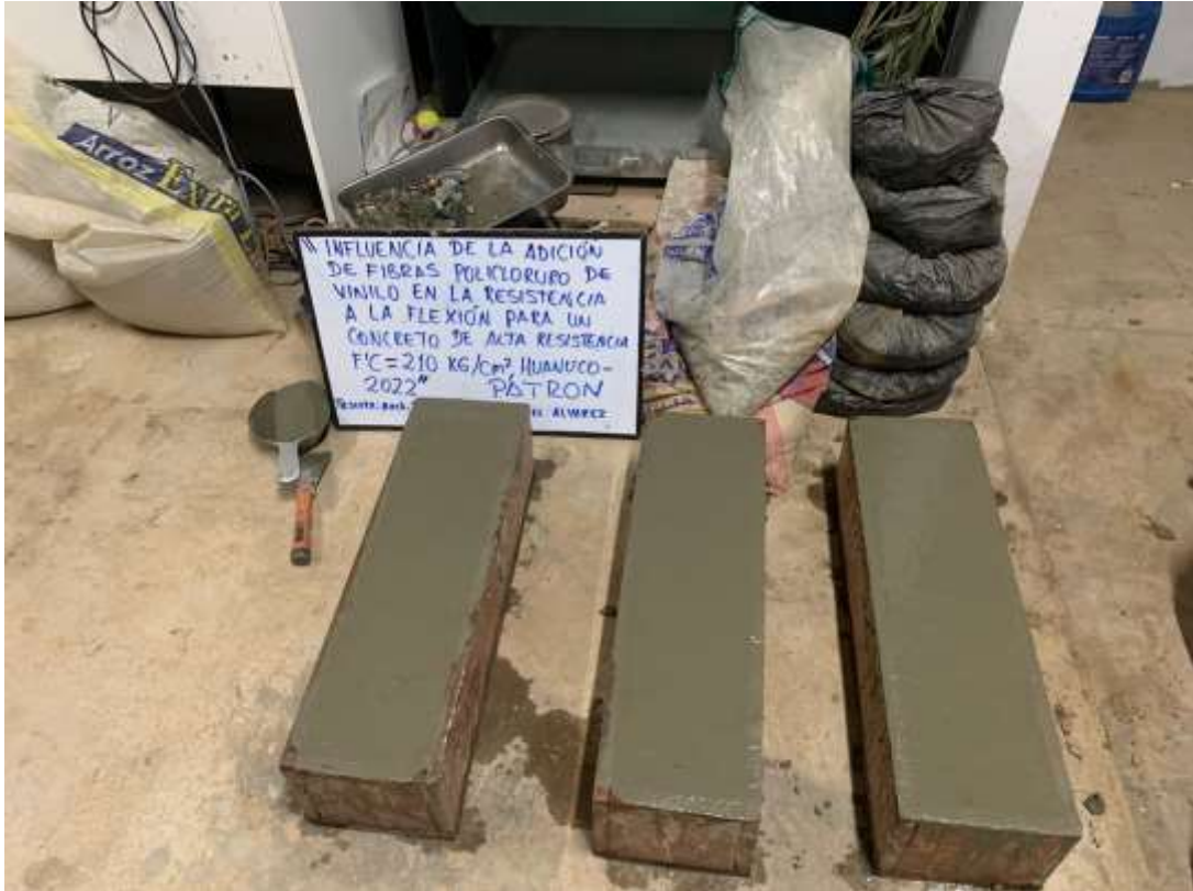
Muestra del concreto patrón de sección de 15cmx 15cm y de luz de 50cm, con el espécimen de concreto de f'c = 210 \text{ kg/cm}^2 de alta resistencia, según NTP.339.078
