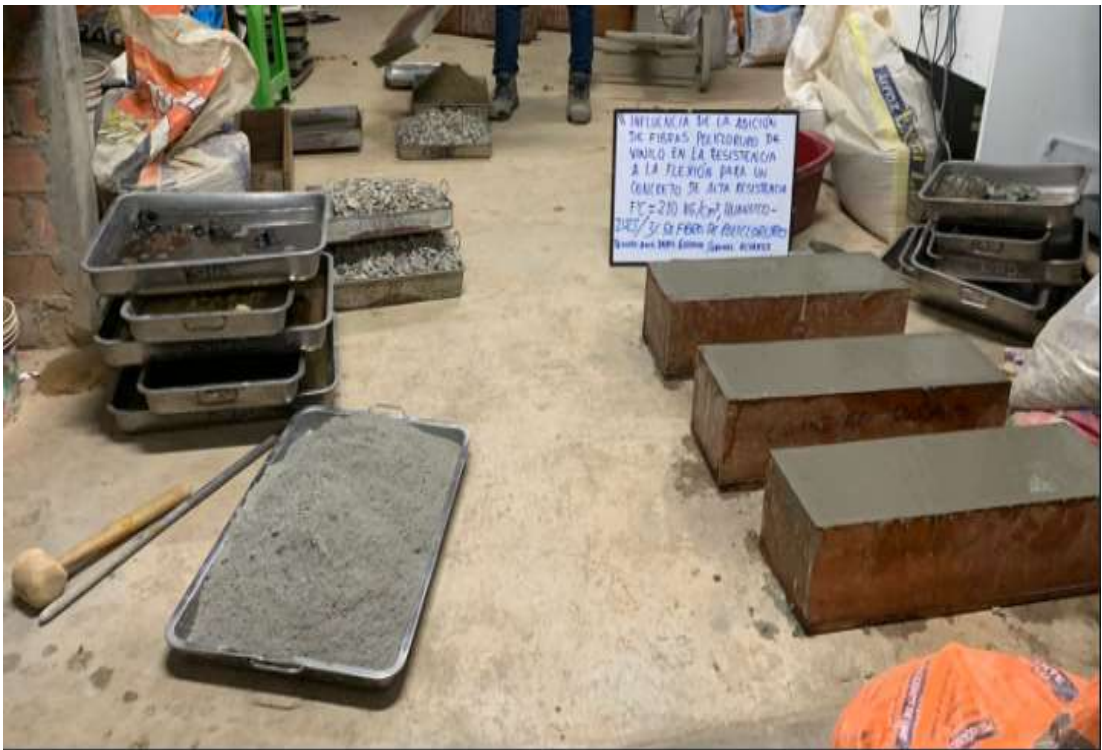
Se muestra el espécimen de concreto de f'c = 210 \text{ kg/cm}^2 de alta resistencia con la adición del 0.7% de policloruro de vinilo, para que luego sean probados en la máquina de compresión haciendo un ensayo a la flexión.
