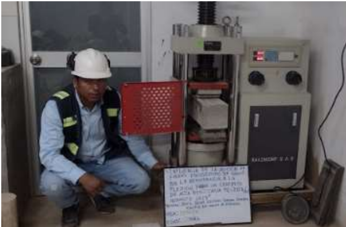
Muestra del concreto patrón, con el espécimen de concreto de f'c = 210 \text{ kg/cm}^2 de alta resistencia con la adición del 0,3% de policloruro de vinilo con una edad de 28 días
