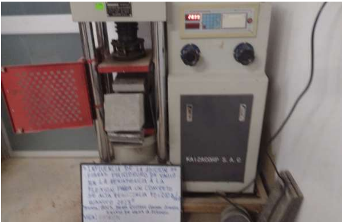
Muestra del concreto patrón, con el espécimen de concreto de f'c = 210 \text{ kg/cm}^2 de alta resistencia con la adición del 0,5% de policloruro de vinilo con una edad de 28 días.
