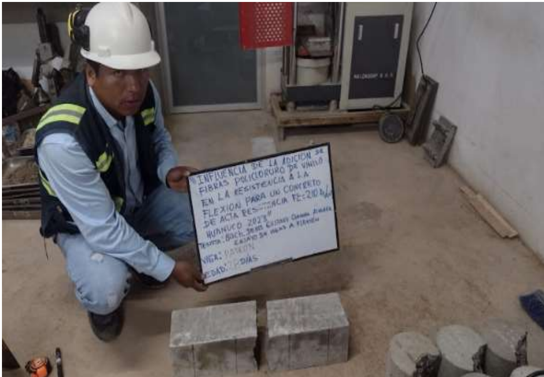
La muestra de concreto patrón, con espécimen de concreto de f'c = 210 \text{ kg/cm}^2 de alta resistencia con la adición del 0.7% de policloruro de vinilo con una edad de 28 días, se procedió a medir la resistencia.
