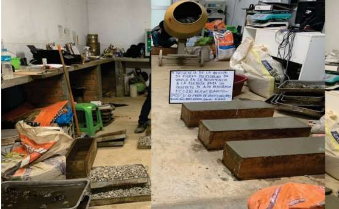
Se muestra el espécimen de concreto de f'c = 210 \text{ kg/cm}^2 de alta resistencia con la adición del 0.5% de policloruro de vinilo, para que luego sean probados en la máquina de compresión haciendo en ensayo a la flexión.
