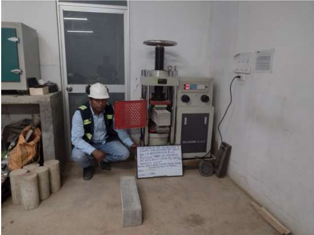
Muestra del concreto patrón, espécimen de concreto de f'c = 210 \text{ kg/cm}^2 de alta resistencia con la adición del 0.7% de policloruro de vinilo con una edad de 28 días.
