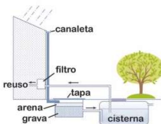
Figura 95 Recolección de aguas de lluvia
