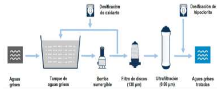
Figura 94 Sistema de recolección de aguas residuales
