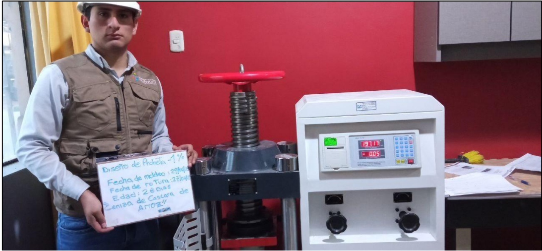
Rotura de probeta a los 28 días con 1% de ceniza de cáscara de arroz
