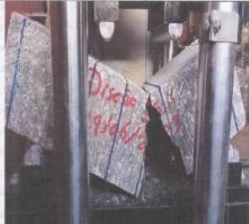
Fig. 2: Falla de la muestra 5.
