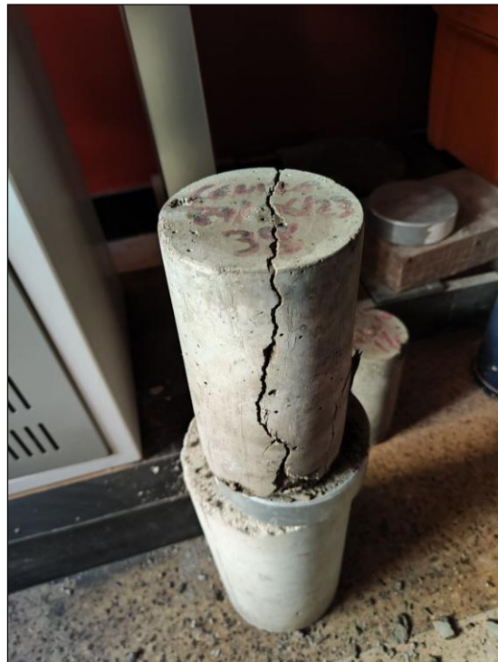
Rotura de probeta a los 14 días con 3% de ceniza de cáscara de arroz
