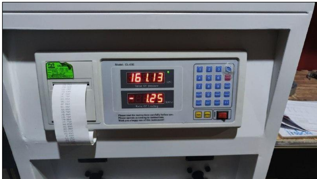
Rotura de probeta a los 7 días con 5% de ceniza de cáscara de arroz
