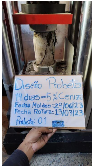
Rotura de probeta a los 14 días con 5% de ceniza de cáscara de arroz
