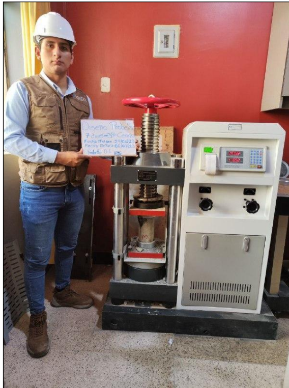
Rotura de probeta a los 7 días con 3% de ceniza de cáscara de arroz
