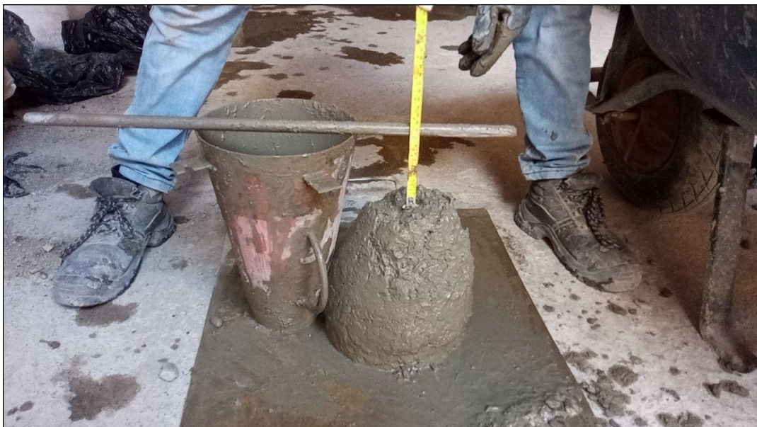
SE OBSERVA EL ENSAYO DE CONO DE ABRAMS PARA DETERMINAR LA CONSISTENCIA.
