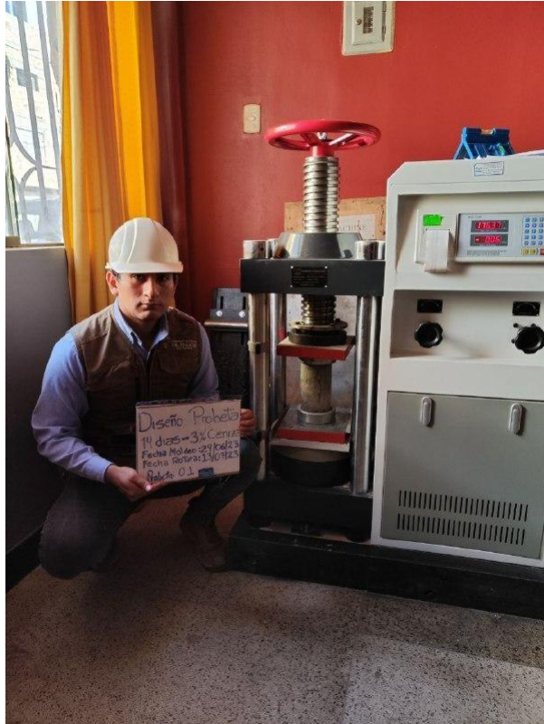
Rotura de probeta a los 14 días con 3% de ceniza de cáscara de arroz
