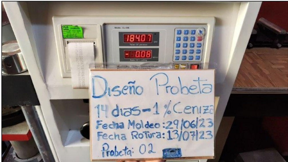
Rotura de probeta a los 14 días con 1% de ceniza de cáscara de arroz
