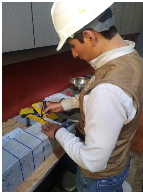
Se observa al tesista a lado del bloque marcando para el ensayo a la flexión
