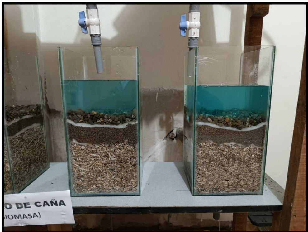
Proceso de filtración azul metileno
