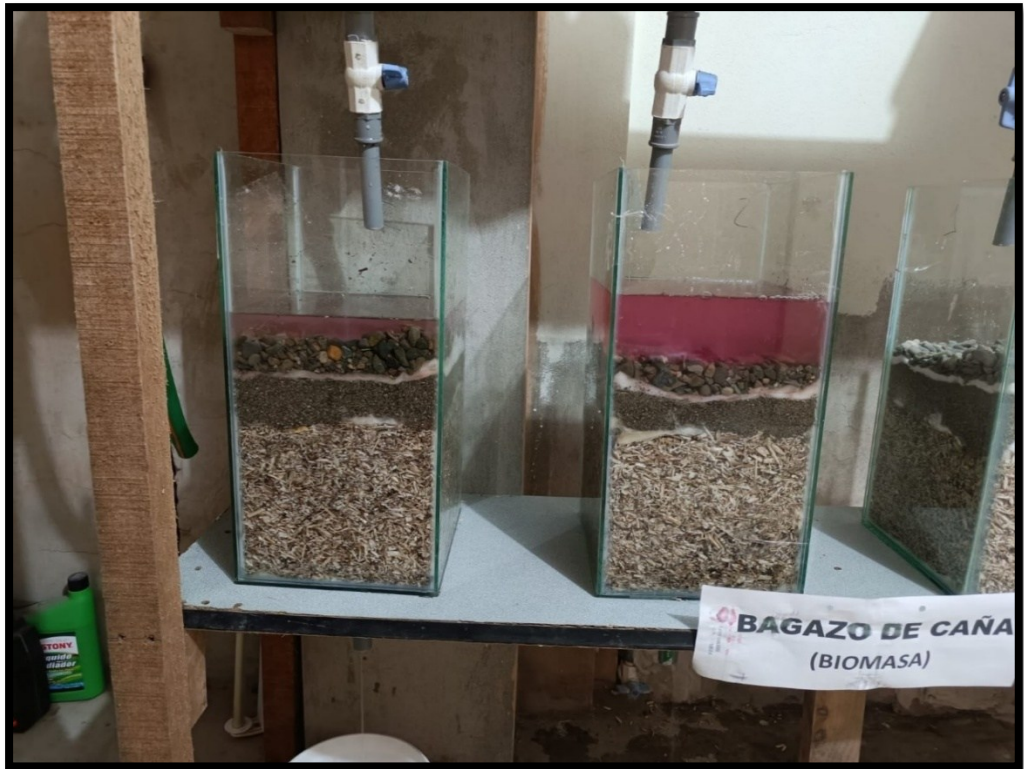
Proceso de filtración de la eosina
