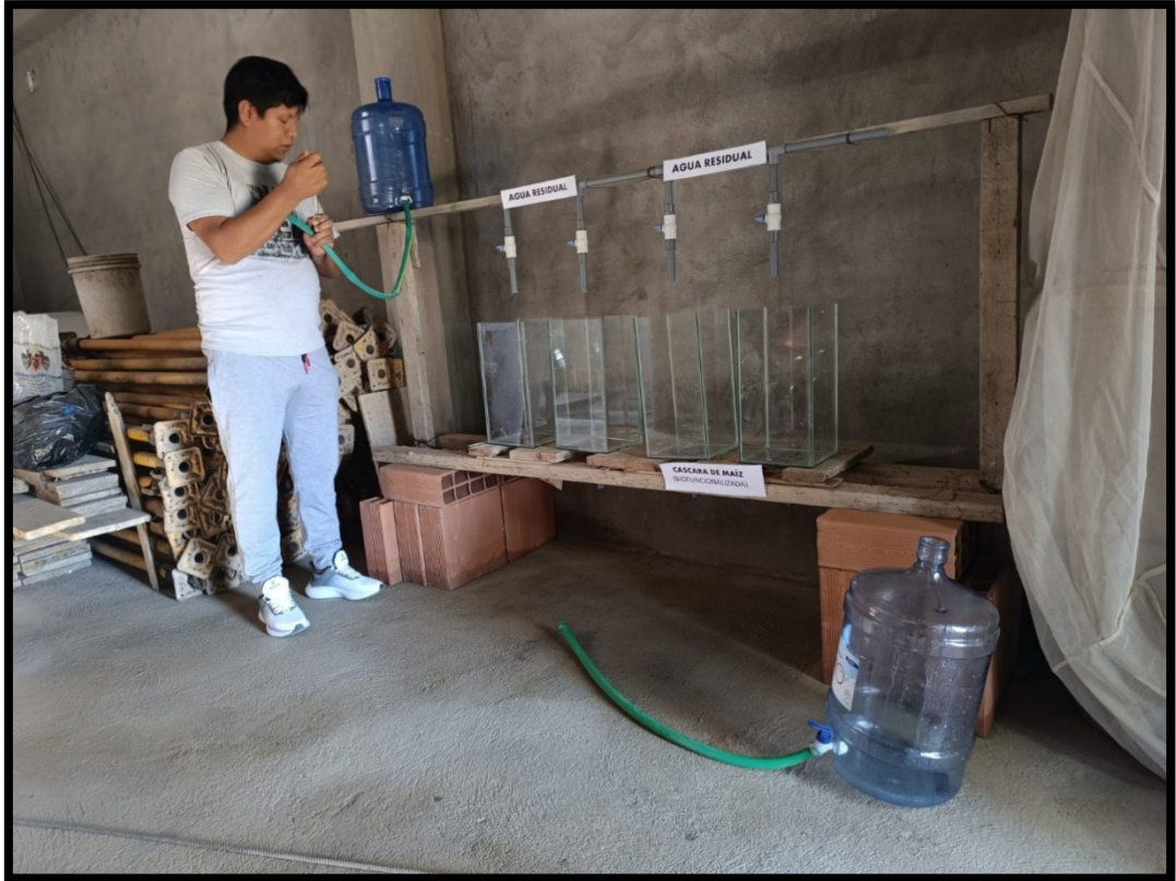
Armado sistema de filtración
