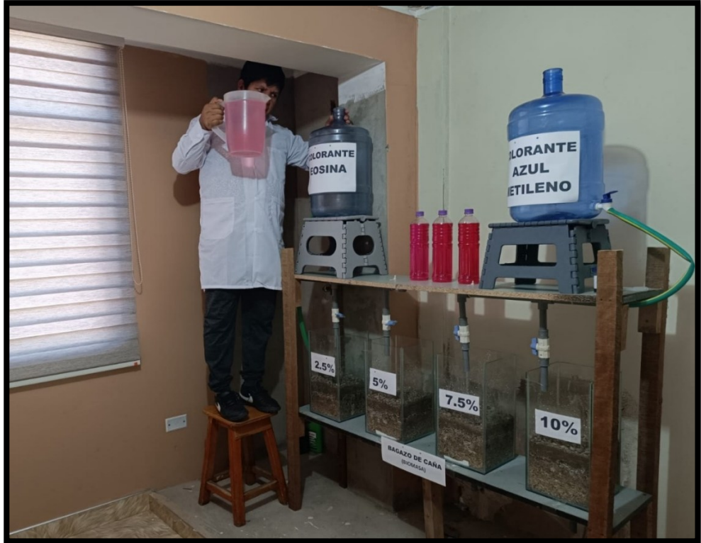
Filtración de eosina
