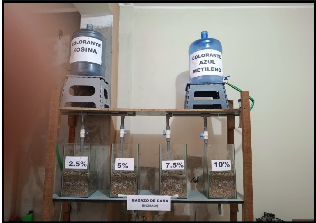
Armado del sistema de filtración
