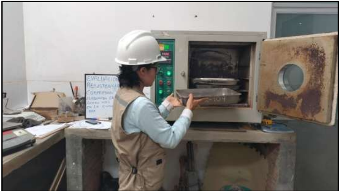
Figura 17 Proceso de secado de agregados
