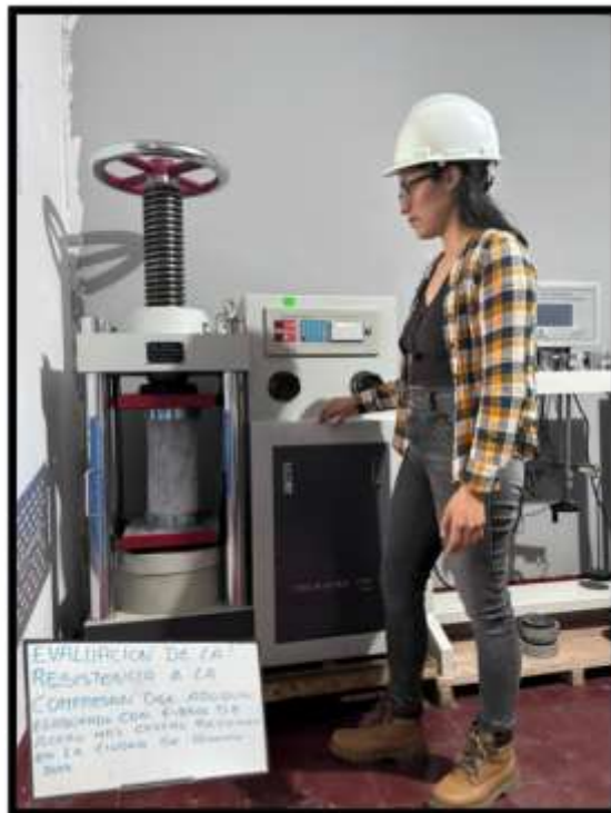
Figura 29 Ruptura de probetas a los 28 días
