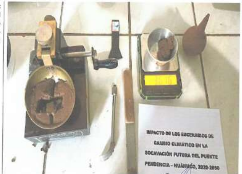
FOTOGRAFÍA N° 10: vista fotográfica del procedimiento de ensayo para la determinación de límites de consistencia del suelo.
