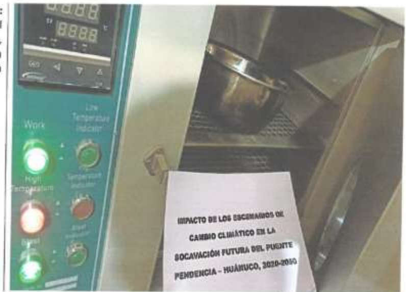
FOTOGRAFÍA N° 08: vista fotográfica del procedimiento de ensayo, secado de muestra en horno a temperatura constante.
