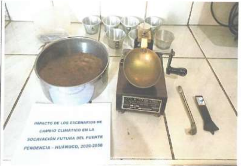
FOTOGRAFÍA N° 09: vista fotográfica del procedimiento de ensayo, preparación de muestra para la determinación de límites de consistencia del suelo.
