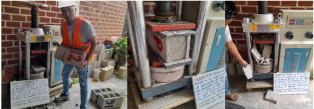
Aplicación de la carga sobre el bloque de concreto
