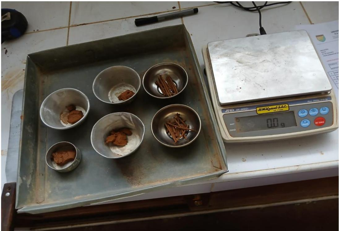
Se aprecia las muestras del límite líquido y el límite plásticos posteriormente sacado del horno.
