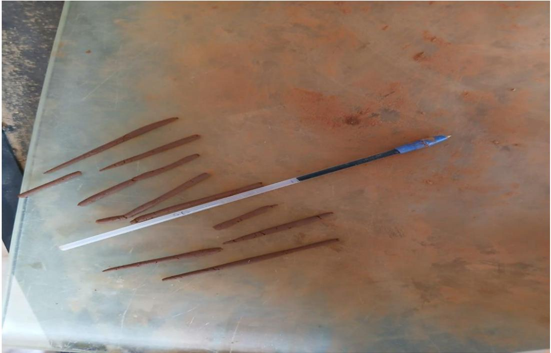
Se aprecia el rollo de 3.2 mm realizado del material preparado para el límite líquido en lo cual se tomó una muestra aproximada de 20 gr, para realizar el límite plástico.
