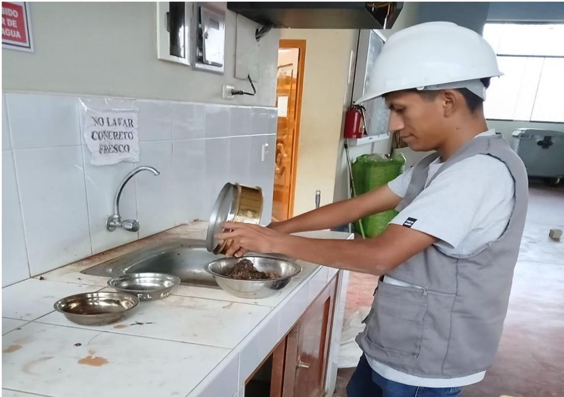
Se aprecia el lavado de la muestra.
