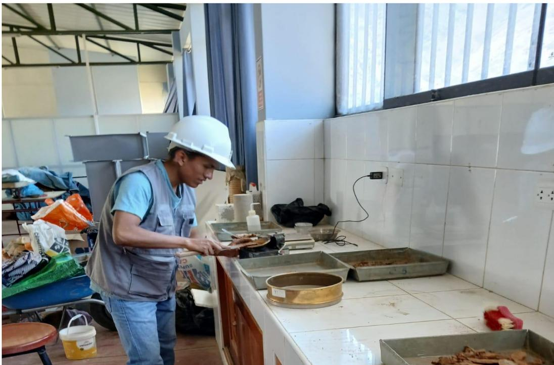
Se aprecia la colocación de una pequeña muestra de masa húmeda en la parte central de la copa casa grande.
