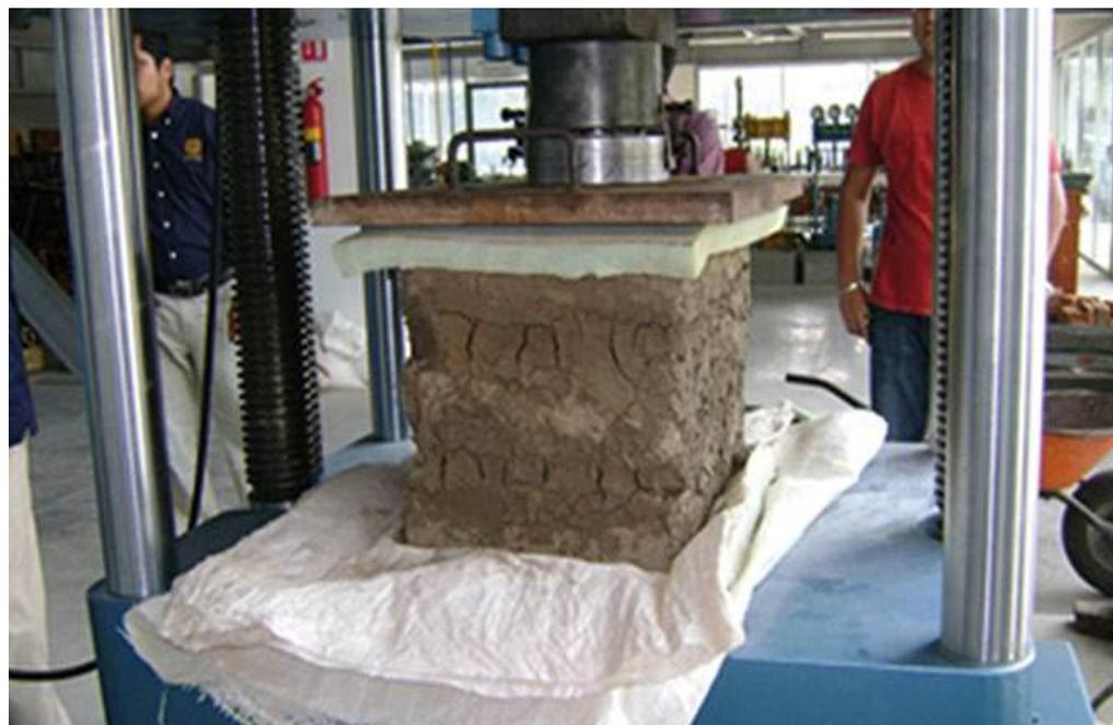
Nota. Ensayo de resistencia a la compresión del adobe. Fuente: (Ruiz y Vidal, 2015).
