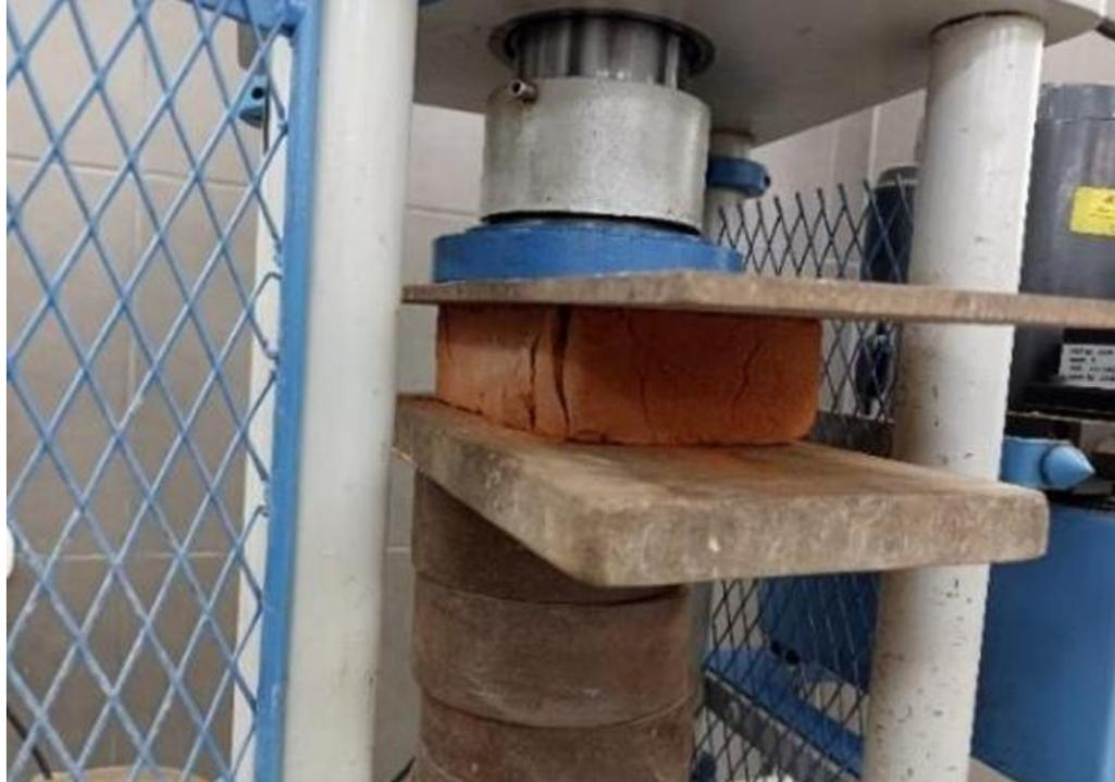
*Nota.* Ensayo de resistencia bajo carga axial de ladrillos artesanales. Fuente: (Ludeña Bazan, 2023).
